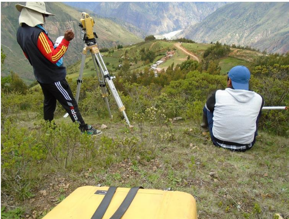
Figura 10 Levantamiento topográfico línea de conducción Ayaorcco
