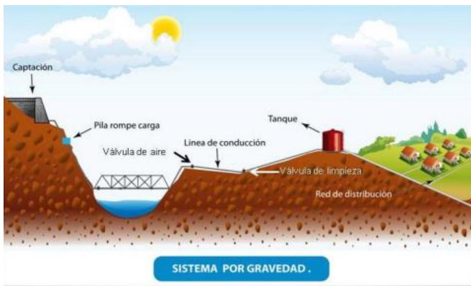
Figura 03: Esquema de sistema de agua por gravedad
