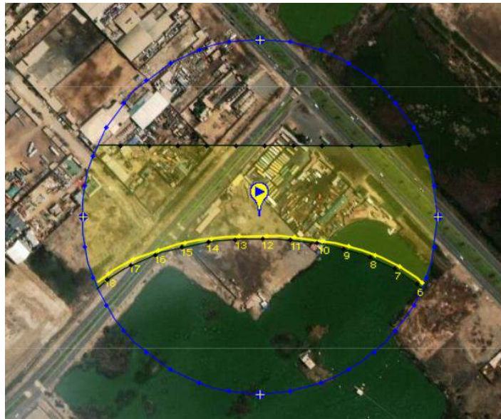
Figura 79 Orientación Solar del terreno de estudio
