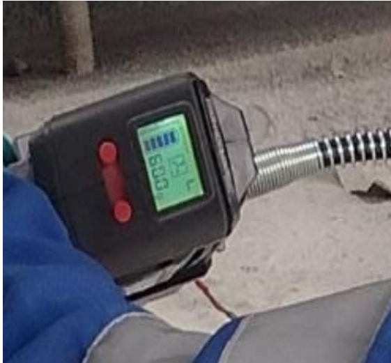
Lubricación ME lado acople con 60gr de grasa con contador
