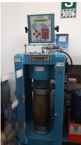
FIGURA 6. ensayo a compresión a los 7 días del concreto normal. FUENTE: PROPIA
