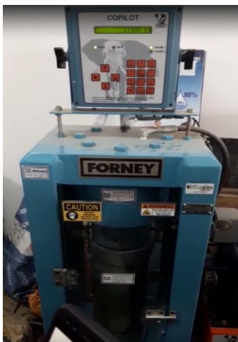
FIGURA 7. ensayo a compresión a los 7 días del concreto pigmentado. FUENTE: PROPIA
