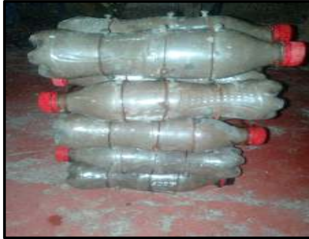
Figura N° 18: Unidades que conforman una pila.
