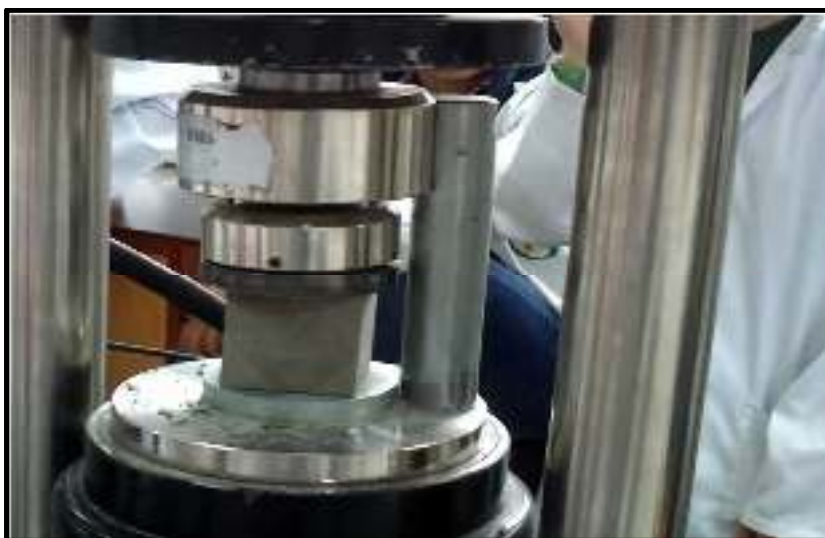
Figura N° 10: Muestra de mortero sometido cargas de compresión.
