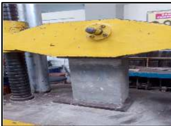
Figura N° 8: Ensayo a compresión de pilas.
