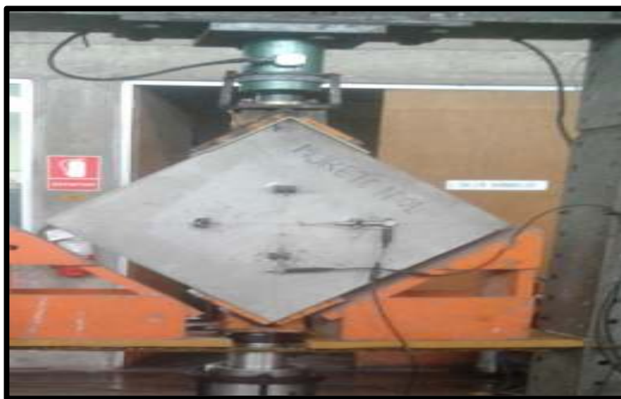
Figura N° 11: Muestra de murete para ensayo de compresión diagonal.
