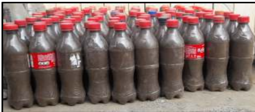
Figura N° 15: Unidades de albañilería tipo PET.
