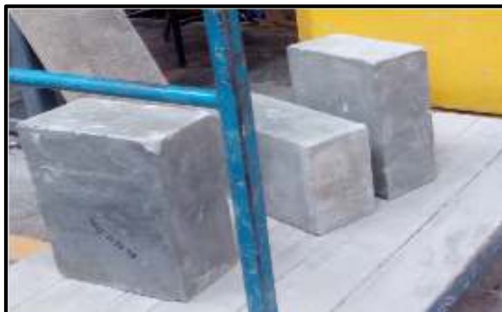
Figura N° 19: Pilas a 28 días de curado.
