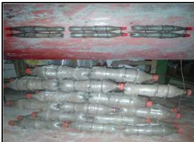
Figura N° 25: Unidades que conforman la primera hilada de murete.
