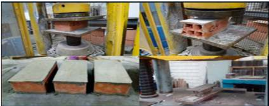
Figura N o 16: Ensayo de compresión en unidades de albañilería.
