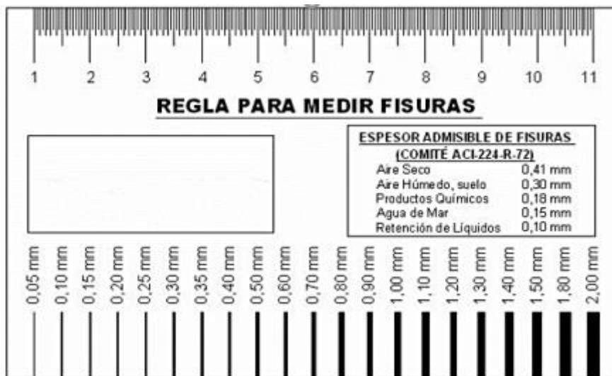
Figura 4 .Fisurómetro según medidas.
