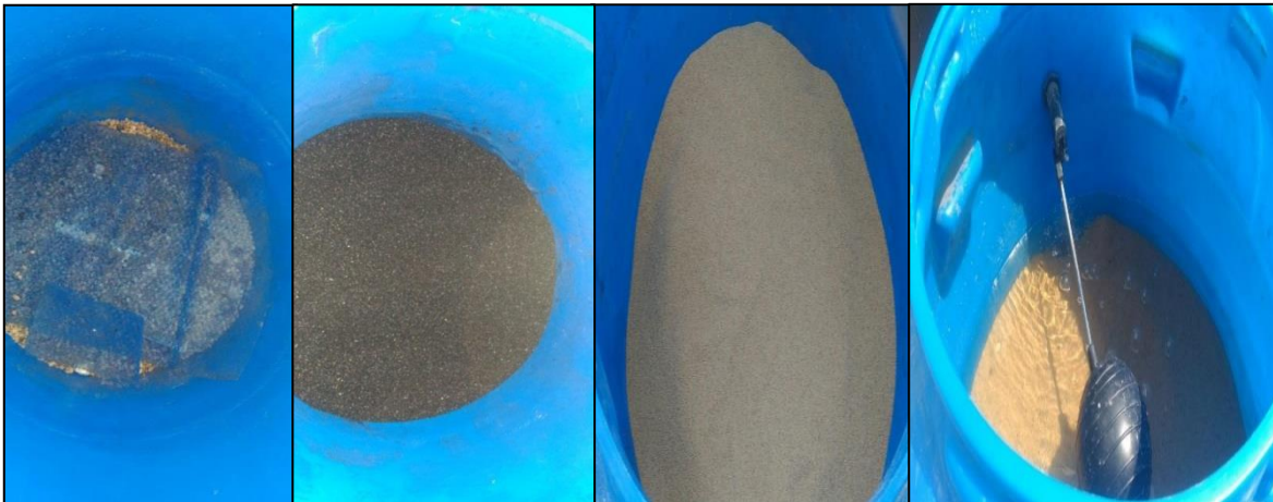
Figura 45: Capas del material que componen el filtro
