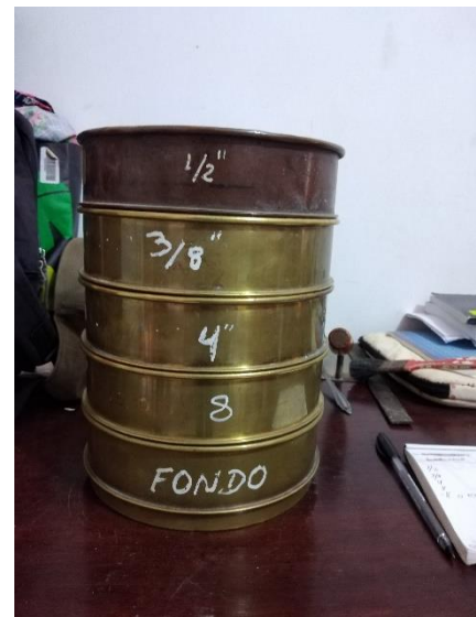
Tamices a emplear para el Agregado Grueso 1/2\", 3/8\", 4\", 8\", fondo.
