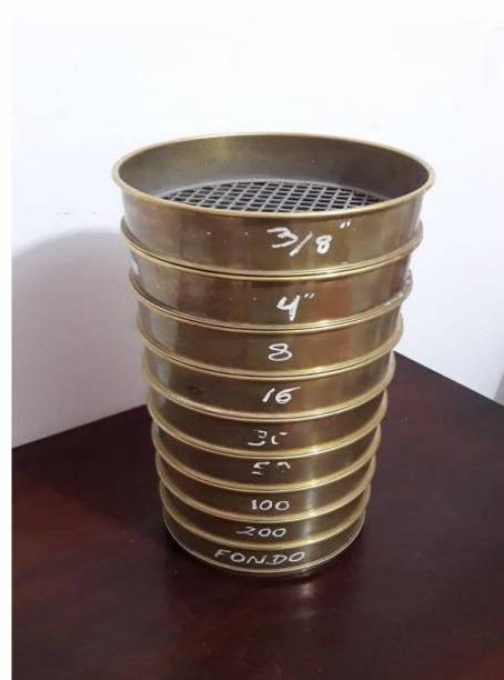
Tamices a emplear para el Agregado Fino 3/8\", 4\", 8\", 16\", 30\", 50\", 100\", 200\", fondo.
