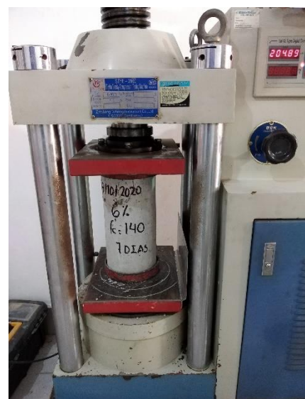
Rotura de probeta del concreto f'_c = 140 \text{ kg/cm}^2 con 6% de adición de plástico Pet a los 7 días
