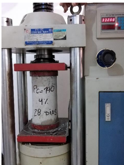
Rotura de probeta del concreto f'_c = 140 \text{ kg/cm}^2 con 4% de adición de plástico Pet a los 28 días
