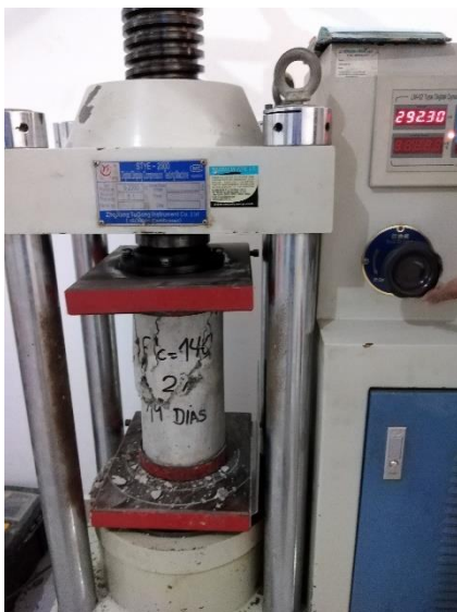
Rotura de probeta del concreto f'c = 140 kg/cm 2 con 2% de adición de plástico Pet a los 14 días
