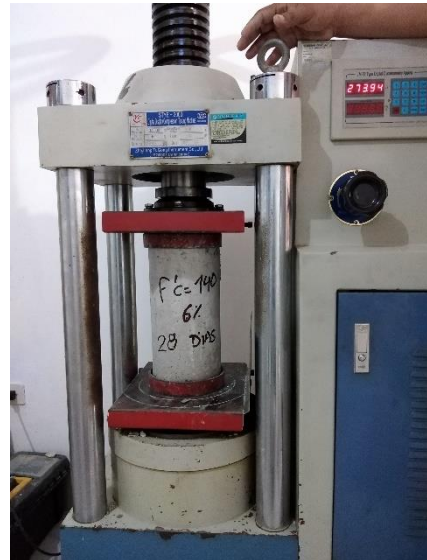
Rotura de probeta del concreto f'c = 140 \text{ kg/cm}^2 con 6% de adición de plástico Pet a los 28 días
