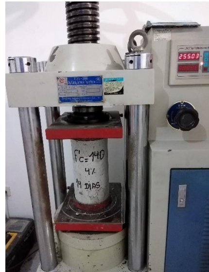
Rotura de probeta del concreto f'_c = 140 \text{ kg/cm}^2 con 4% de adición de plástico Pet a los 14 días
