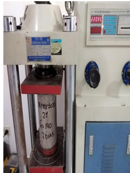
Rotura de probeta del concreto f'c = 140 kg/cm 2 con 2% de adición de plástico Pet a los 7 días
