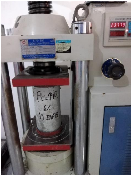
Rotura de probeta del concreto f'c = 140 \text{ kg/cm}^2 con 6% de adición de plástico Pet a los 14 días
