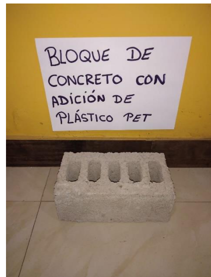
Producto final del bloque de concreto con adición de Plástico Pet, vista en planta
