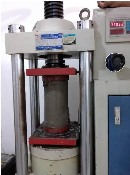
Rotura de probeta de concreto patrón f'c = 140 kg/cm 2 a los 28 días
