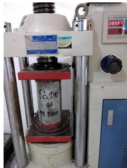
Rotura de probeta de concreto patrón f'c = 140 kg/cm 2 a los 14 días
