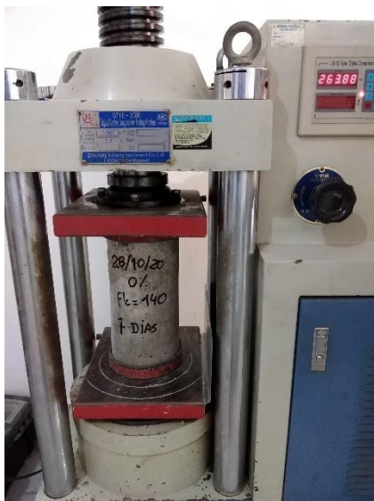
Rotura de probeta de concreto patrón f'c = 140 kg/cm 2 a los 7 días
