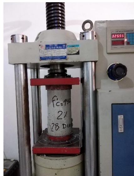
Rotura de probeta del concreto f'c = 140 kg/cm 2 con 2% de adición de plástico Pet a los 28 días
