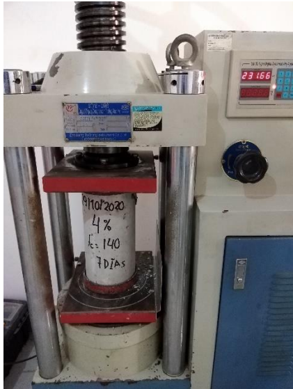
Rotura de probeta del concreto f'_c = 140 \text{ kg/cm}^2 con 4% de adición de plástico Pet a los 7 días
