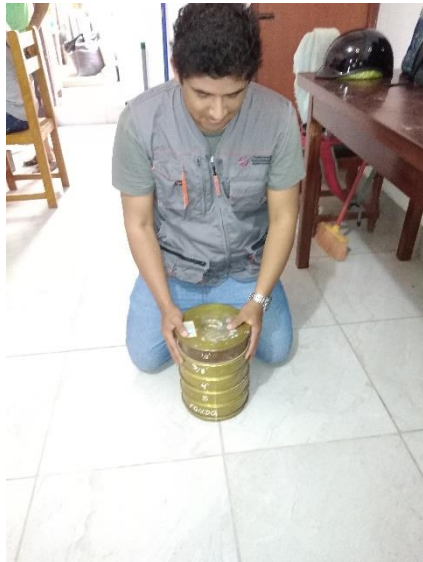
Tamizado de la piedra chancada
