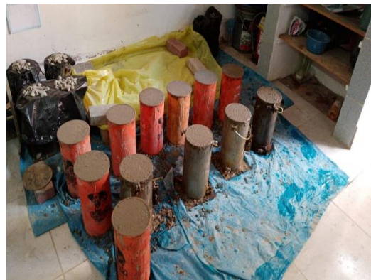
Elaboración de probetas para los ensayos de compresión
