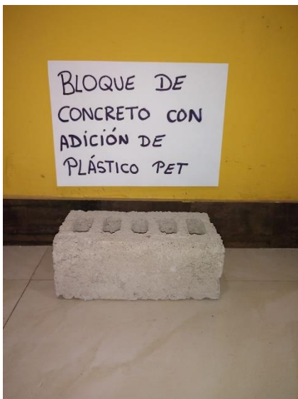
Producto final del bloque de concreto con adición de Plástico Pet, vista de frente lado longitudinal
