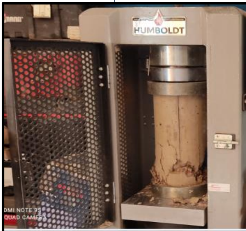
Figura 40: Imagen del tipo de fallas en la rotura de briquetas a la compresión
