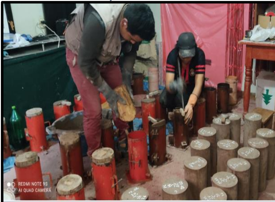
Figura 37: Imagen de la realización de los especímenes de concreto con juntas frías
