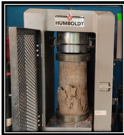
Figura28: Ensayo de compresión de las muestras Fuente: Elaboración Propia
