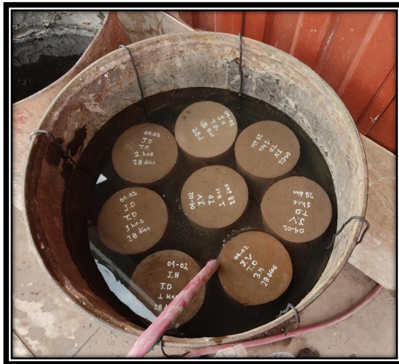
Figura24: Proceso de curado por inmersión de cada muestra. Fuente: Elaboración Propia
