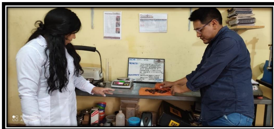
Figura 12: Secado superficialmente el agregado grueso para cálculo de peso específico Fuente: Elaboración Propia
