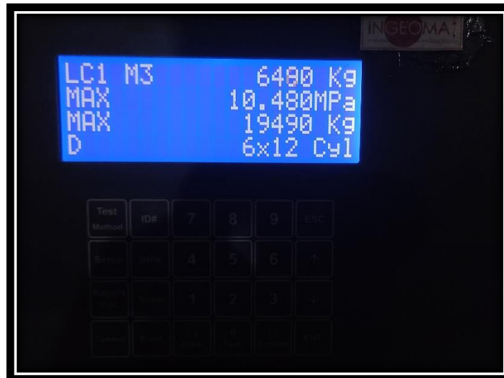
Figura 35: Resultado de carga aplicada de muestra sometida a ensayo de tracción indirecta Fuente: Elaboración Propia
