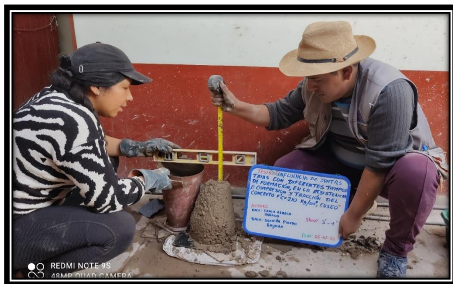
Figura 16: Ensayo de cono de abrams (slump), con (3.5") de asentamiento. Fuente: Elaboración Propia
