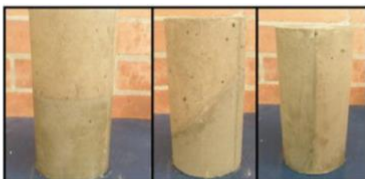
Figura 1: Muestras con junta fría horizontal, vertical y diagonal Fuente: (Torres, 2014, p.11) [2].
