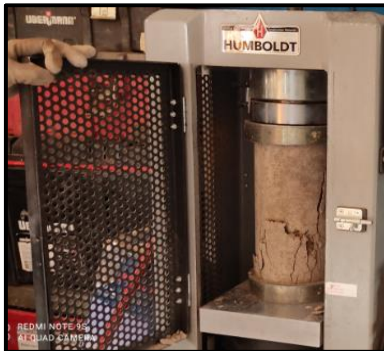
Figura 41: Imagen del tipo de fallas en la rotura de briquetas a la T.I
