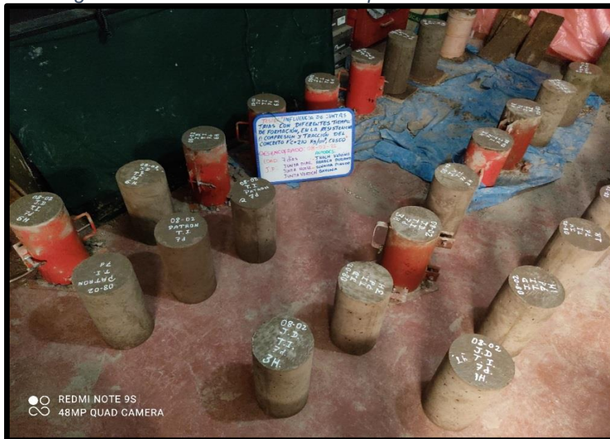
Figura 38: Desencofrado de las briquetas a edad de 7 días
