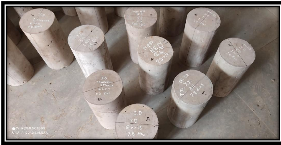
Figura 33: Dibujo de líneas diametrales de las muestras. Fuente: Elaboración Propia
