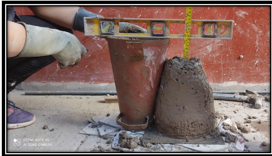
Figura 15: Ensayo de cono de abrams (slump), con un asentamiento de (3.3") Fuente: Elaboración Propia
