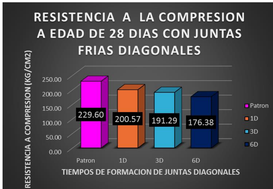
Grafico 15: Variación de la f'c a compresión, de las probetas con junta fría diagonal, con distintos periodos de formación en relación al concreto patrón a edad de 28 días
