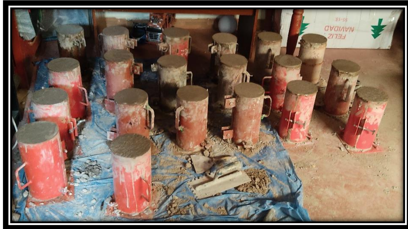
Figura 22: Muestras concluidas de las juntas frías y Patrón Fuente: Elaboración Propia
