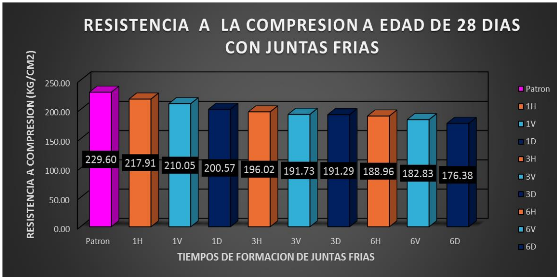
Grafico 16: Variación de f'c a compresión de la probeta patrón y las probetas con juntas frías horizontales, verticales y diagonales con diferentes tiempos de formación a edad de 28 días
