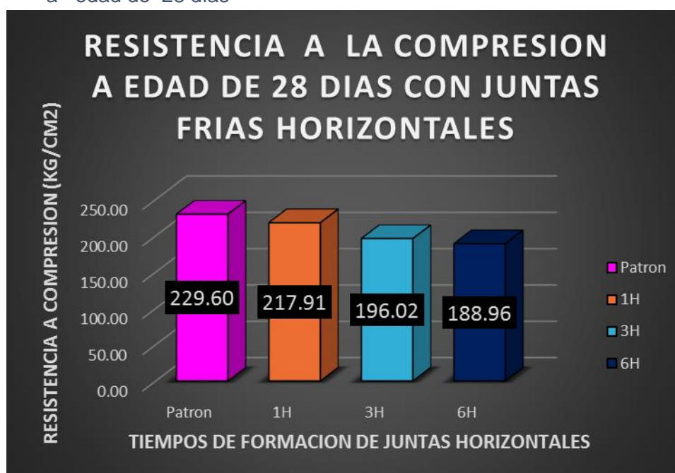
Grafico 13: Variación de la f'c a compresión, de las probetas con junta fría horizontal, con distintos periodos de formación en relación al concreto patrón a edad de 28 días
