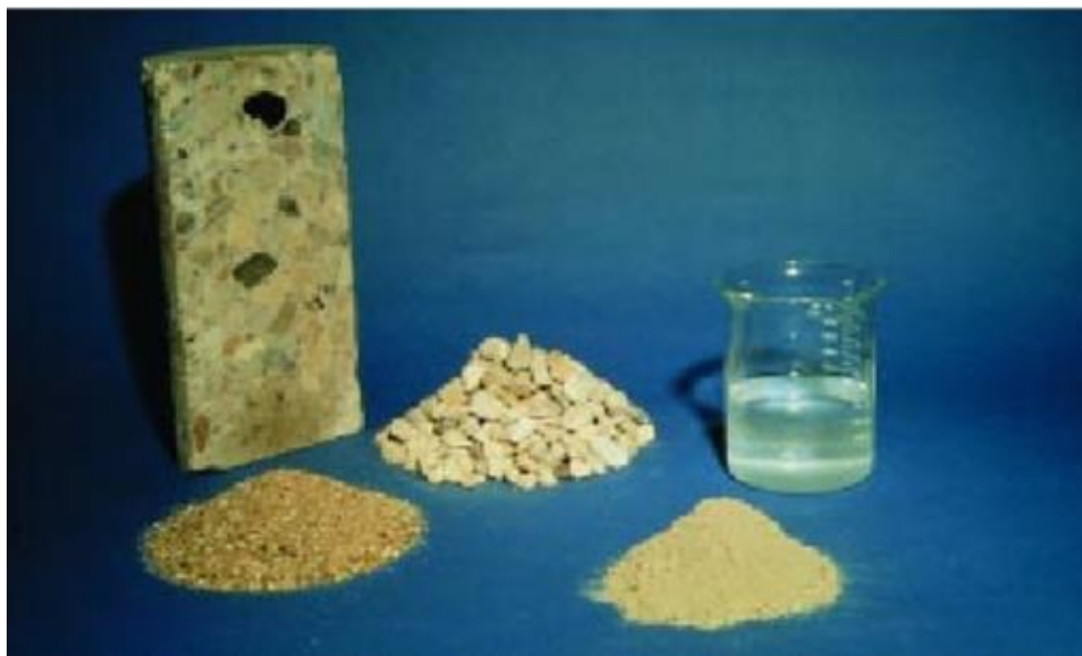
Figura 2: Elementos del concreto: Cemento, agua, agregado fino y grueso
