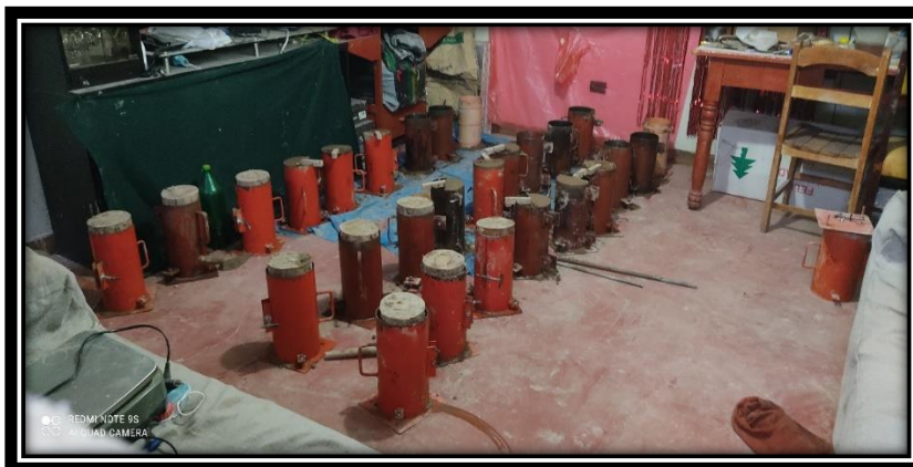
Figura 18: Proceso del vaciado de cada muestra con junta fría de 1h, 3h y 6h. Fuente: Elaboración Propia
