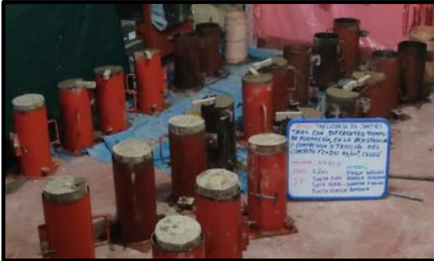
Figura 36: Imagen de las briquetas con moldes de madera para obtener las juntas frías horizontales, verticales y diagonales
