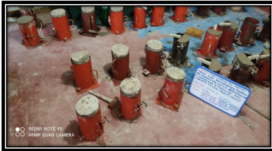
Figura 13: Moldes de las juntas frías diagonales y verticales usadas en el vaciado
