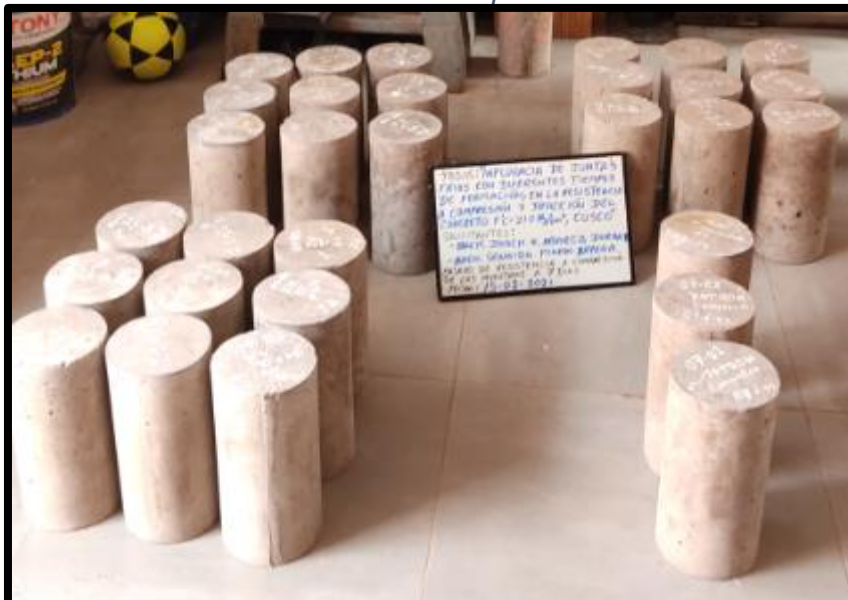
Figura 39: Rotura de briquetas en el laboratorio separadas por diferentes tiempo de formación
