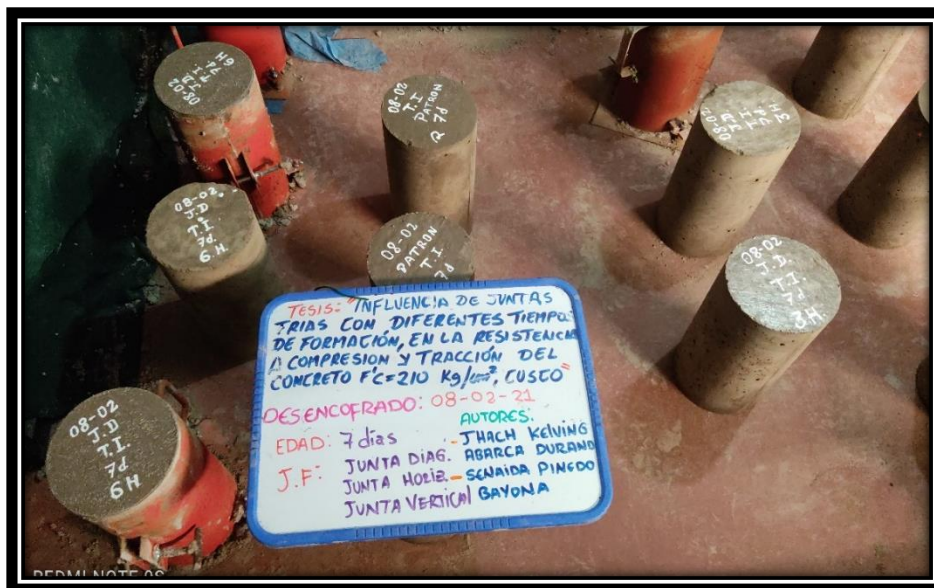
Figura 23: Identificación y desencofrado de cada muestra Fuente: Elaboración Propia
