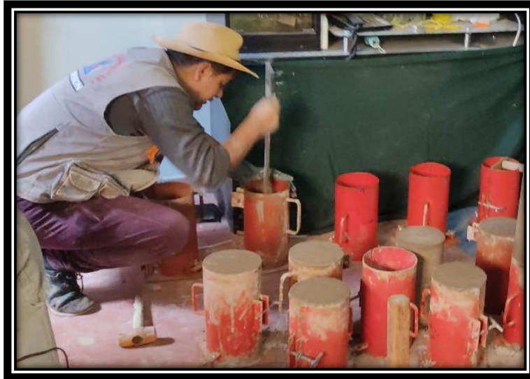
Figura 17: Chuseo con varilla normalizada de 5/8" Fuente: Elaboración Propia
