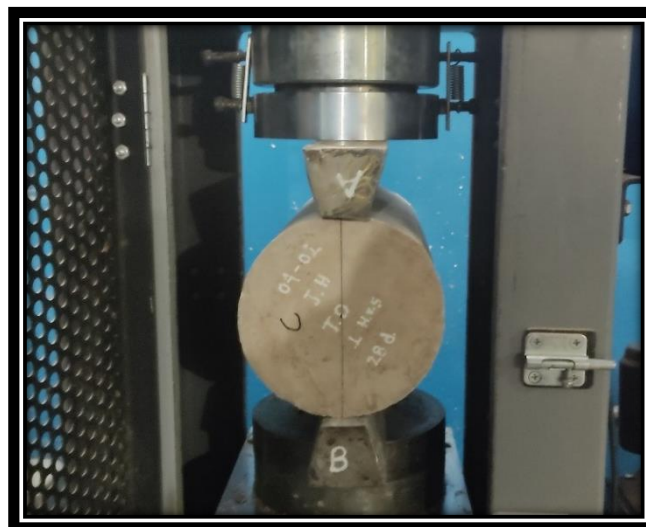
Figura 34: Muestra sometida a ensayo de tracción indirecta Fuente: Elaboración Propia
