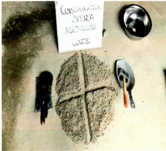
Figura n°02.- Se observa los ensayos realizados en laboratorio de la muestra obtenida en campo, estos ensayos corresponden al cuarto de la muestra, determinación del límite líquido, límite plástico, índice de plasticidad, para su posterior clasificación granulométrica.
