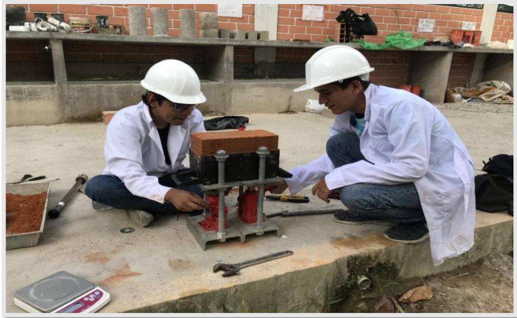
Figura 19. Extracción del adobe con la ayuda de dos gatas hidráulicas.
