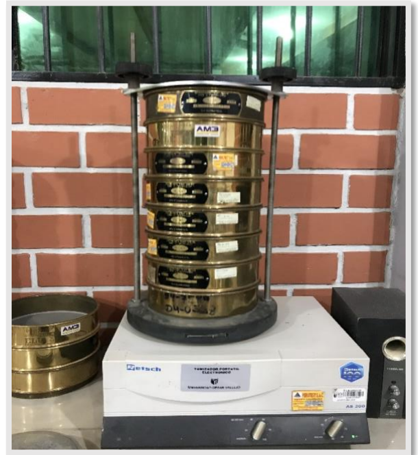
Figura 08. Tamizador de muestras para obtener la clasificación de suelo.
