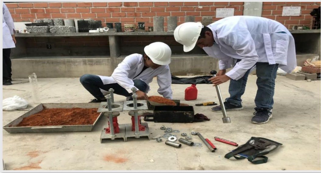
Figura 16. Se puede observar una vez mezclado la arcilla, agua y la fibra vegetal ponemos en el molde (29*14*9.5) cm. En capas de aproximados 3.30 cm cada uno.
