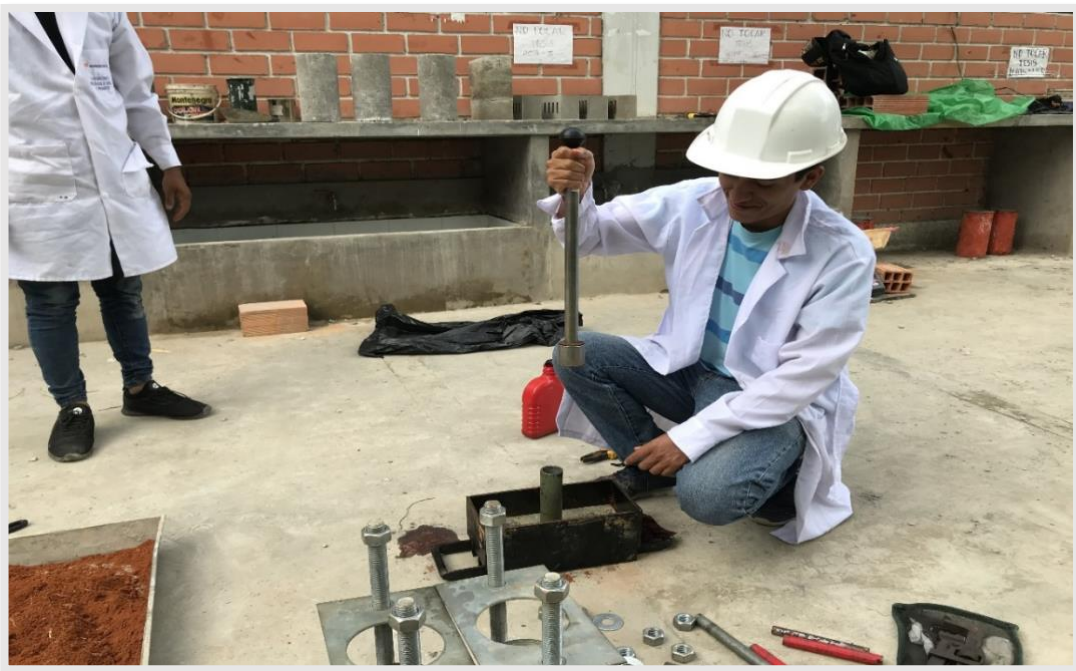
Figura 17. Se observa que el proceso compactación se utiliza con una plancha metálica y un martillo tipo proctor.
