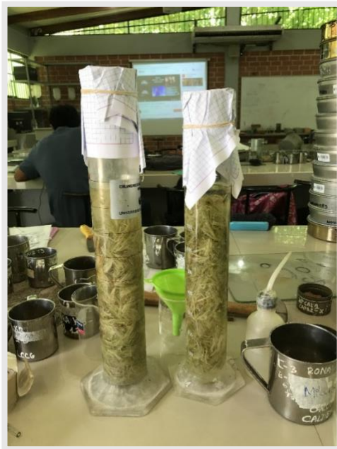
Figura 13. Estudio de la fibra, peso específico y absorción de la fibra de piña.
