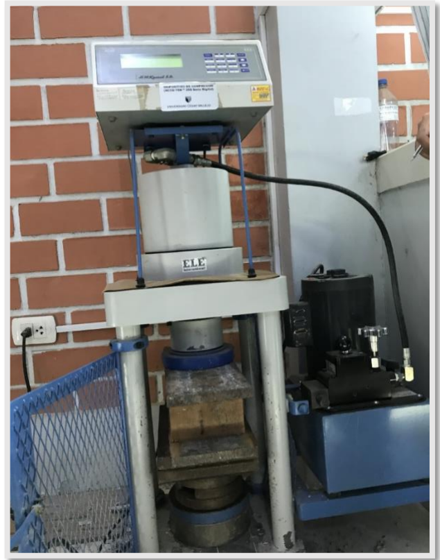
Figura 21. Ensayo de resistencia a la compresión.
