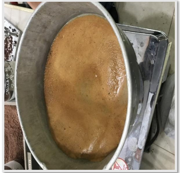
Figura 07. Secado de la muestra para realizar el ensayo de granulometría.
