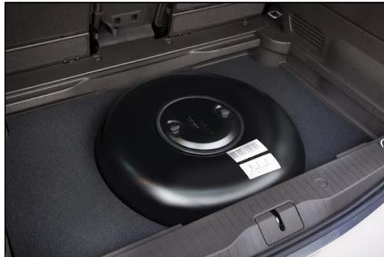
*Figura 10.* Depósito toroidal de gas GLP
