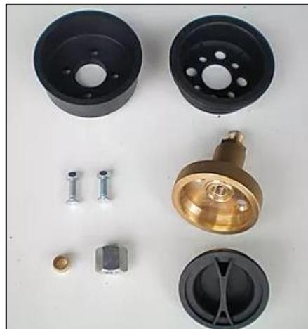
*Figura 09. Dispositivo del llenado del GLP.*
