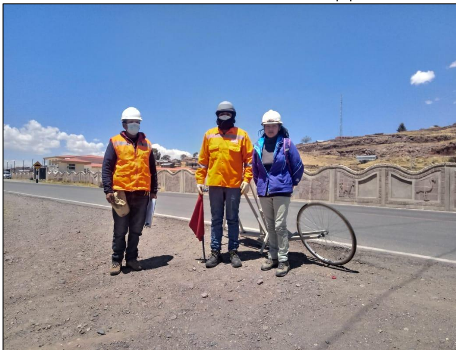
FIGURA 43: Proceso de medición con el equipo merlín
