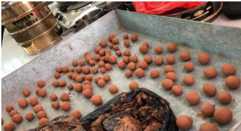
Trabajabilidad de la arcilla en el proceso de elaboración del Aliven
