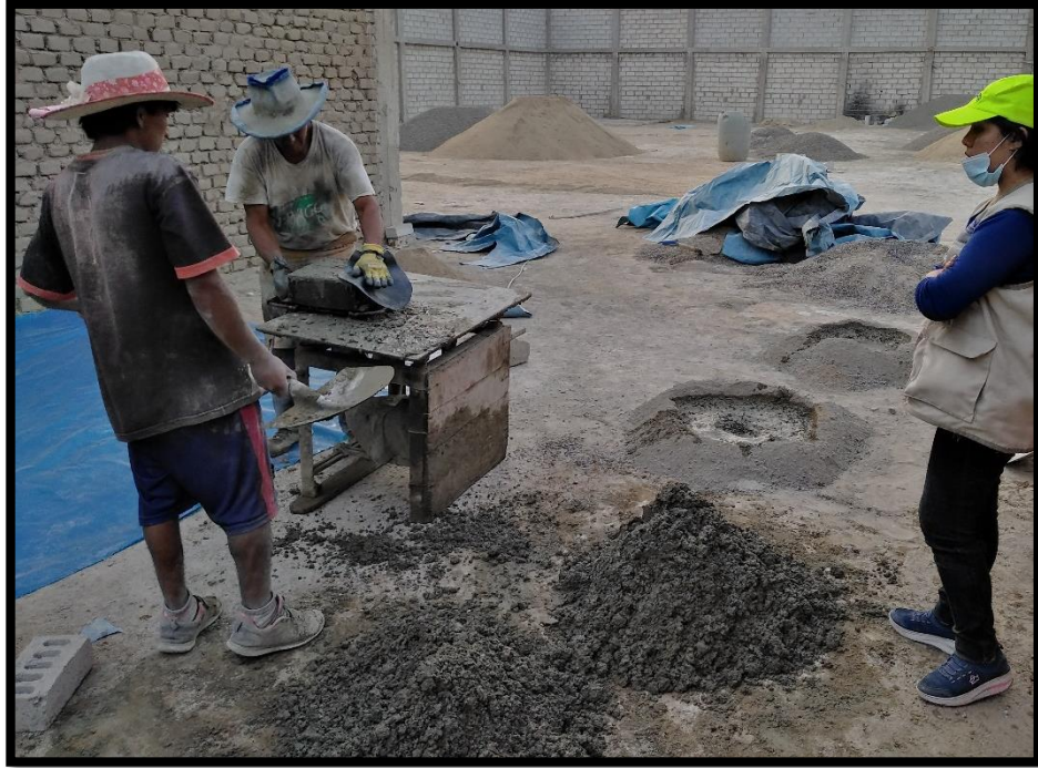
Figura 56: Realizando el vibrado del ladrillo de concreto con adición del Mucílago de Nopal.
