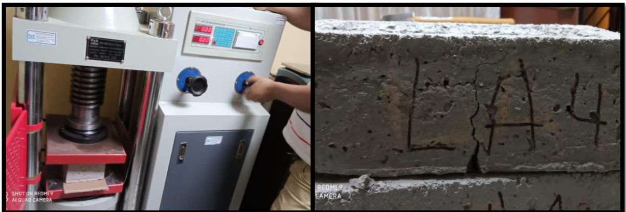
Figura 59: Rotura de los ladrillos de concreto patrón y con adición de mucílago de Nopal, este ensayo se realizó a los 7, 14 días y 28 días de curado.
