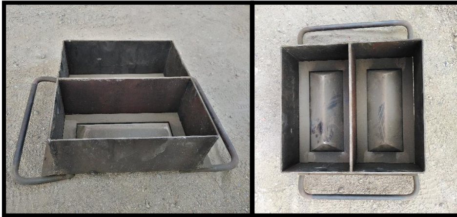
Figura 52: Molde con dimensiones de 13cm x 9 cm x 24 cm, para elaborar ladrillos de concreto
