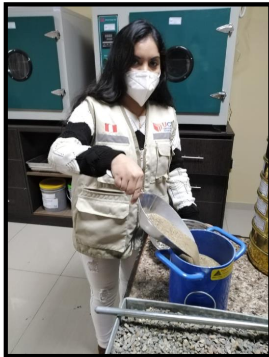
Figura 35: Llenado del recipiente con el agregado fino
