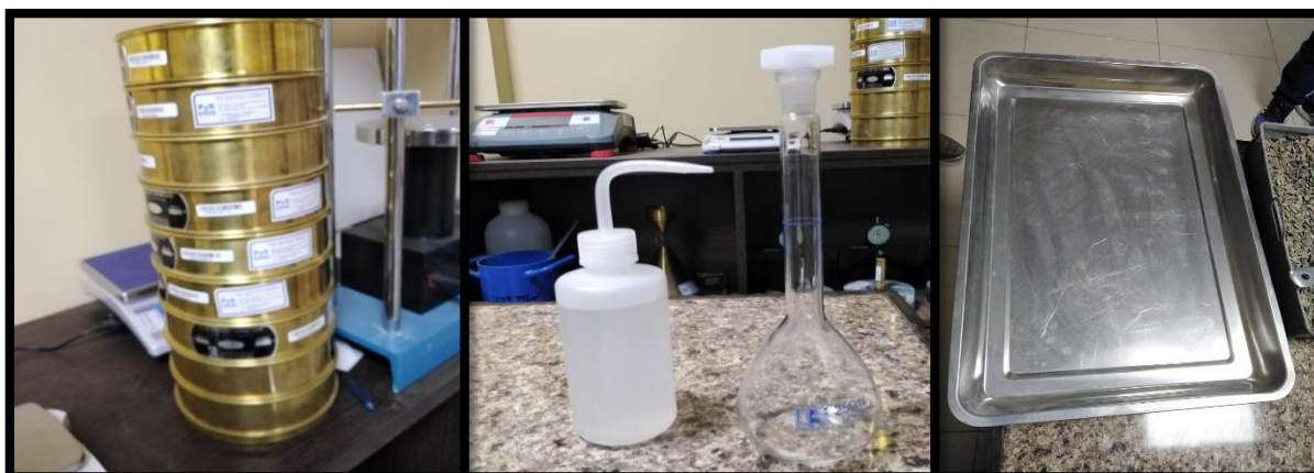
Figura 41: Instrumentos usados en los diferentes ensayos de los Agregados (Tamices, fiola, pipeta y bandeja)
