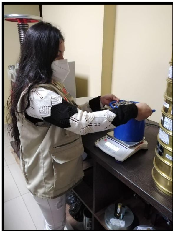
Figura 39: Peso de las muestras del peso unitario seco suelto y compacto.
