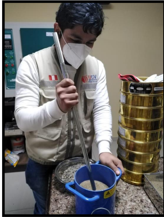
Figura 36: Apisonado del Agregado Fino (Peso Unitario Compactado).
