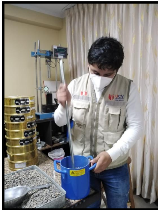
Figura 37: Apisonado del Agregado Grueso (Peso Unitario Compactado).
