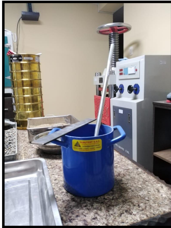
Figura 34: Recipiente en el cual se realizó los ensayos de peso unitario (agregado fino y grueso)
