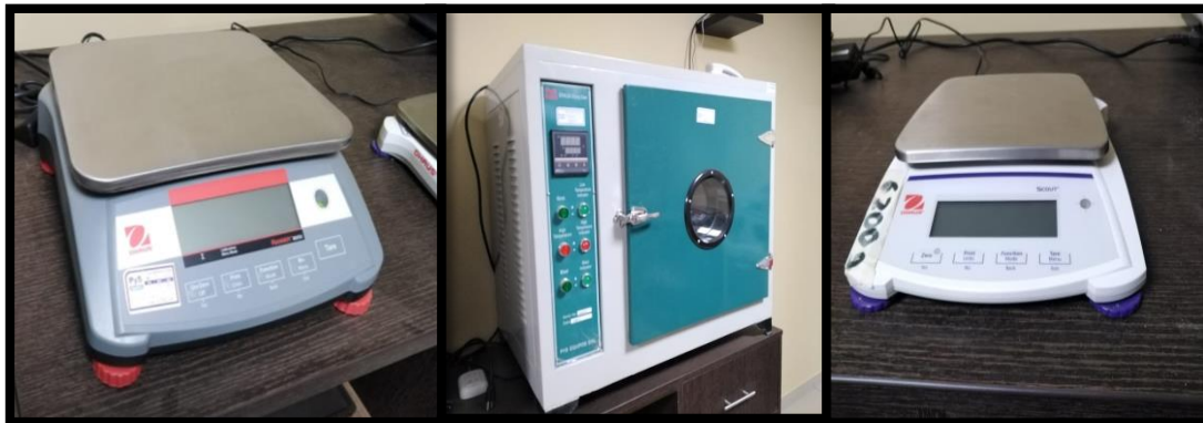
Figura 40: Instrumentos usados en los diferentes ensayos de los Agregados (balanzas y horno)
