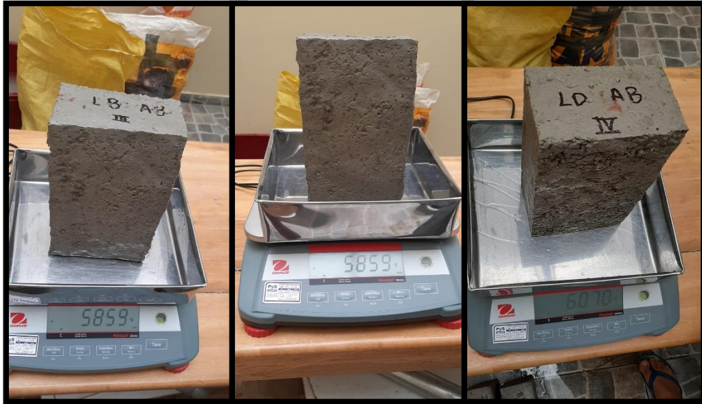
Figura 60: Pesado de los ladrillos de concreto patrón y con adición de mucílago de Nopal, luego de haber realizado el ensayo de absorción, este ensayo se realizó a los 28 días de curado.
