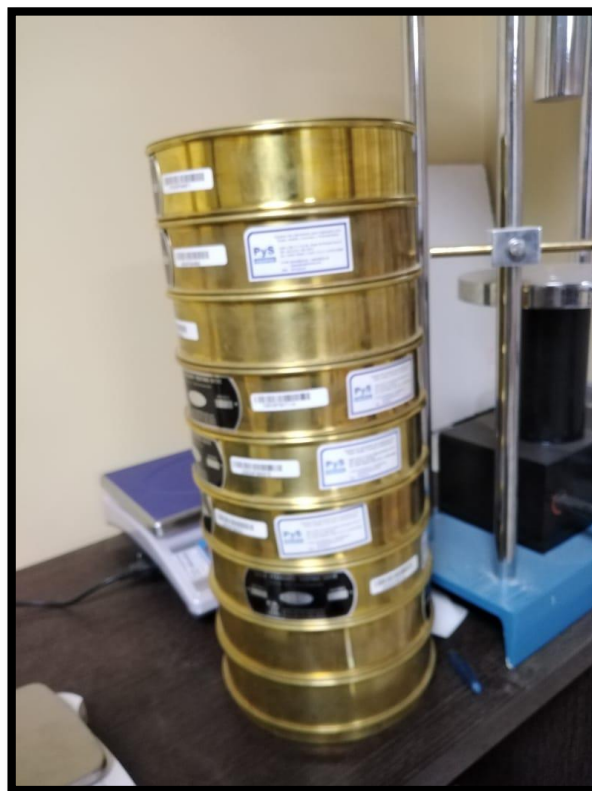
Figura 31: Colocación de los tamices para el ensayo de granulometría
