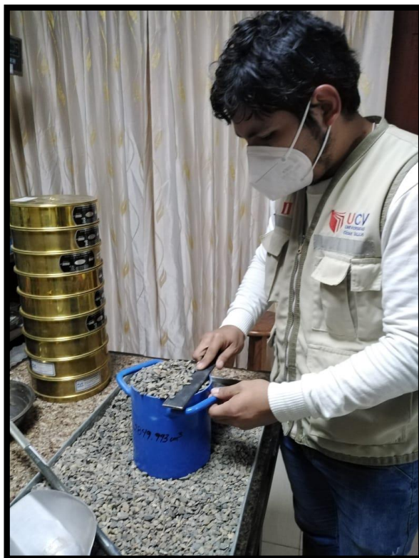
Figura 38: Determinando el peso unitario Agregado grueso (confitillo)
