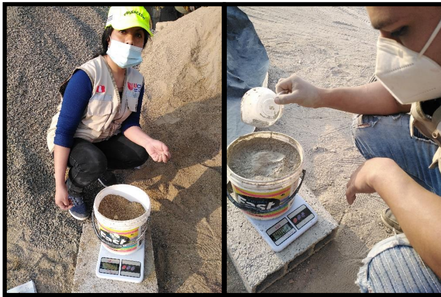
Figura 53: Pesado de los agregados y cemento.
