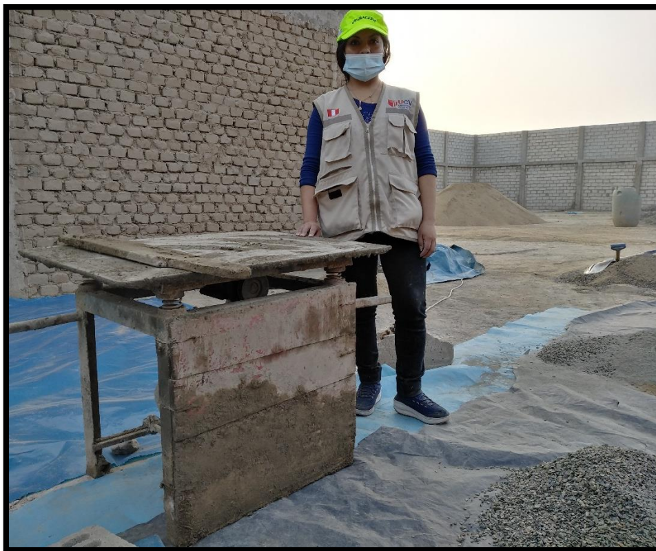
Figura 51: Mesa vibradora para la elaboración de los ladrillos de concreto con adición del Mucílago de Nopal.
