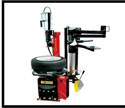
Figura 1 Extractor de llantas.
