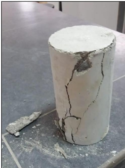
**Figura 9.** Probeta sometida a compresión
