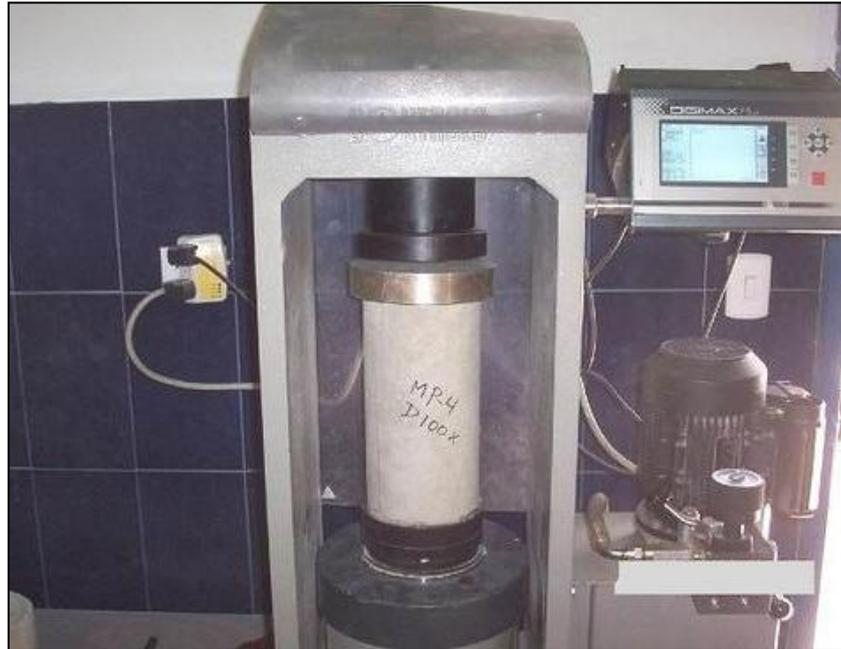
**Figura 1.** Ensayo de compresión en probetas
