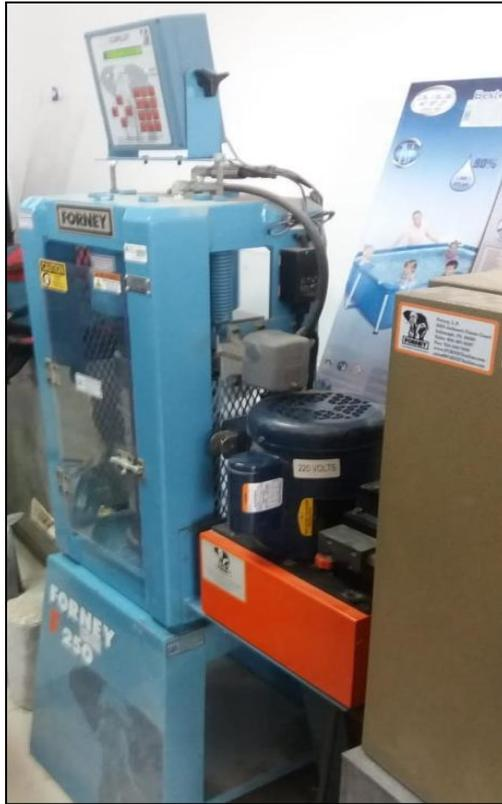
**Figura 8.** Prensa usada para el ensayo a compresión
