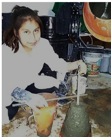
Figura 40: Asentamiento de concreto con la proporción 0.8%.de fibra de coco.
