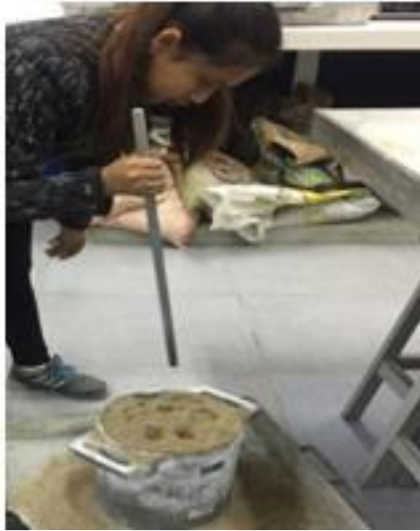
Figura 33: Peso unitario compactado del agregado fino
