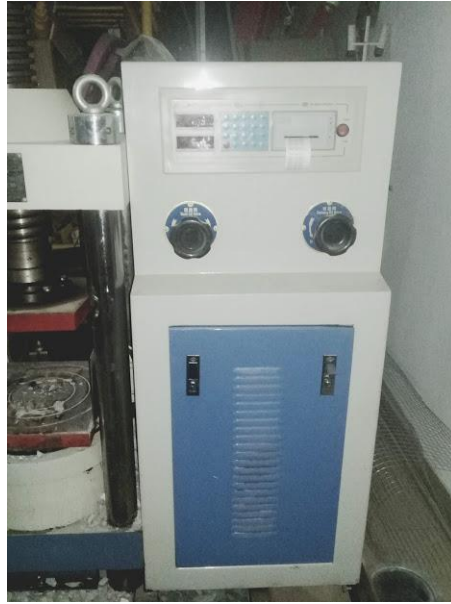
Figura 47: Prensa de concreto para realizar el ensayo a compresión
