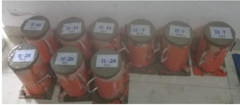
Figura 41: Probetas de concreto 0.8% de fibra de coco para edades 7, 14, 28 días.
