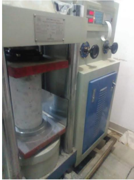
Figura 49: Ensayo a compresión del concreto f'c=210\text{kg/cm}^2 con fibras de coco.
