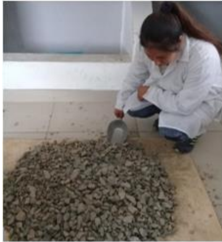
Figura 25: Cantidad de 40 kg de agregado grueso de \frac{1}{2} " , para el cuarteo.
