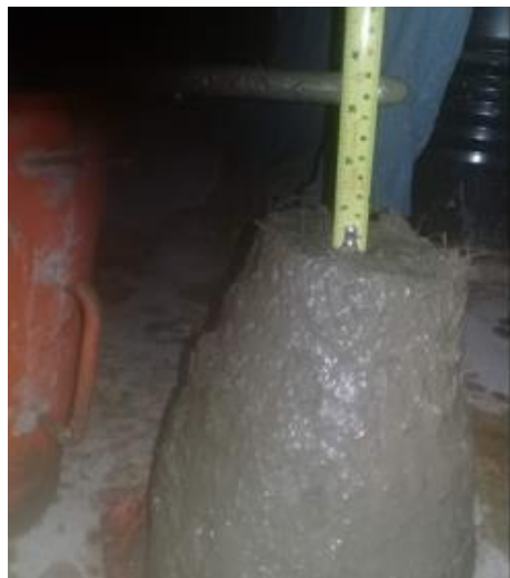
Figura 43: Asentamiento de concreto con la proporción 1.6% de fibra de coco
