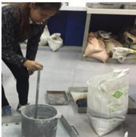
Figura 30: Peso unitario compactado del agregado grueso de \frac{1}{2} "
