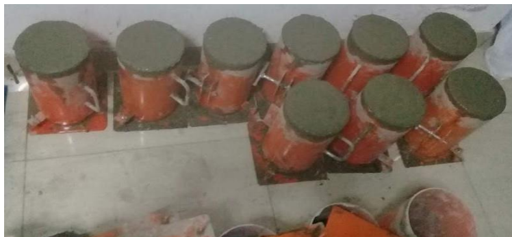
Figura 46: Probetas de concreto 2.4% de fibra de coco para edades 7, 14, 28 días.
