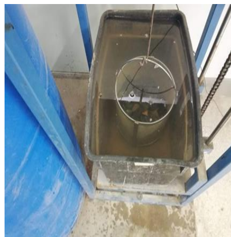
Figura 31: Peso específico y absorción del agregado grueso
