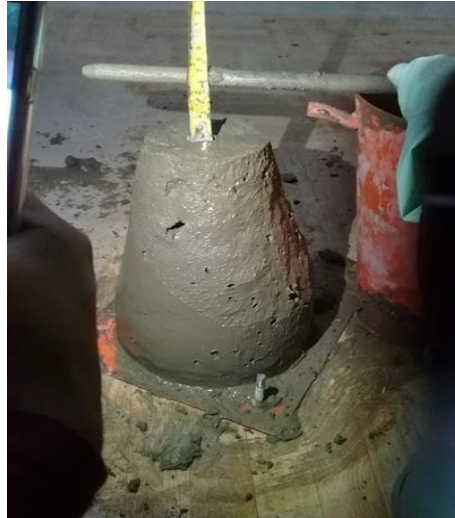
Figura 38: Asentamiento del concreto patrón f'c=210\text{kg/cm}^2
