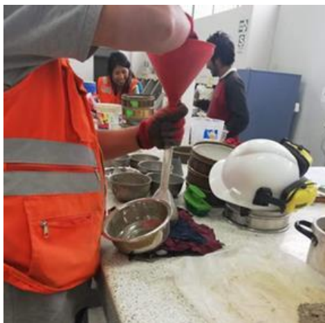
Figura 34: Peso específico y absorción del agregado fino
