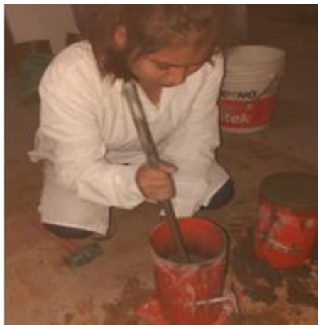
Figura 37: Ensayo de cono de Abrams del concreto patrón f'c=210\text{kg/cm}^2
