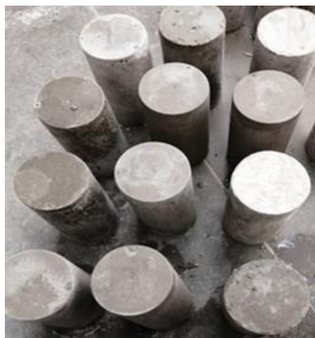
Figura 48: Probetas de concreto f'_c=210\text{kg/cm}^2 con fibras de coco.
