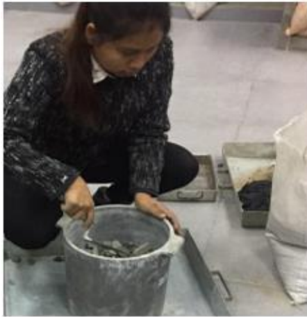
Figura 29: Peso unitario suelto del agregado grueso de \frac{1}{2} "
