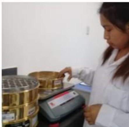
Figura 27: Peso de cada tamiz para realizar la granulometría-
