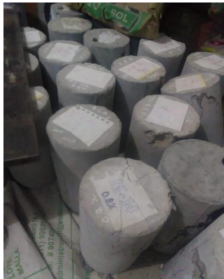
Figura 50: Rotura de probeta de concreto f'c=210\text{kg/cm}^2 con fibras de coco.
