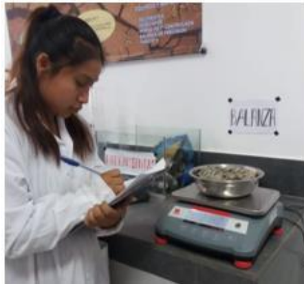
Figura 26: Se procedió a pesar el agregado grueso de \frac{1}{2} " .
