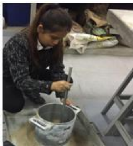
Figura 32: Peso unitario suelto del agregado fino
