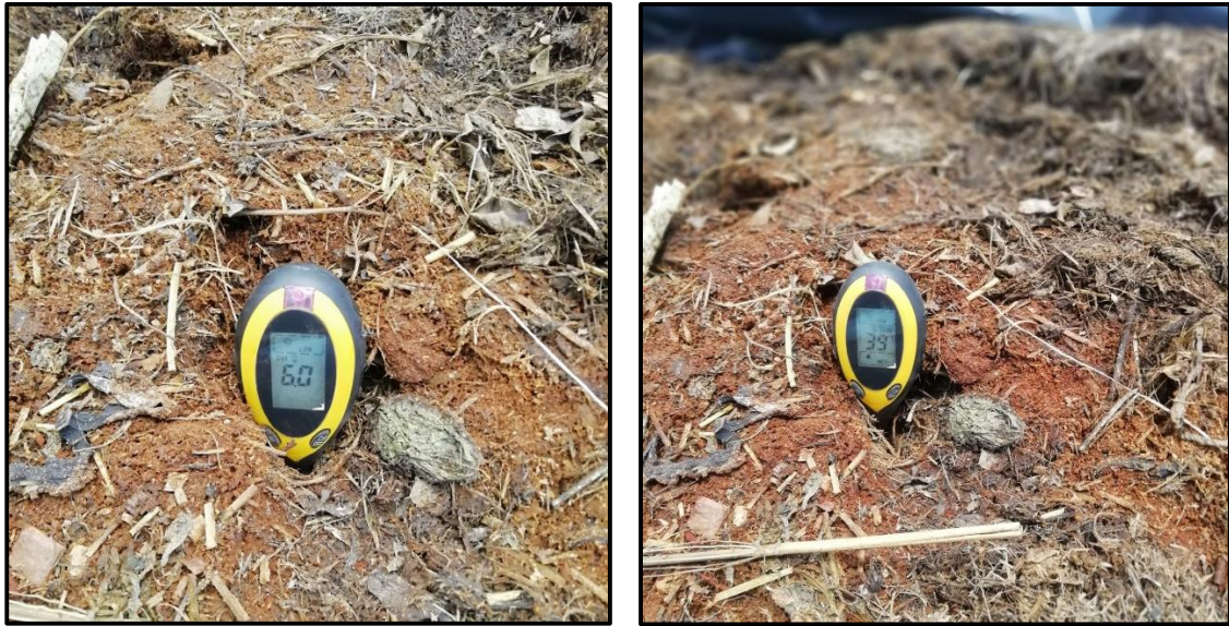
Figura 31. Medición de Parámetros T^\circ , pH y humedad
