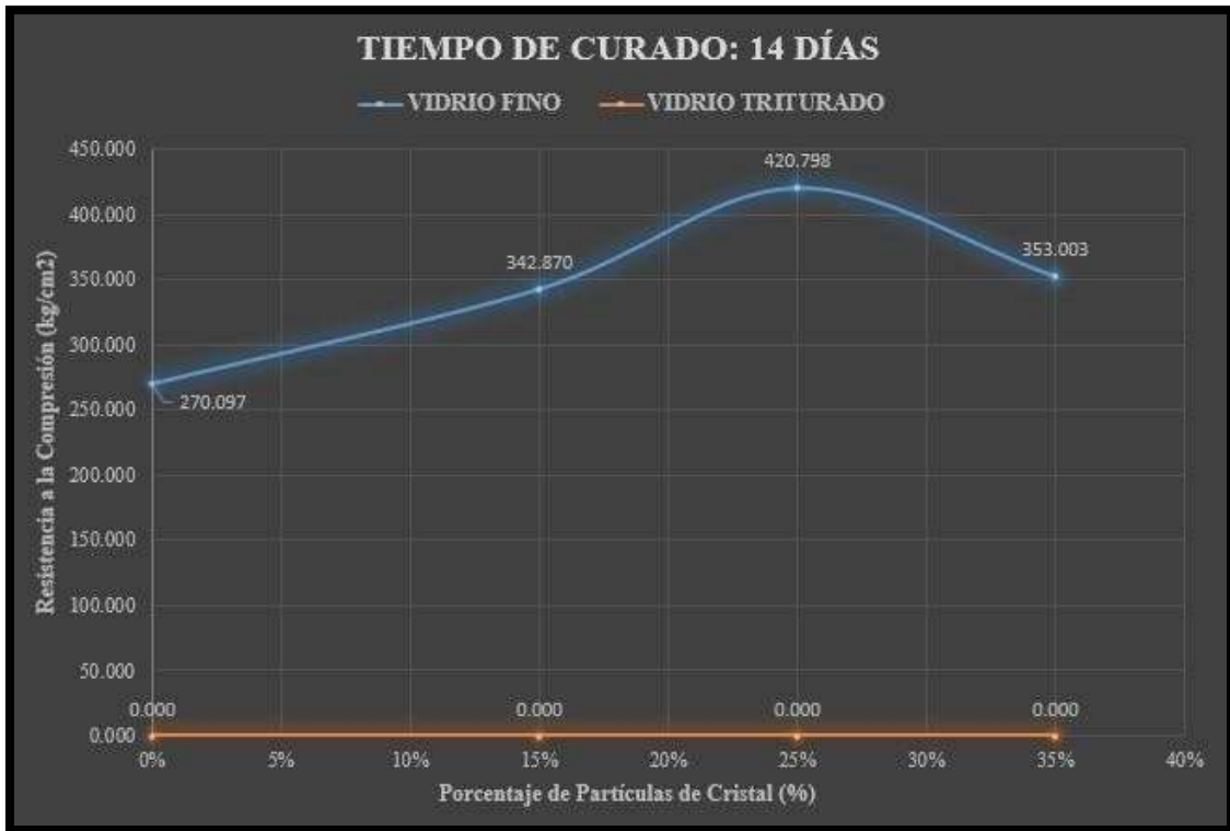
Gráfica 1. Resistencia a la compresión promedio de 14 días de curado. Fuente: Elaboración propia, 2018.
