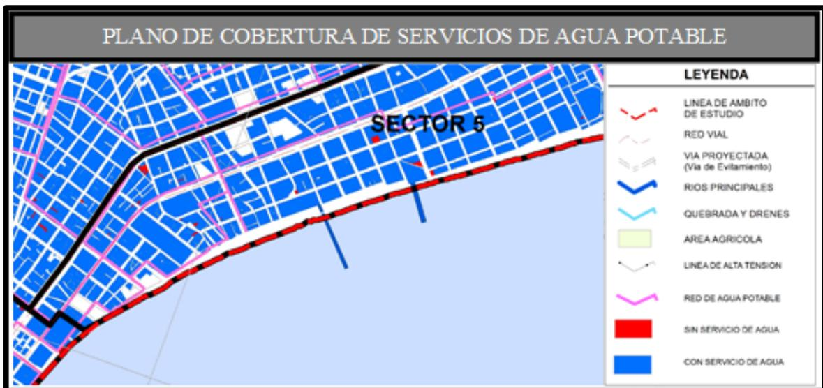
Figura N°12. Plano de servicios de agua potable
