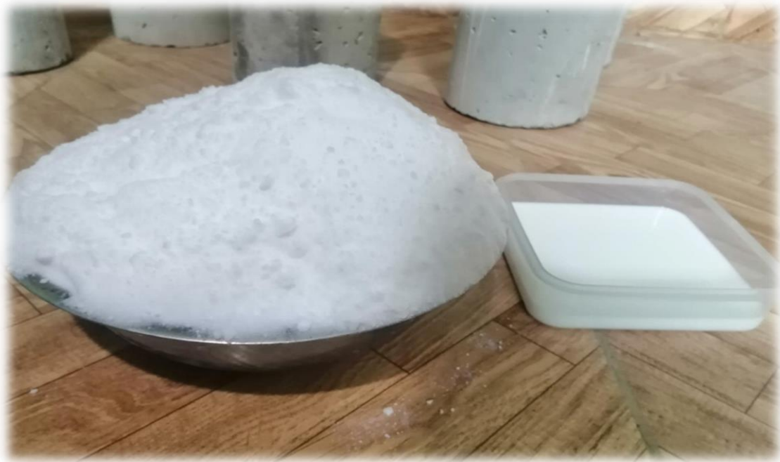
Dióxido de Silicio más Dióxido de Silicio granulado o (Sílice granulado) dosificación para lograr una textura trabajable
