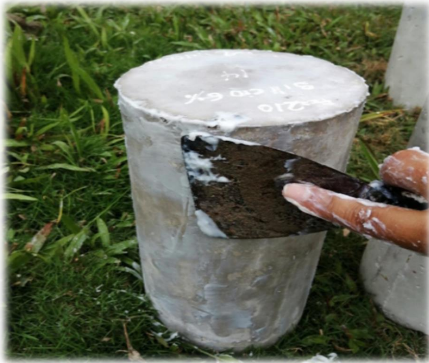
Aplicación del compuesto o aditivo en toda la superficie del testigo, aplicación de una capa con espátula.
