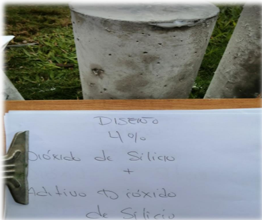
Testigo al 4% con adición en capa del compuesto o aditivo de Dióxido de Silicio expuesto a la radiación solar para registro térmico.
