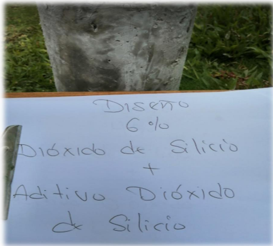
Testigo al 6% con adición en capa del compuesto o aditivo de Dióxido de Silicio expuesto a la radiación solar para registro térmico
