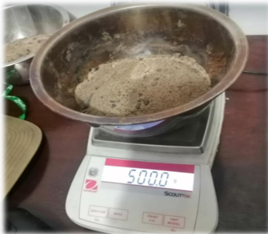
Contenido de arena seca, para sacar el contenido de humedad del agregado.
