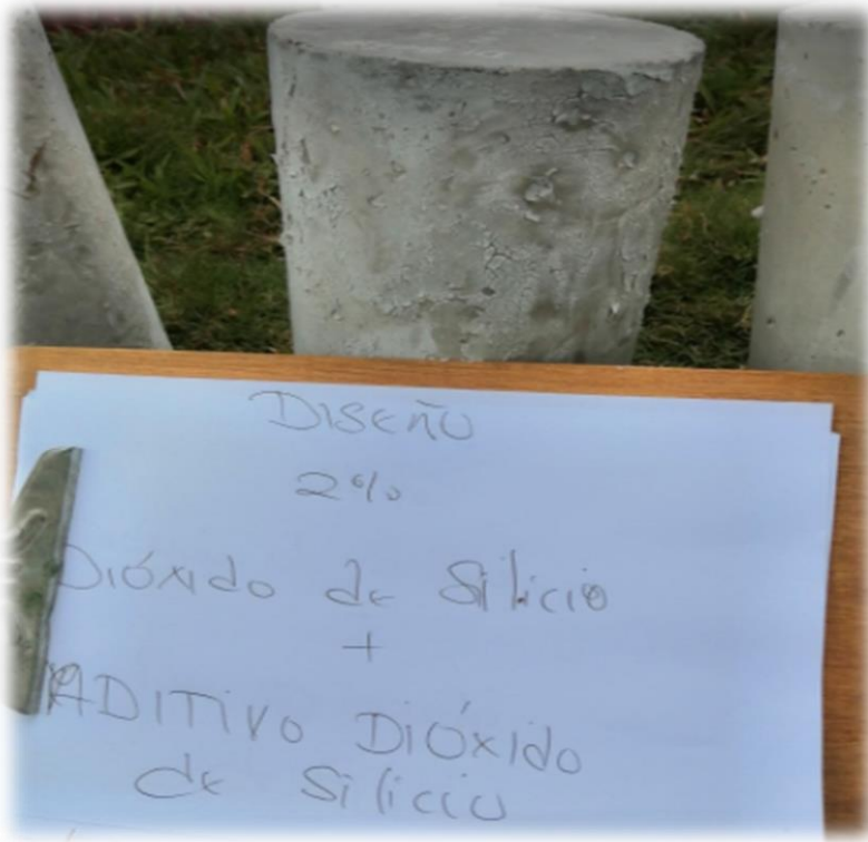
Testigo al 2% con adición en capa del compuesto o aditivo de Dióxido de Silicio expuesto a la radiación solar para registro térmico.
