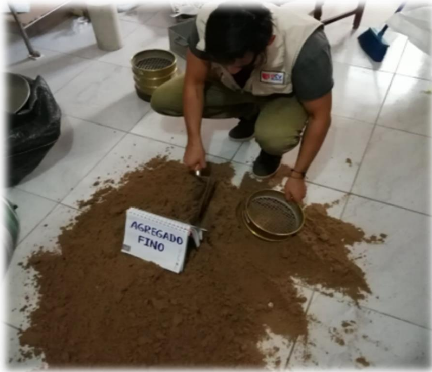
Proceso de partición de agregado fino para tamiz.
