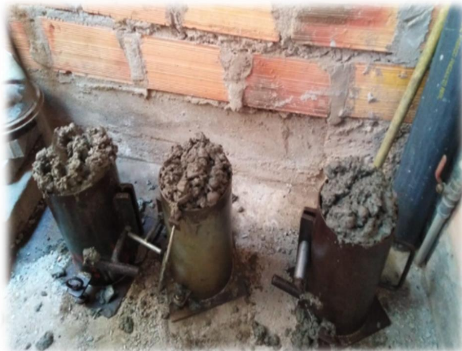
Moldeo de probetas con los 25 golpes y con el diseño de mezcla correspondiente en porcentajes.
