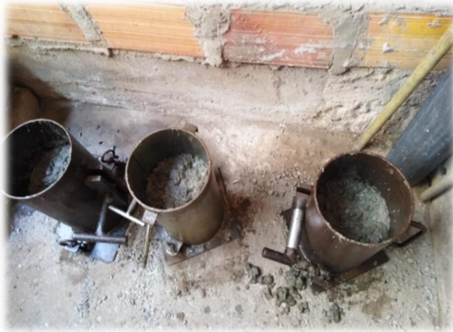
Llenado de probetas con el varillado respectivo y en partes, con diseño de mezcla según porcentajes
