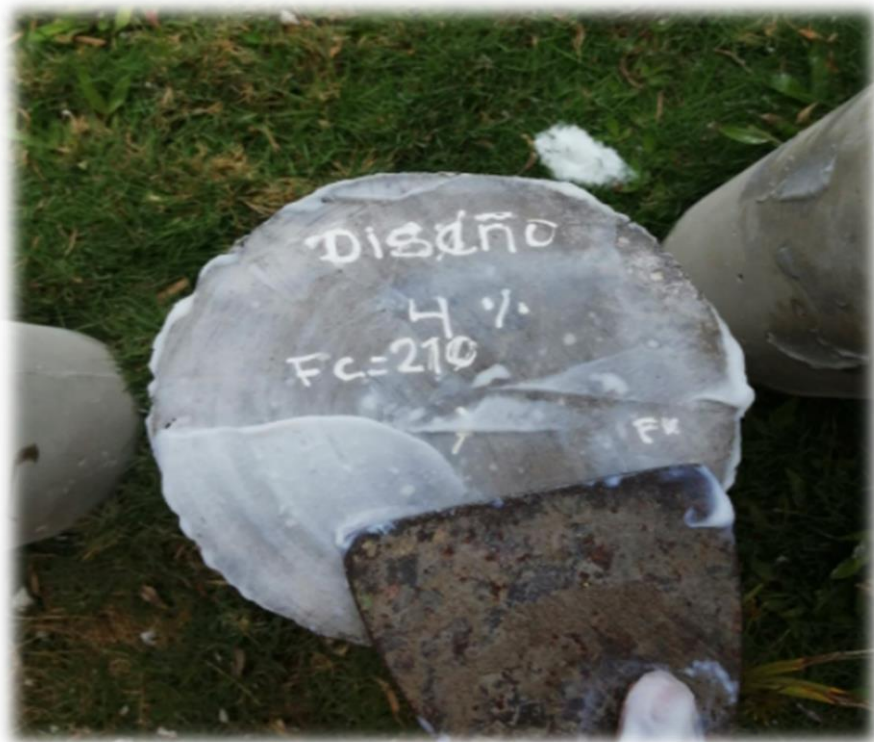
Vista en planta de testigo, en proceso de aplicación del compuesto o aditivo en toda la superficie.
