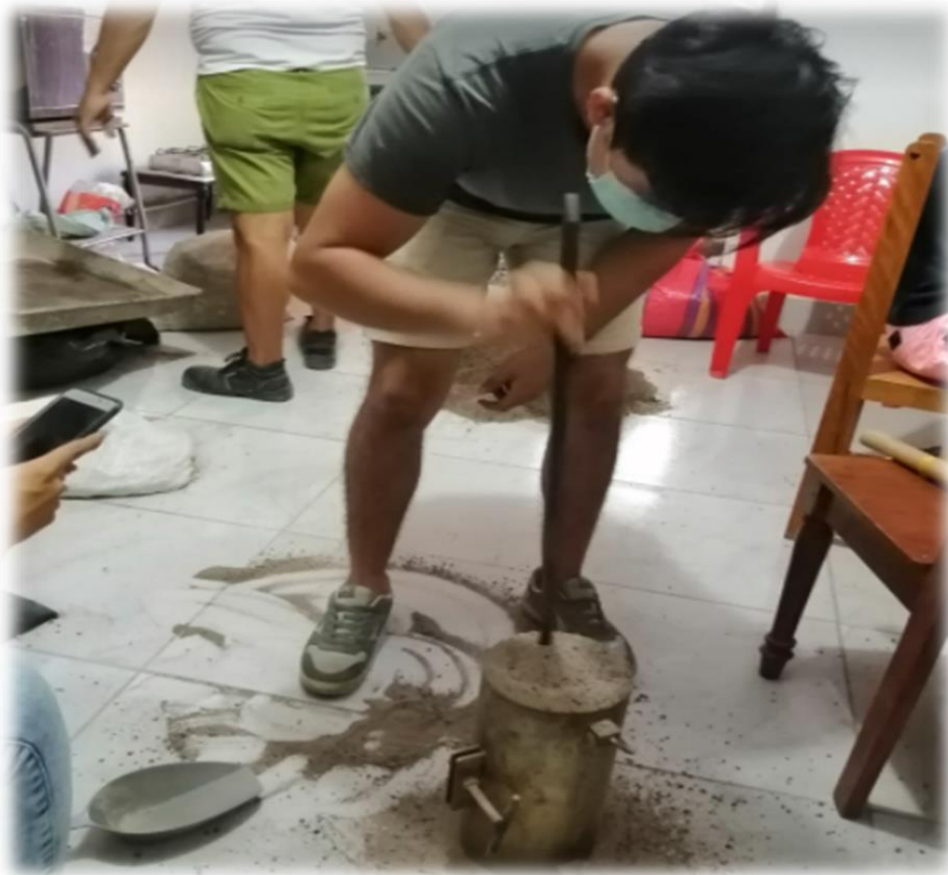
Varillado de agregado fino para peso unitario, para representar el peso entre el volumen.
