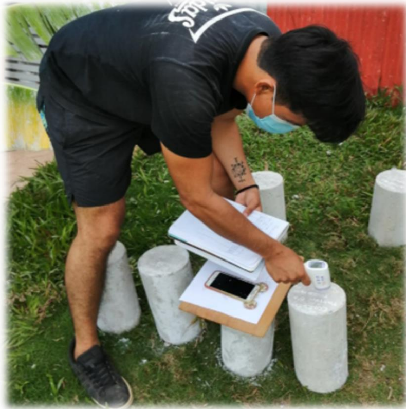
Tomando lectura térmica de testigos, bajo la radiación solar.
