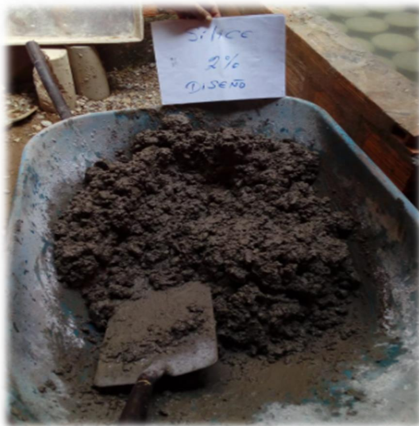
Mezcla con diseño de concreto F_c = 210 \text{ kg/cm}^2 más adición de 2% de Dióxido de Silicio
