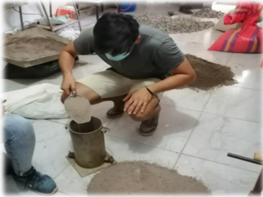
Llenado de probeta en tres partes con varillado de 25 golpes, agregado fino.
