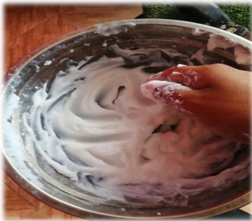
Mezcla del Dióxido de Silicio con el Sílice granulado, aprox. 600 ml de Sílice granulado por 100 gr. De Dióxido de silicio.
