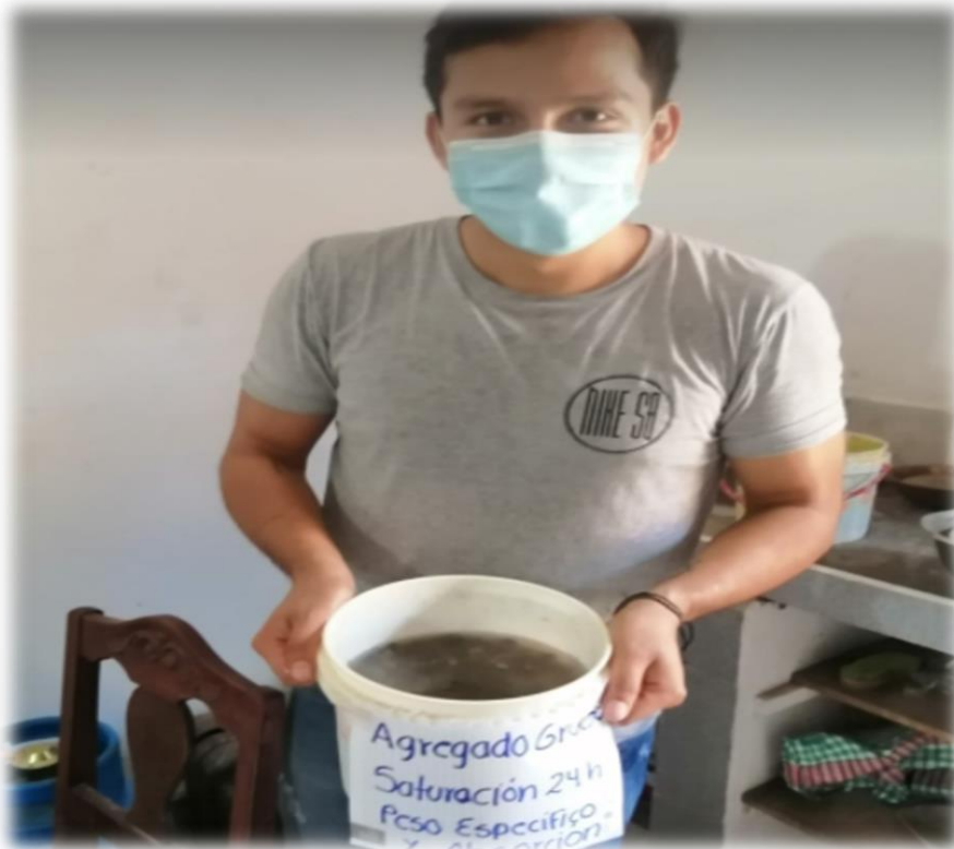
Saturación y peso específico de agregado grueso.
