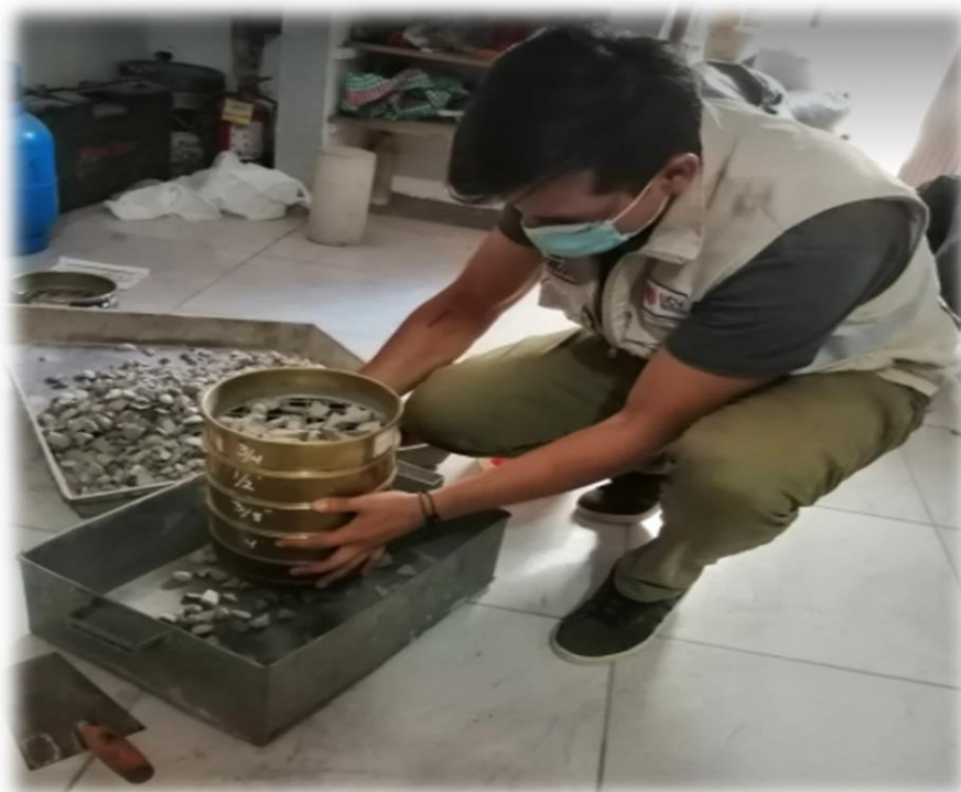
Proceso de tamiz de agregado.
