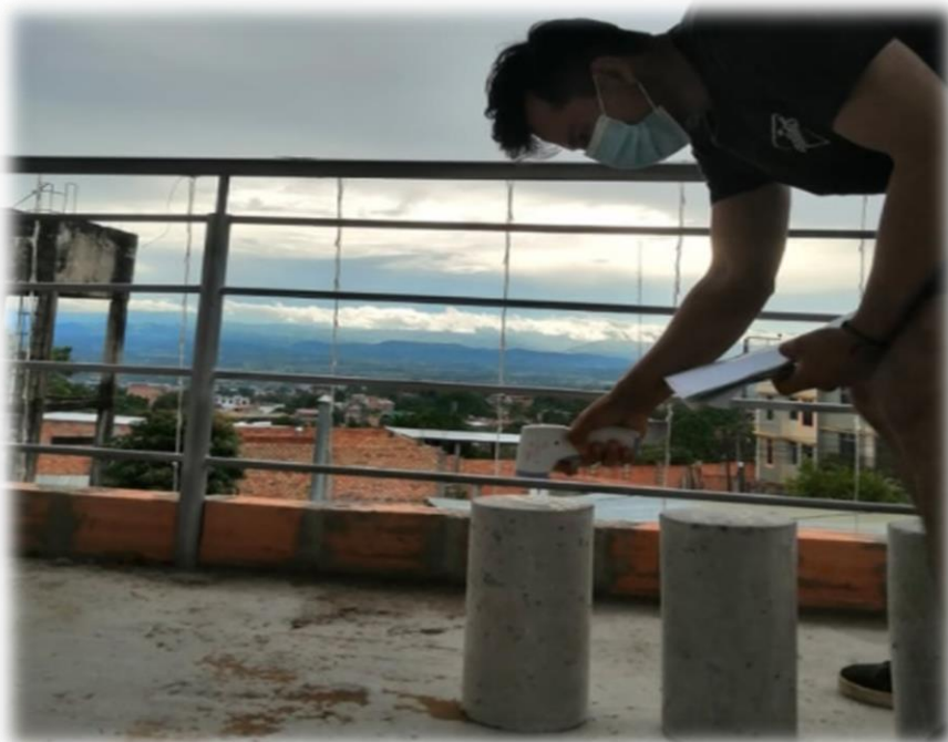
Tomando registro térmico de testigos con adición de dióxido de silicio en diseño y compuesto o aditivo bajo radiación solar, después de una precipitación pluvial.
