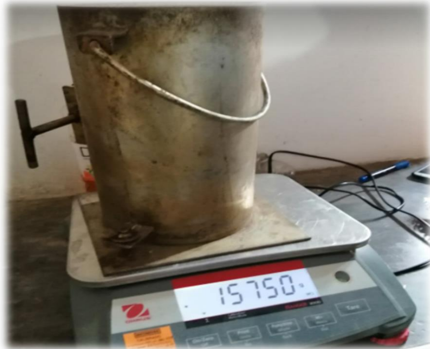
Pesaje de material varillado para determinación de peso unitario, y representación de peso entre volumen.
