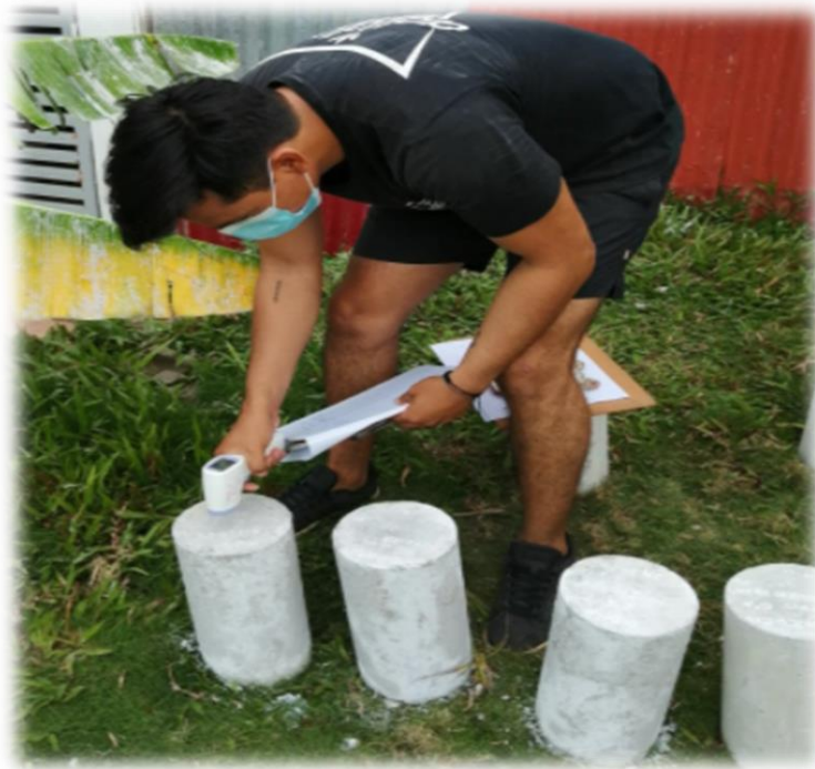
Tomando registro térmico de testigos con adición de dióxido de silicio en diseño y compuesto o aditivo bajo radiación solar.
