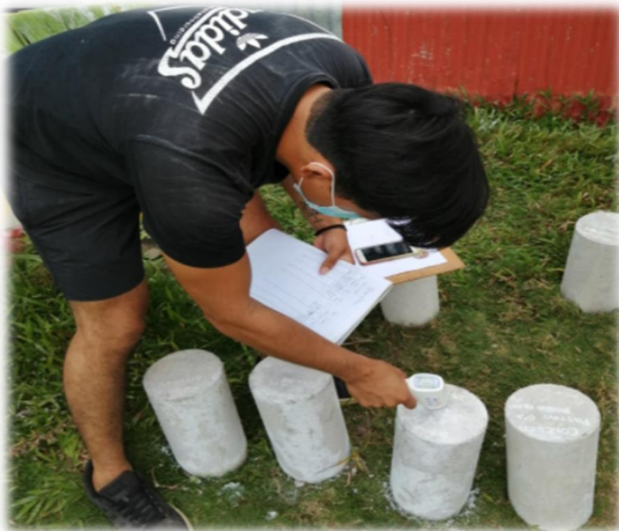
Tomando registro térmico de testigos con adición de dióxido de silicio en diseño y compuesto o aditivo bajo radiación solar.
