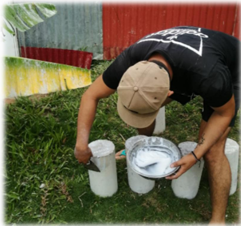
Proceso de aplicación del compuesto o aditivo en toda la superficie de los testigos.
