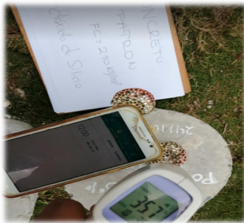
Registro térmico de testigo bajo la radiación solar.
