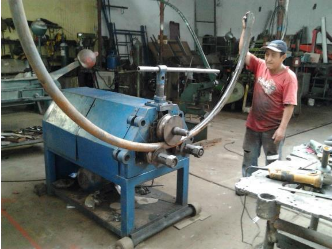
Figura III. Se visualiza máquina roladora de tubos, perfiles, para uso estructural y de cerrajería metálica.
