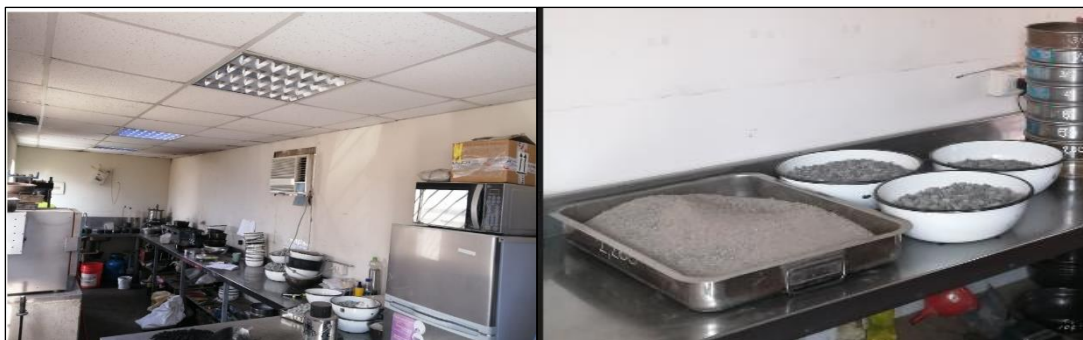
Figura 13: Granulometría al RAP/ laboratorio Planta de Asfalto Victoria 2-Propia
