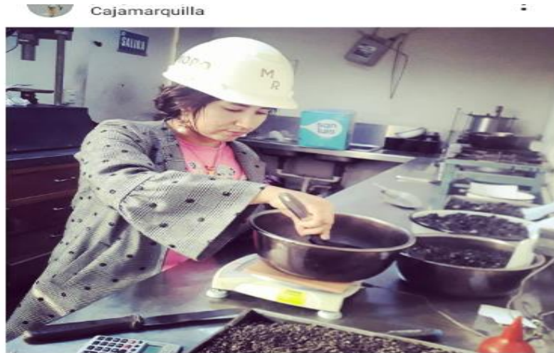
Figura 15: Realizando la adición de emulsión para llegar al optimo-Fuente propia
