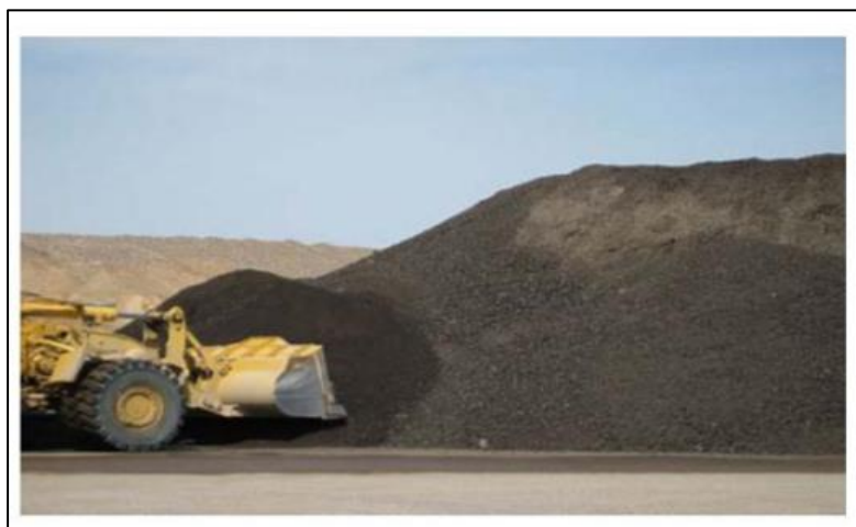
Figura 11: Acopio del Rap en Planta de Victoria II. Toma realizada por el autor
