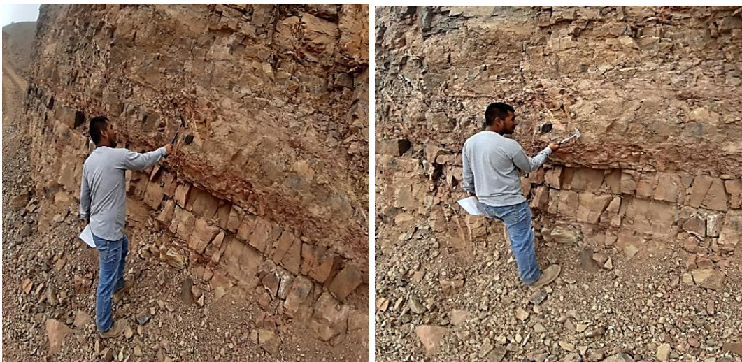
Figura 20. Resistencia de la roca intacta usando la picota de geólogo.
