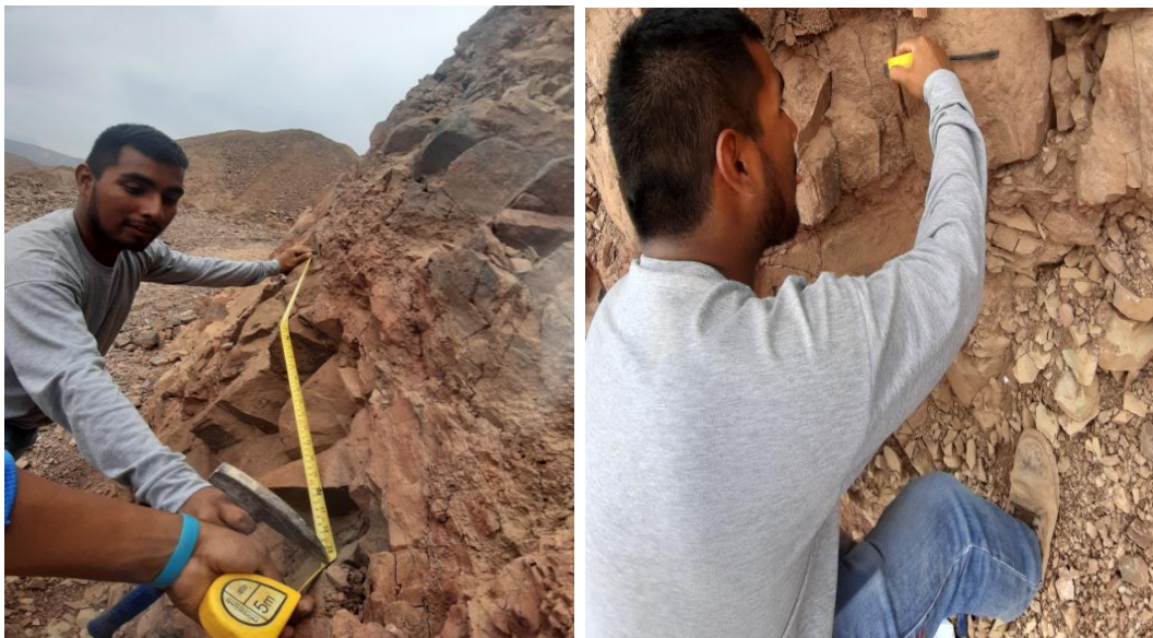
Figura 21. Empleo del método del metro lineal y espaciado de las discontinuidades.
