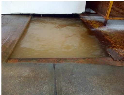
Figura 34: Nivel de salmuera en el término del sistema de agitación y el inicio del corredor.
