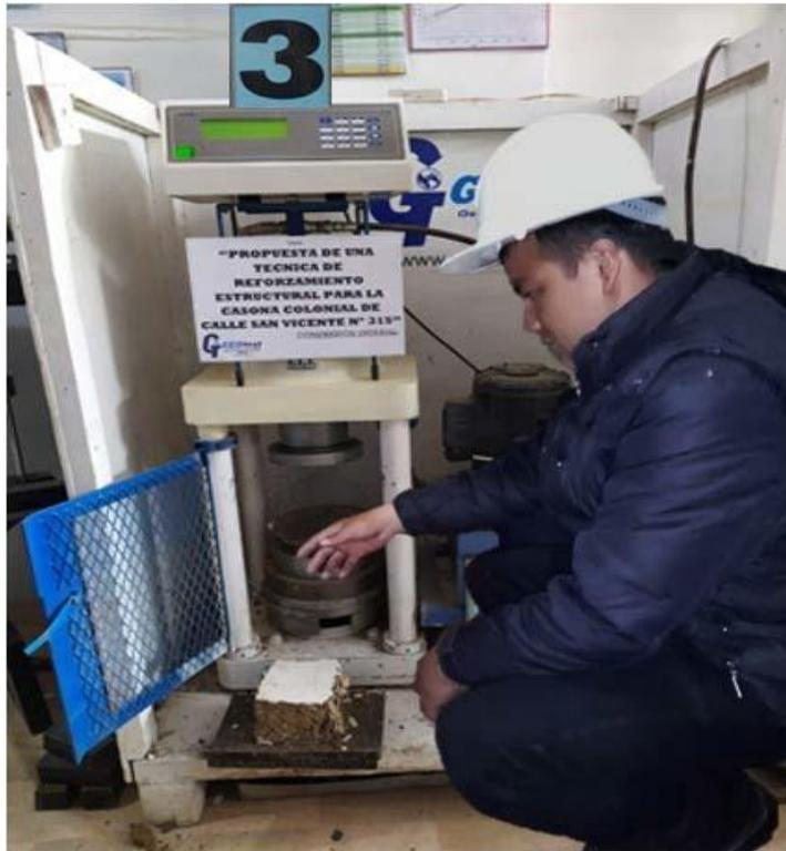
FIGURA-02 ENSAYO DE LA TERCERA MUESTRA DEL CUBO PRISMATICO
