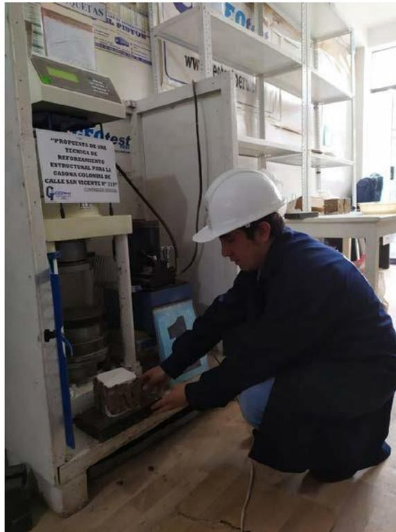
FIGURA-02 LEVANTAMIENTO DEL ENSAYO DE LA PRIMERA MUESTRA DEL CUBO PRISMATICO
