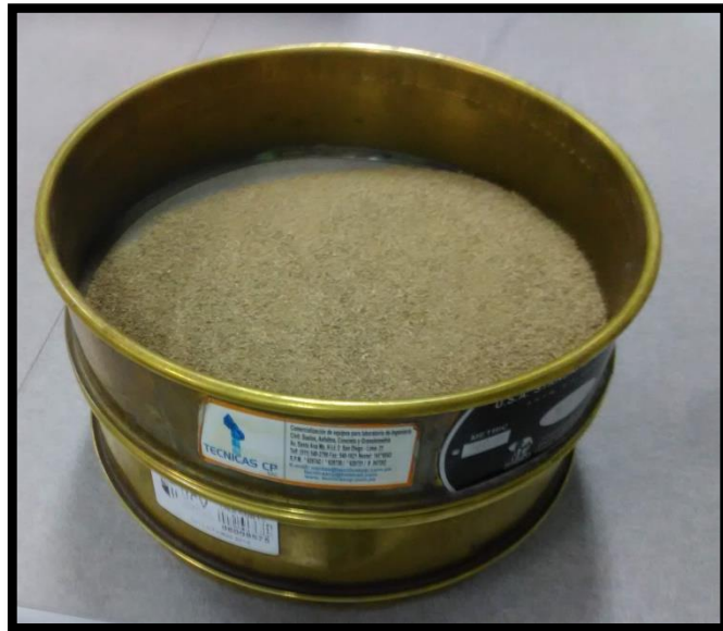
Figura 7: Tamizado de la muestra de lignocelulosa residual con medida de 180 \mu\text{m}
