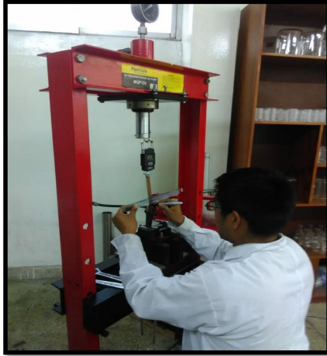
Figura 12: Estandarización de las probetas de bioplástico para la prueba de elongación
