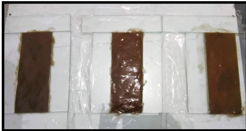
Figura 10: Bioplástico de yuca con lignocelulosa residual en molde
