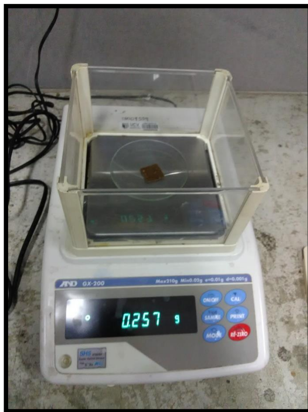
Fuente: Elaboración propia Figura 15: Pesado de muestras para la biodegradación
