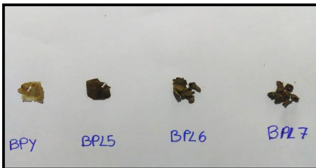
Figura 18: Muestras secas para un periodo de 20 de días de biodegradación
