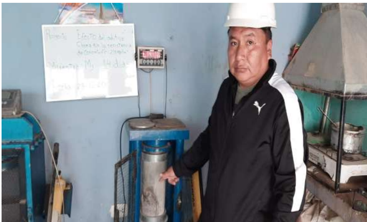
Imagen 26: Ensayos de compresión de la probetas M3 a los 14 días de antigüedad, en laboratorio.
