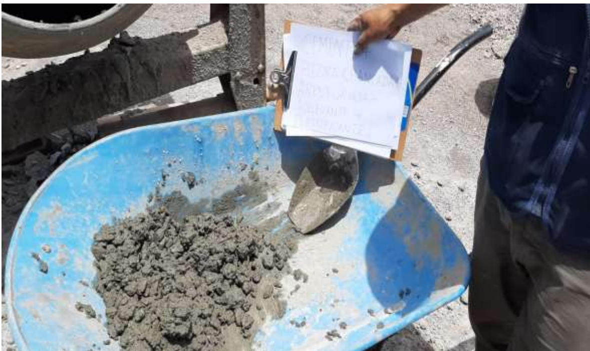
Imagen 12: Proceso de obtención de las probetas según el diseño de mezcla. Propiedades físicas del concreto patron sin aditivo.
