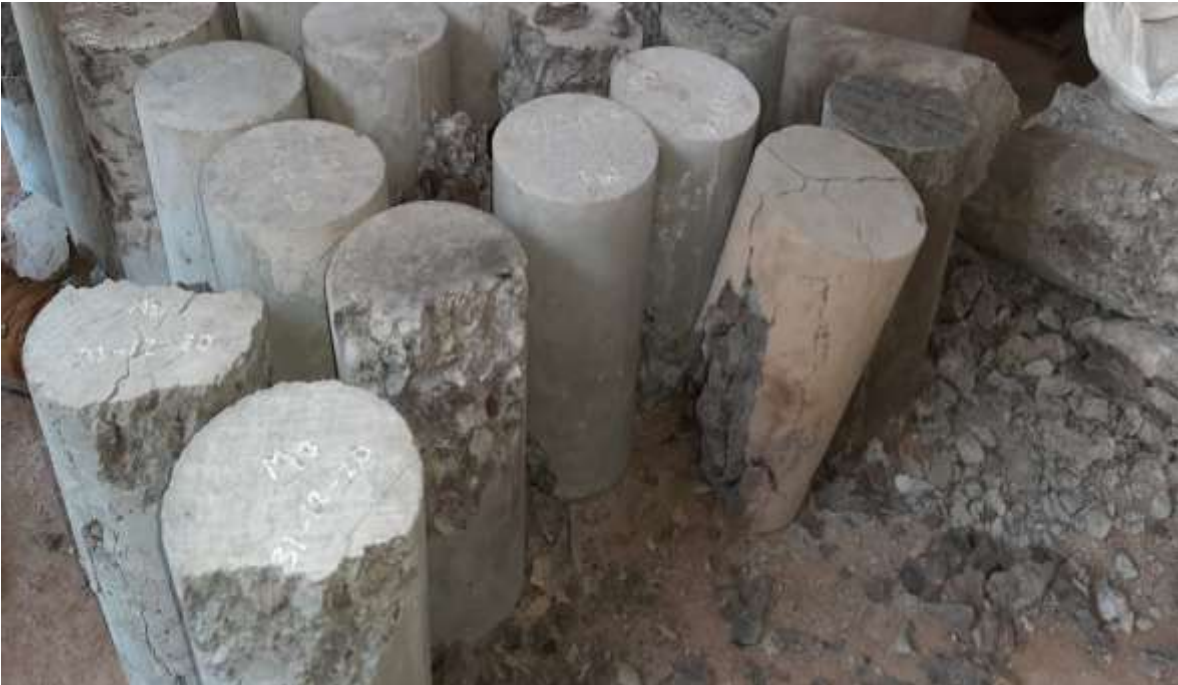
Imagen 30: La condición de las probetas, después de la prueba a compresión de las muestras M1, M2 y M3 en laboratorio.
