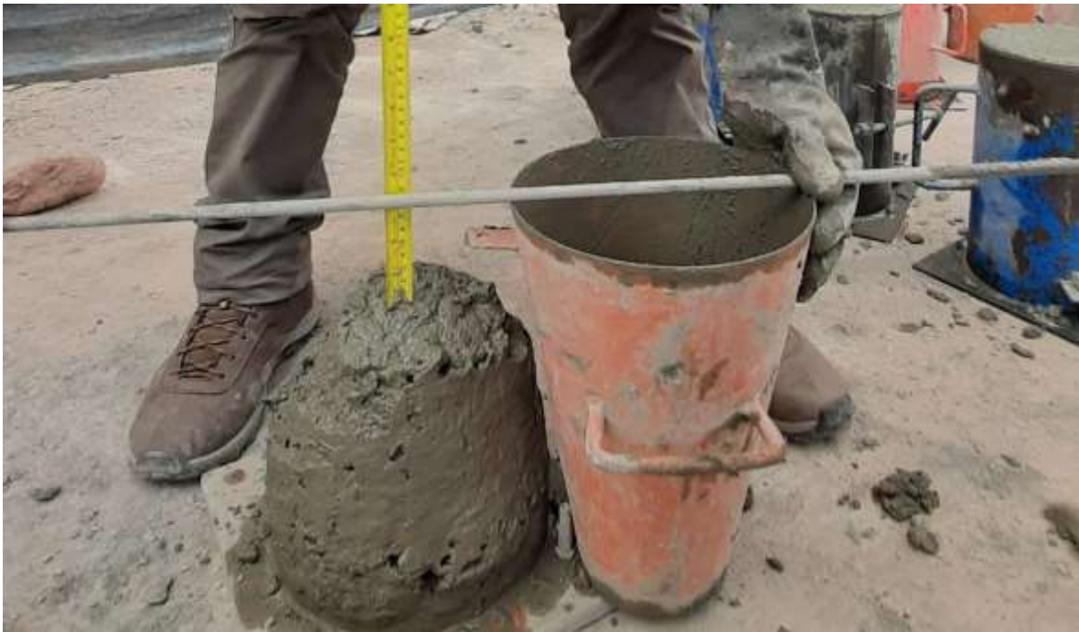
Imagen 13: Determinación del asentamiento de la mezcla en estado fresco Propiedades físicas del concreto patron sin aditivo.
