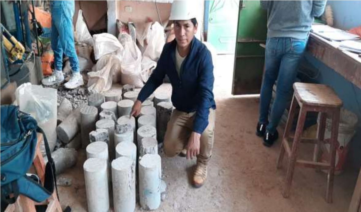
Imagen 29: La condición de las probetas, después de la prueba a compresión de las muestras M1, M2 y M3 en laboratorio.
