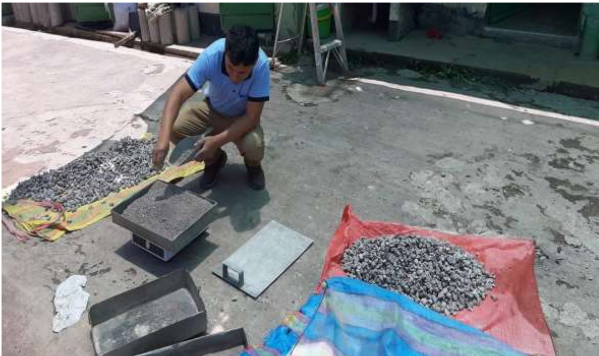
Imagen 04: Caracterización de la granulometría de arena gruesa y piedra chancada en laboratorio.
