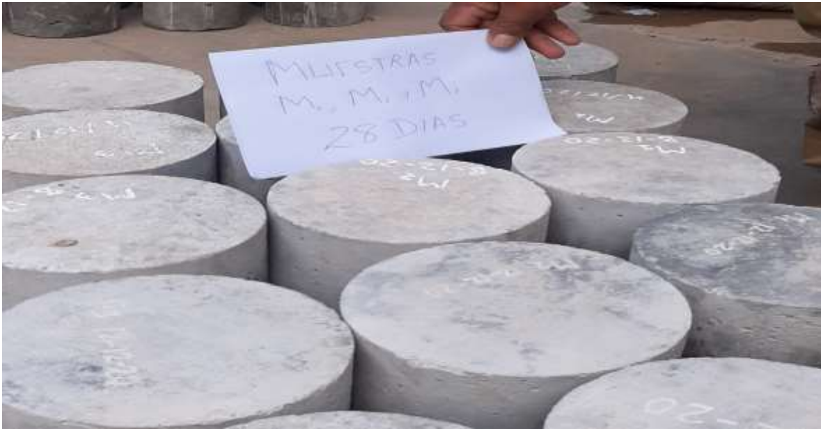
Imagen 23: Re identificación de las probetas según antigüedad en laboratorio para pruebas de ensayo a la compresión.
