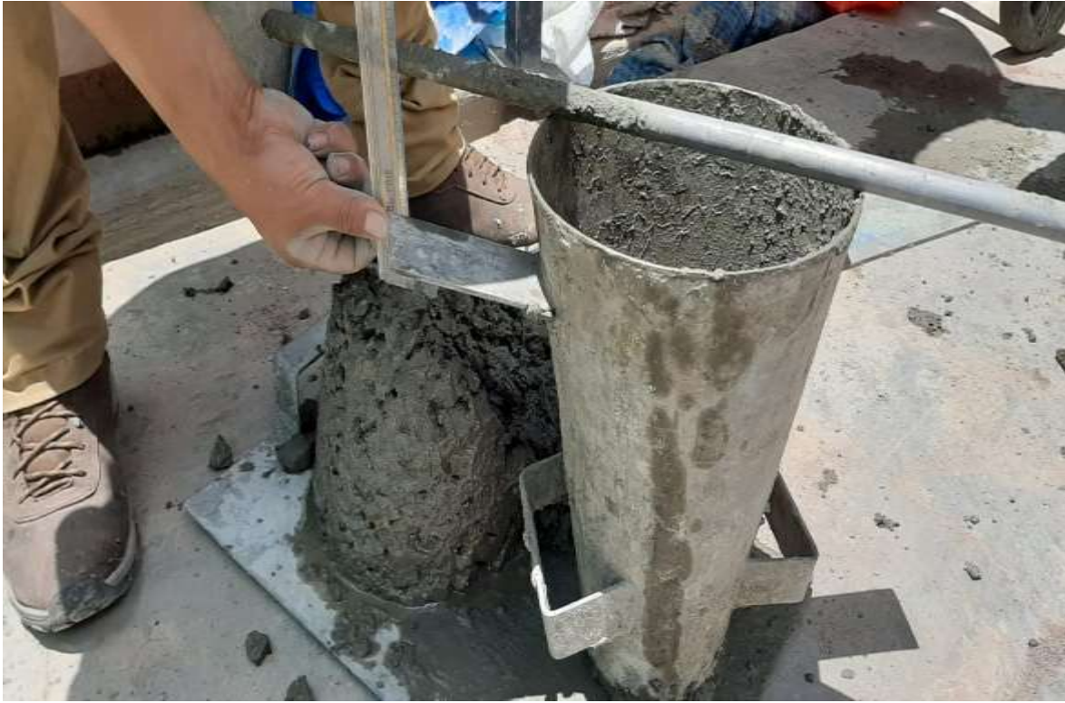
Imagen 07: Determinación de la consistencia del concreto en estado fresco en laboratorio (Slump).
