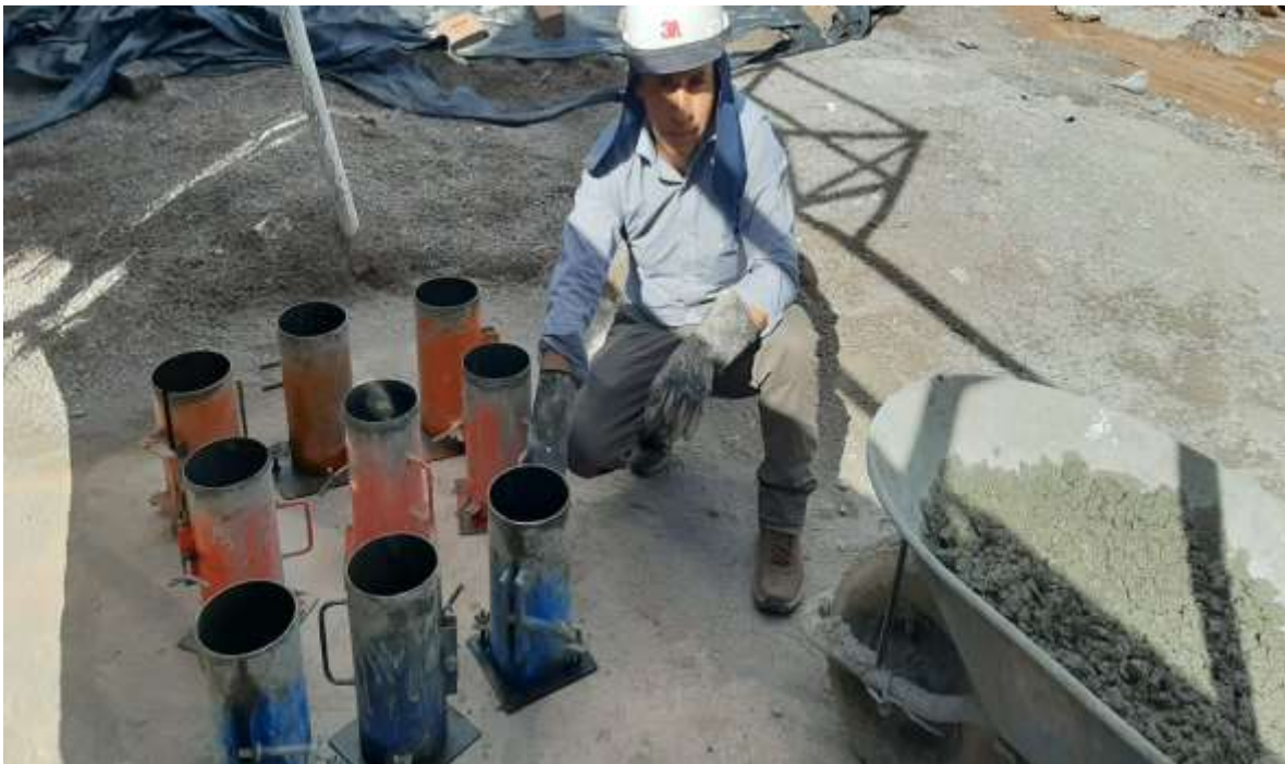
Imagen 14: El proceso de obtención de las probetas en una tanda, para muestra 1, 2 y 3 según diseño.
