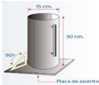
Figura N° 12: Molde cilíndrico para probetas (15cm x 30cm)
