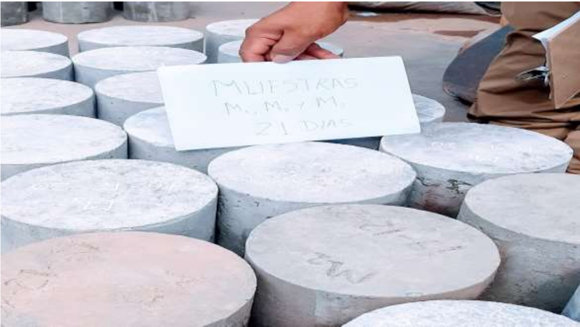
Imagen 22: Re identificación de las probetas según antigüedad en laboratorio para pruebas de ensayo a la compresión.
