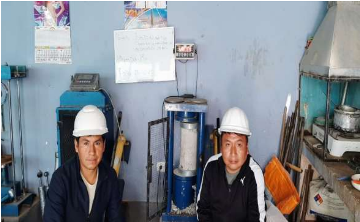
Imagen 24: Ensayos de compresión de la probetas M3 a los 03 días de antigüedad, en laboratorio.
