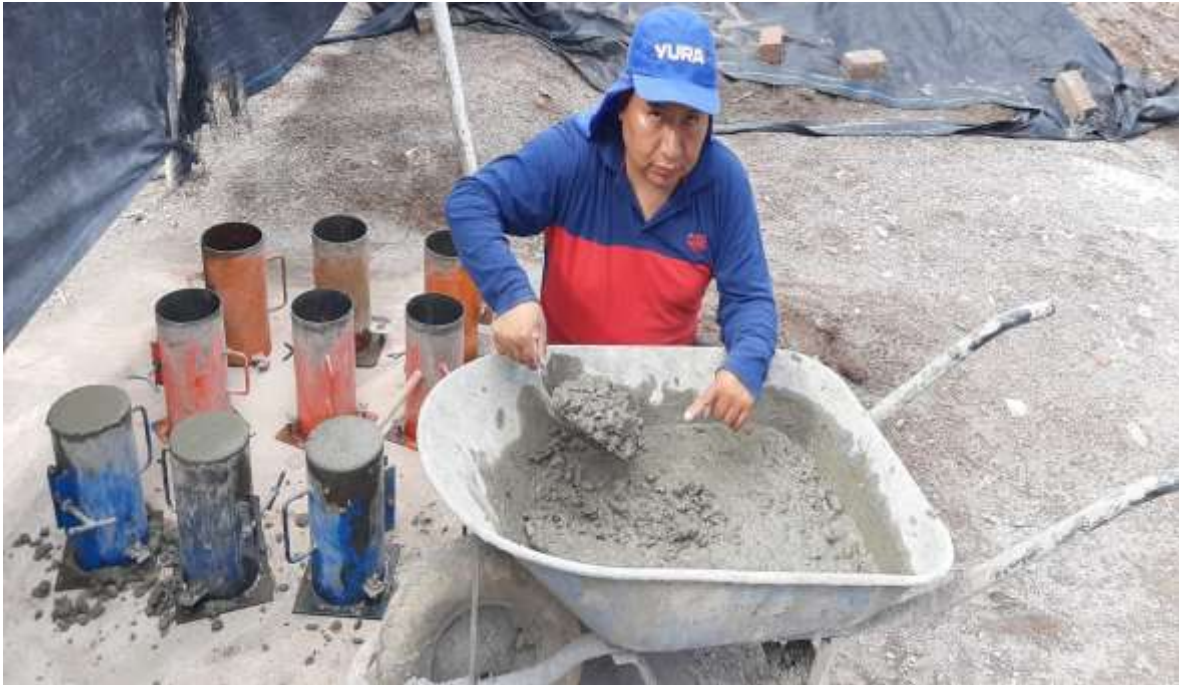
Imagen 15: Proceso de obtención de las probetas según el diseño de mezcla. Propiedades físicas del concreto con la incorporación de aditivo Chema Plast.
