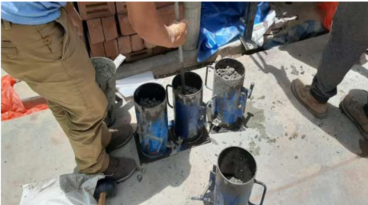
Imagen 08: Procedimiento con la obtención de las probetas de concreto en el laboratorio.
