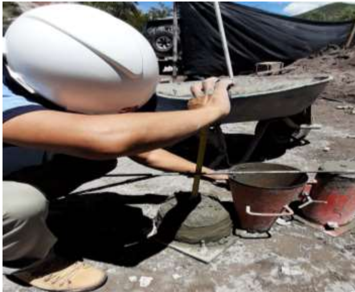
Figura N° 32: Slump de concreto F'c=210 kg/cm 2 con aditivo, muestra M3.
