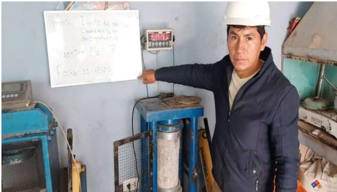
Imagen 25: Ensayos de compresión de la probetas M2 a los 07 días de antigüedad, en laboratorio.
