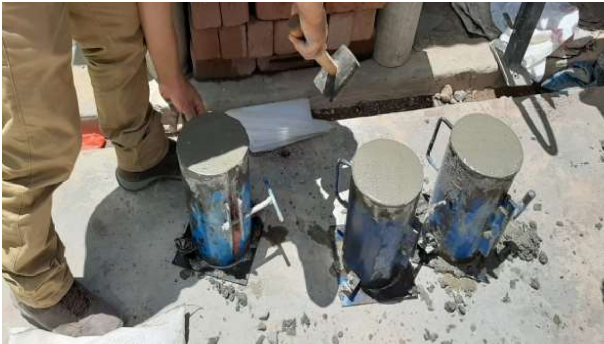
Imagen 09: Procedimiento con la obtención de las probetas de concreto en el laboratorio.
