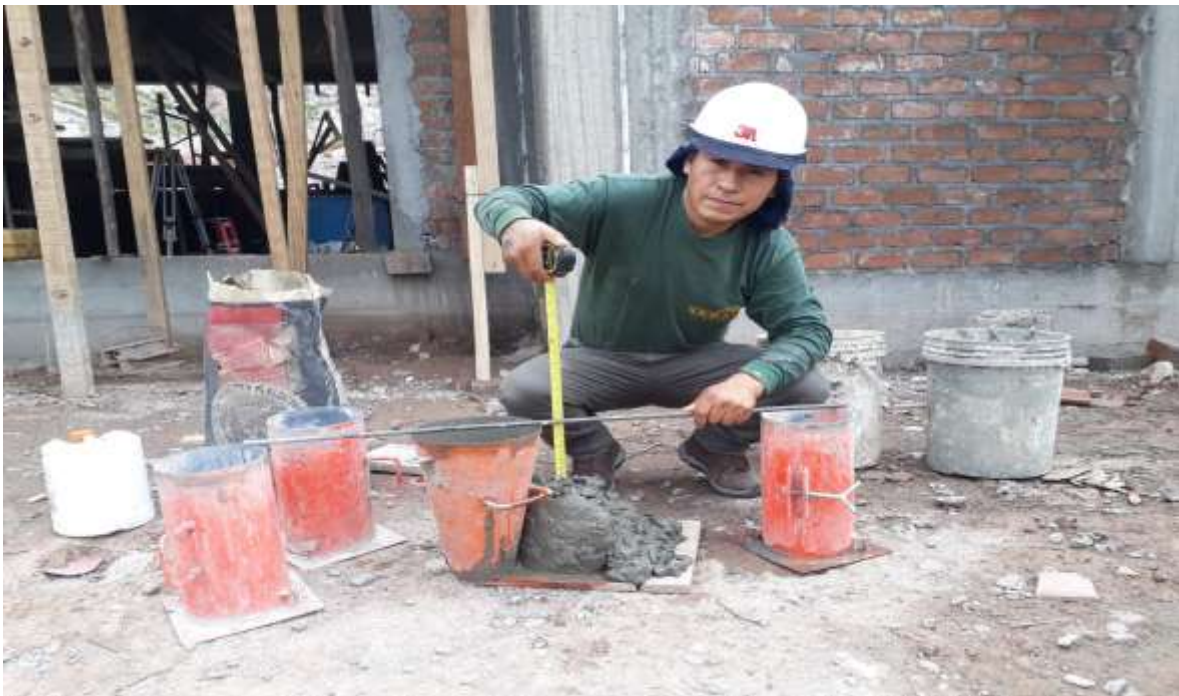
Imagen 16: Determinación del asentamiento de la mezcla en estado fresco Propiedades físicas del concreto con aditivo Chema Plast.
