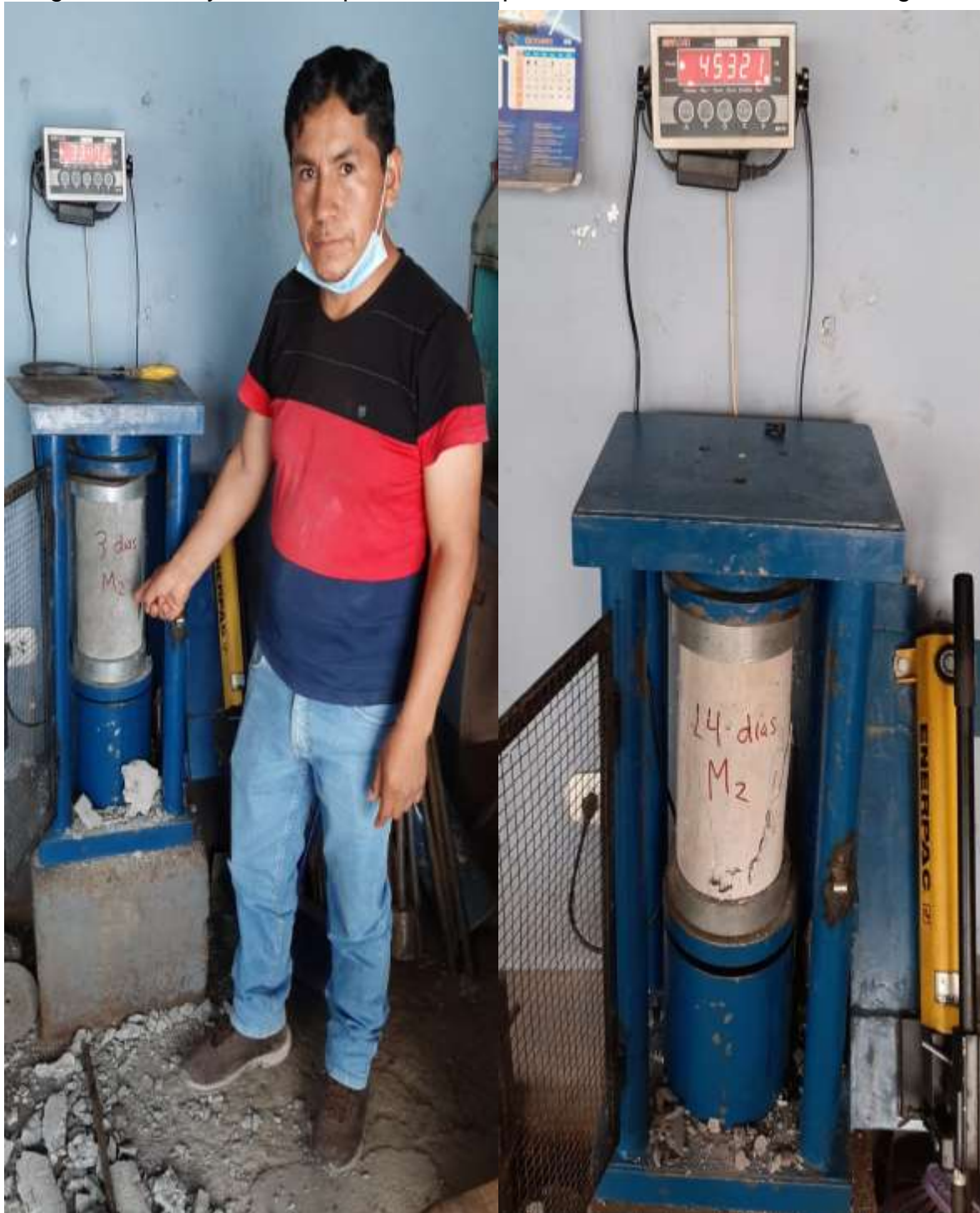
Imagen 27: Ensayos de compresión de la probetas M2 a los 14 días de antigüedad
