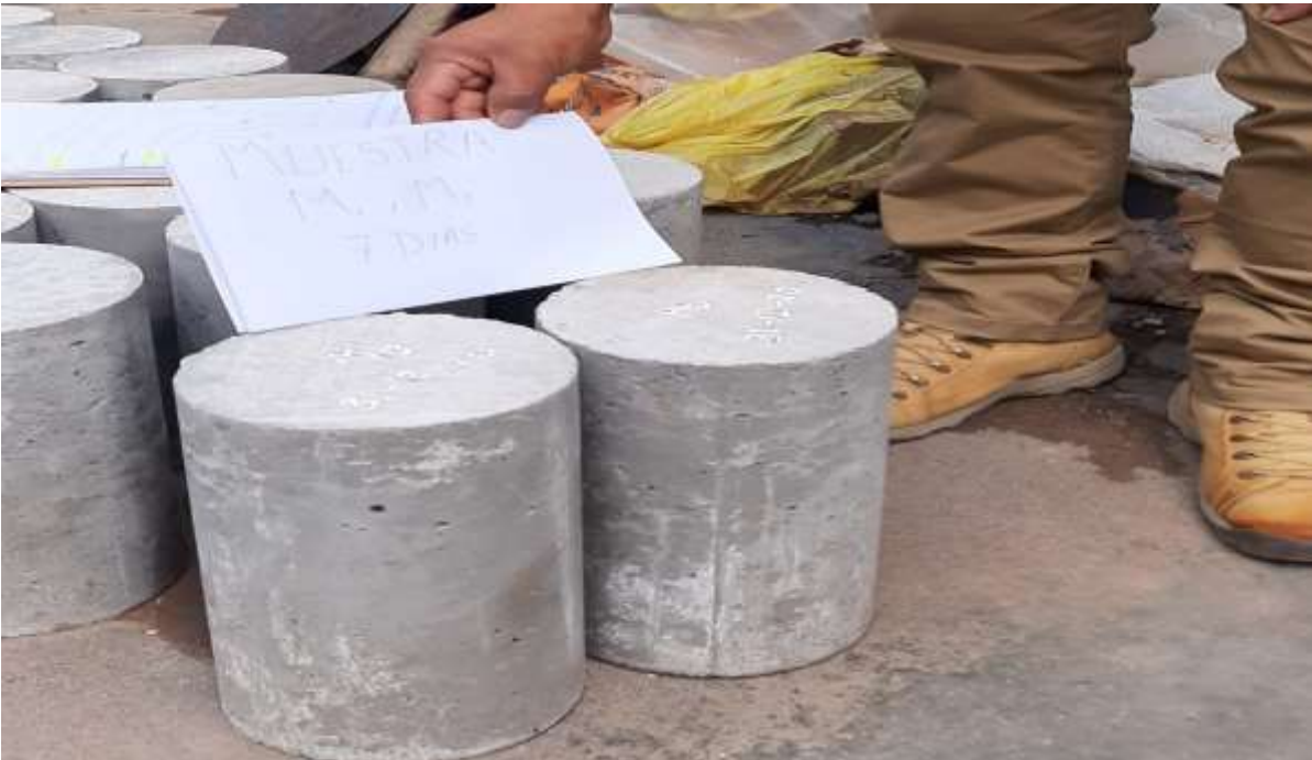
Imagen 20: Re identificación de las probetas según antigüedad en laboratorio para pruebas de ensayo a la compresión.
