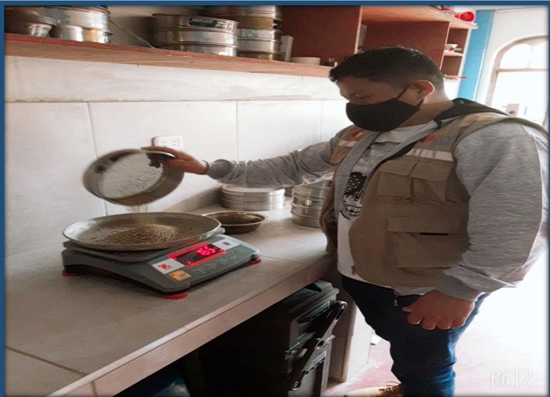
Imagen N° 4: Tamizado de Material Escoria Negra
