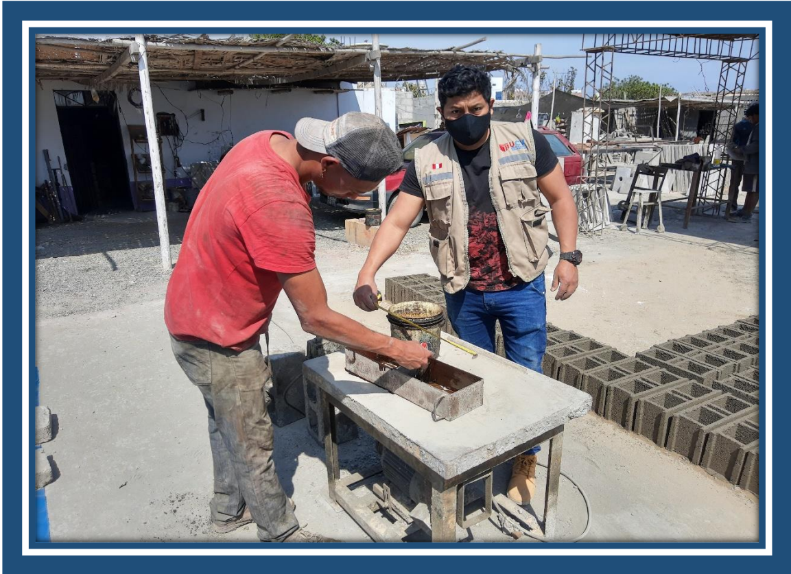
Imagen N° 13: Medición del molde de ladrillo de 14 x 13 x 9.
