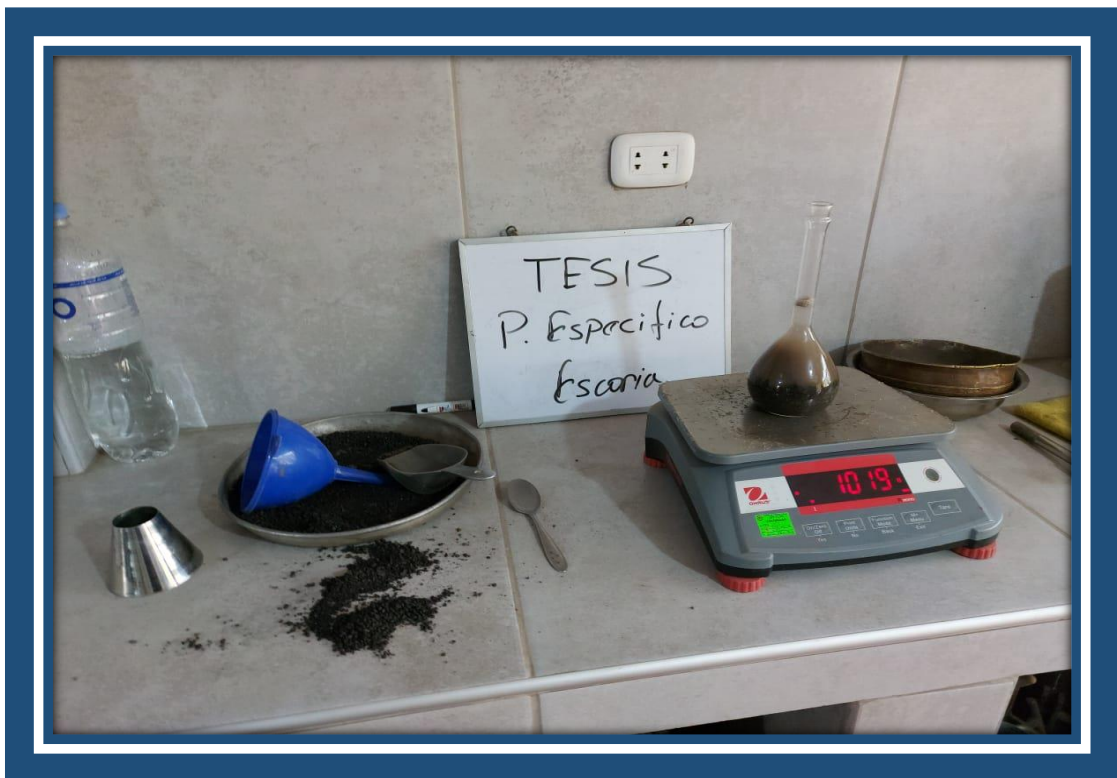
Imagen N° 9: Peso Específico de la Escoria negra al remplazar el Agregado Fino.
