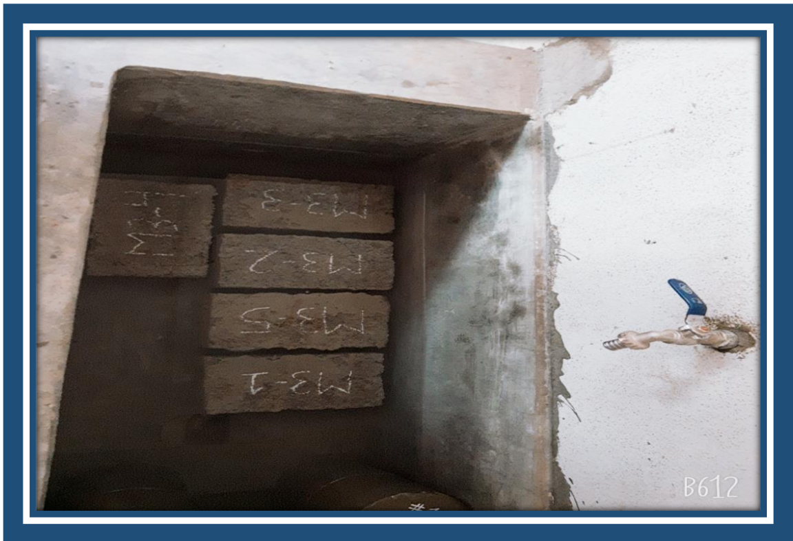
Imagen N° 21: Ladrillos a los 28 días de Absorción para ser Retirados.
