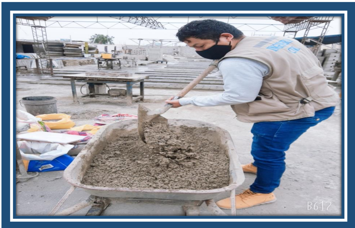
Imagen N° 12: Preparación de la mezcla en la ladrillera “Vargas” para elaboración de los ladrillos.
