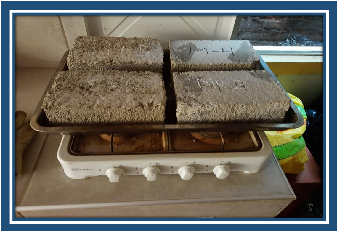
Imagen N° 23: Secado del Ladrillo en el Horno.
