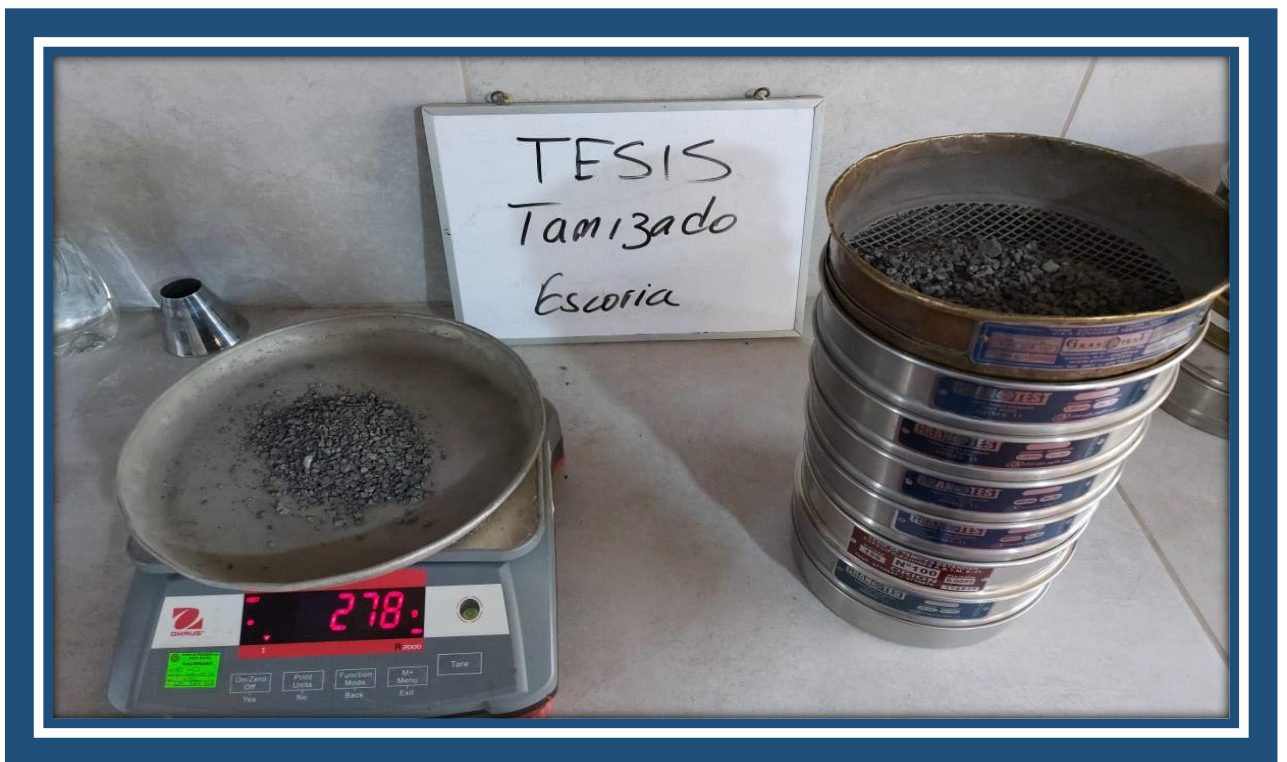
Imagen N° 5: Tamizado y Peso de cada Tamiz de la Escoria negra
