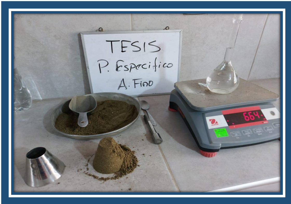
Imagen N° 8: Peso específico de Agregado Fino con la fiola
