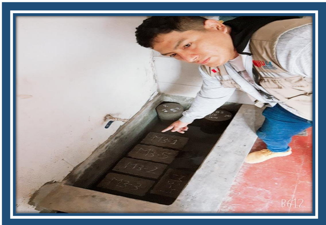
Imagen N°20: Colocación de Ladrillos para el Ensayo de Absorción
