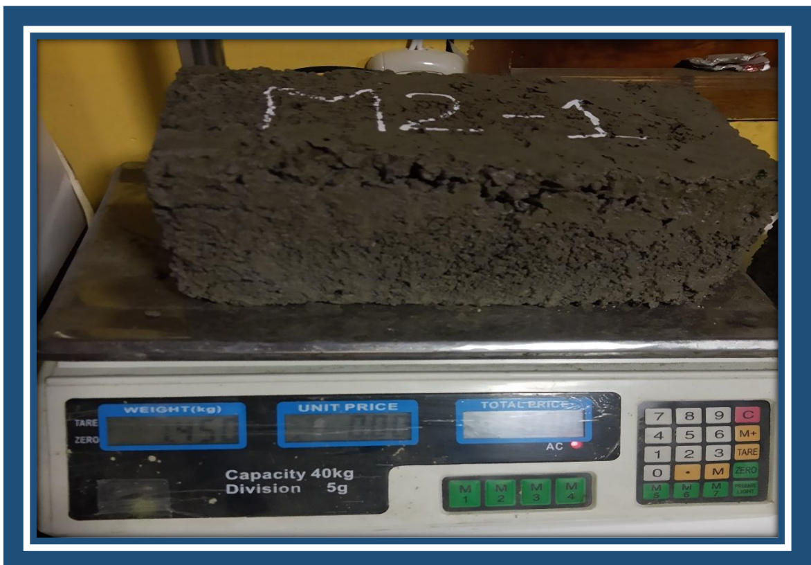
Imagen N° 22: Peso de Absorción del Ladrillo con 35% de Escoria.
