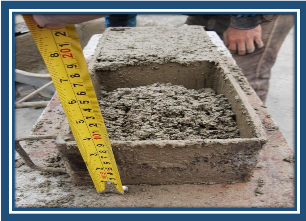
Imagen N° 15: Vaciado de la primera capa en el molde para su vibración.
