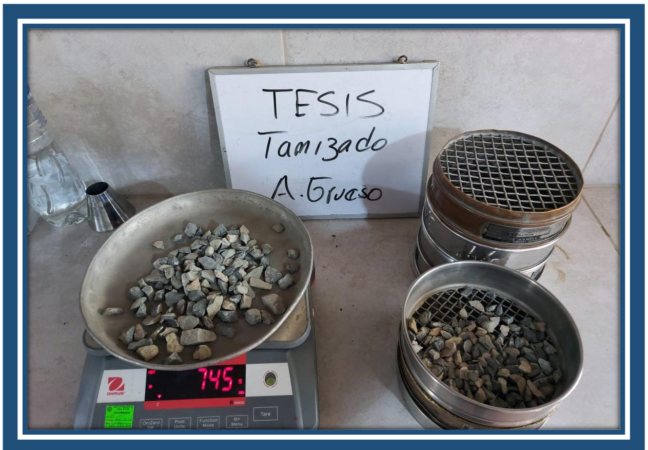
Imagen N° 6: Tamizado y Peso de cada Tamiz del Agregado Grueso
