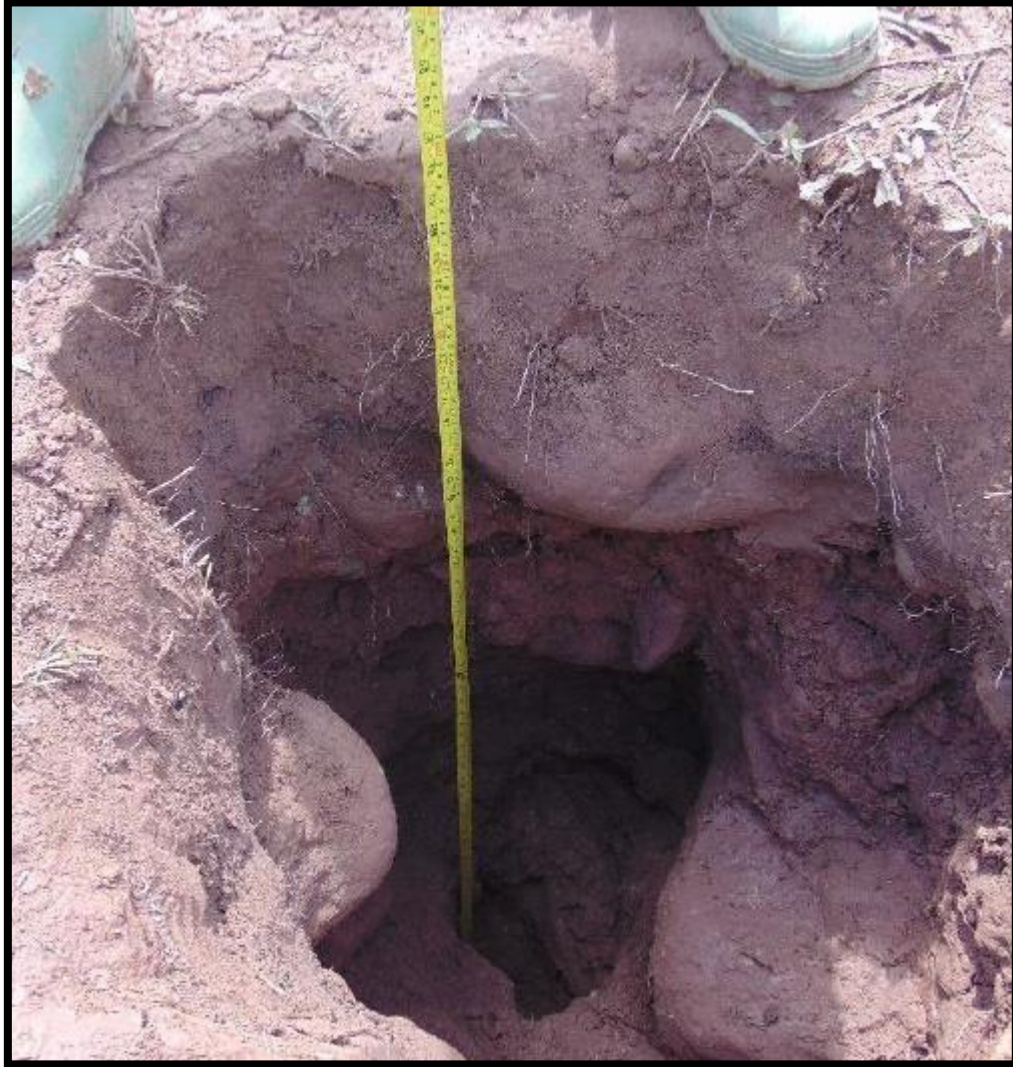
Profundidad de la calicata (C-1) para el estudio de suelo.
