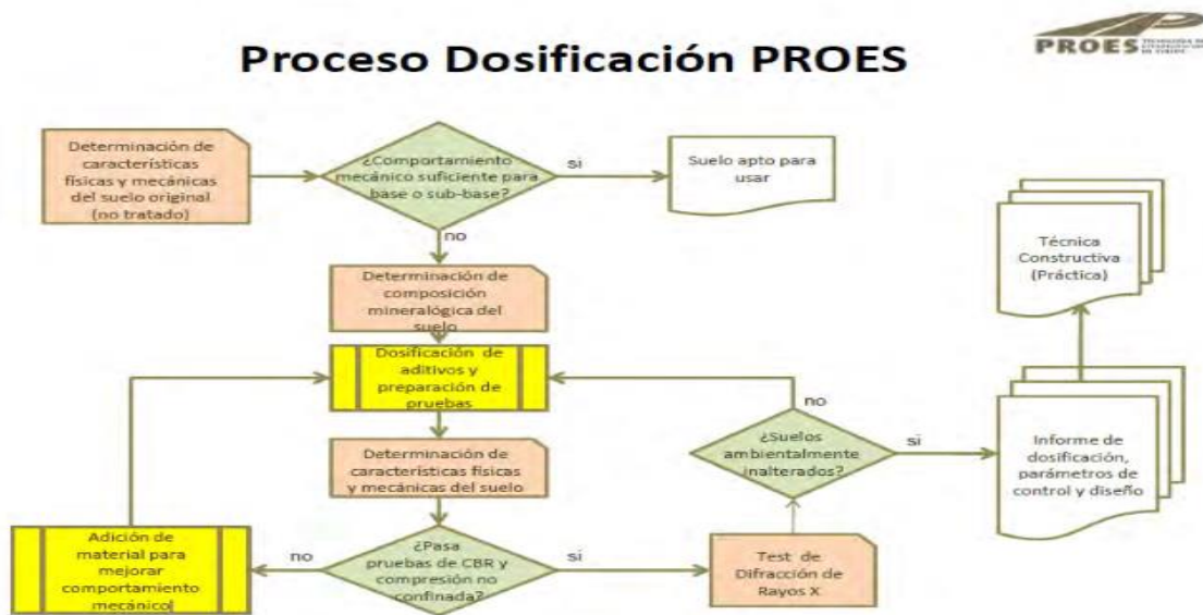
Figura 3: Esquema del proceso de dosificación de una base con tecnología Proes.
