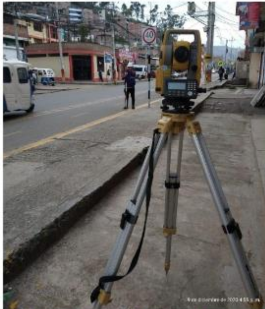
Fotografía N°2: Se puede apreciar el levantamiento topográfico realizándose en la cuarta cuadra de la avenida Perú.
