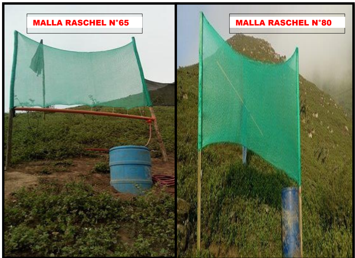
Imagen N° 6 Malla Raschel N°65 y N°80 en funcionamiento
