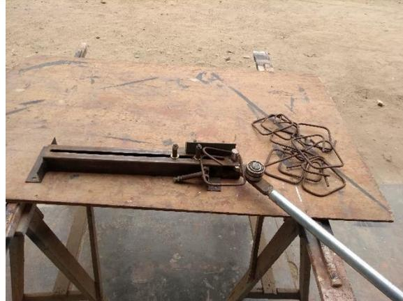
**Imagen 2.** Doblado de estribos de acero, con máquina dobladora de estribos
