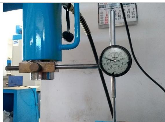
**Figura 29.** Deformímetro, utilizado para la medición de deflexiones en ensayo a flexión
