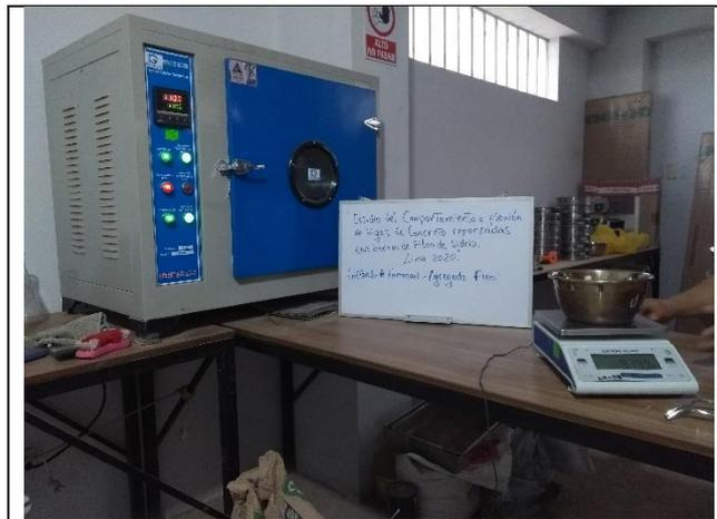
**Figura 16.** Contenido de humedad del agregado fino
