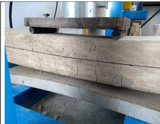
**Figura 25.** Agrietamiento en vigas de concreto reforzado de acero patrón 1
