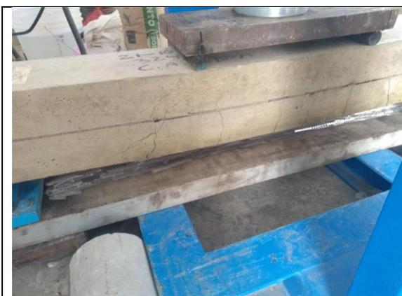
**Figura 28.** Caracterización de fallas en las fibras a tensión de la viga
