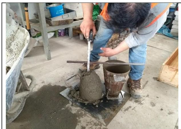
**Figura 21.** Determinación SLUMP del diseño de mezcla  $F'c=210 \text{ kg/cm}^2$
