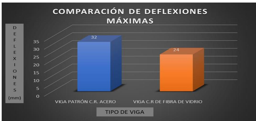
**Gráfico 7.** Comparación de deflexiones desarrolladas en vigas de concreto reforzadas con varillas de acero vs. vigas de concreto reforzadas con barras de fibra de vidrio
