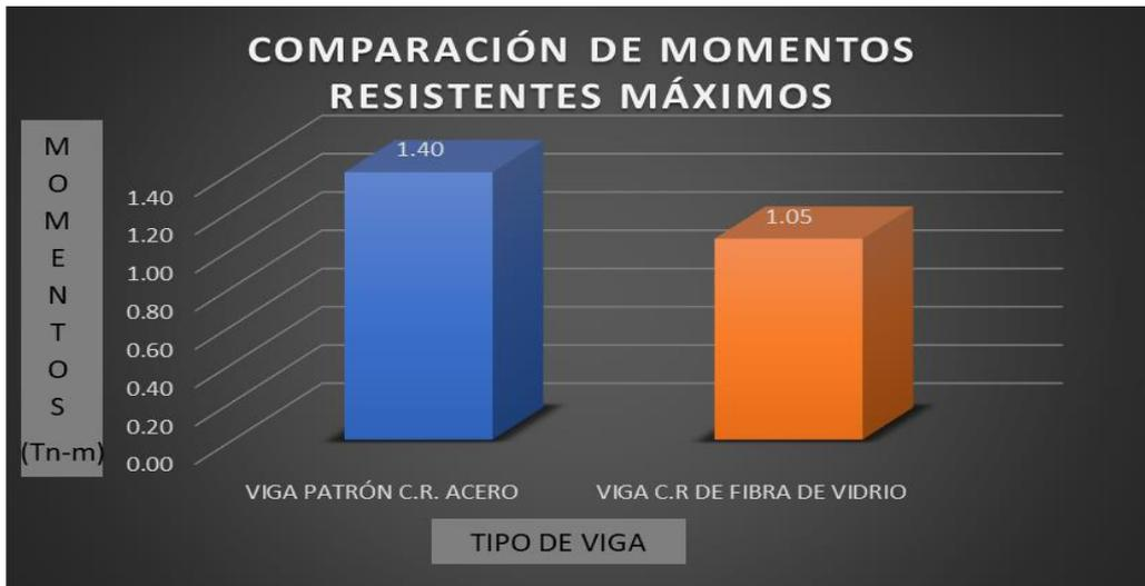
**Gráfico 6.** Comparación de momentos resistente de viga de concreto reforzado con varillas de acero vs. viga de concreto reforzado con barras de fibra de vidrio
