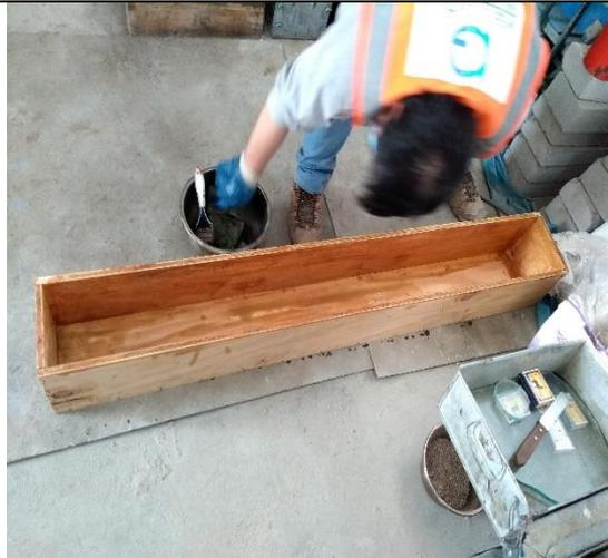
**Imagen 17.** Aceitado previo de los moldes de viga, para su próximo llenado de mezcla de concreto
