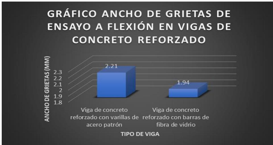
**Gráfico 8.** Gráfico ancho de grietas de ensayo a flexión en vigas de concreto reforzado con varillas de acero patrón vs. vigas de concreto reforzado con barras de fibra de vidrio
