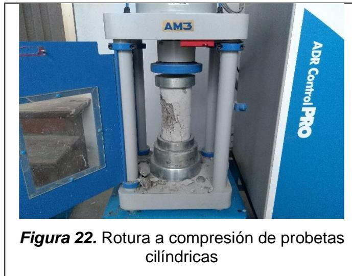
**Figura 22.** Rotura a compresión de probetas cilíndricas
