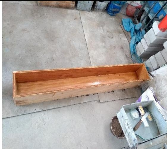
**Imagen 18.** Aceitado terminado de molde de viga
