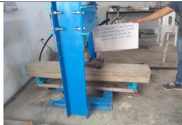
**Imagen 27.** Ensayo a flexión en viga de concreto reforzado de acero patrón 2
