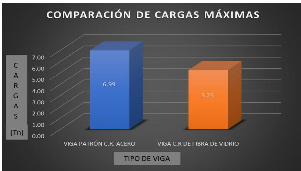
**Gráfico 1.** Comparación de cargas máximas, obtenidos de ensayos a flexión
