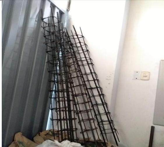
**Imagen 12.** Entrega de armaduras de acero y fibra de vidrio a las instalaciones del laboratorio
