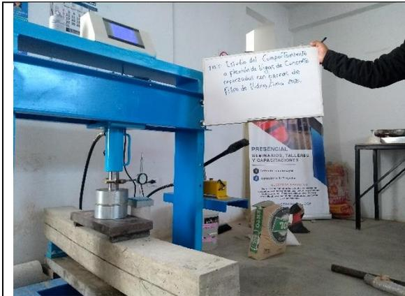
**Imagen 30.** Agrietamiento en viga de concreto reforzado con barras de fibra de vidrio 2
