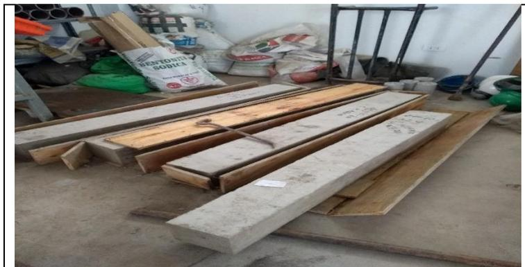
**Imagen 23.** Desencofrado de vigas, a los 28 días de curado
