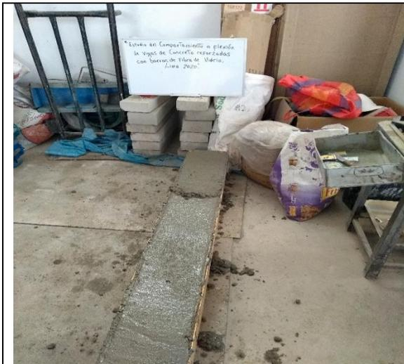
**Imagen 21.** Primera viga finalizado, previo llenado de concreto e incorporación de armadura de acero
