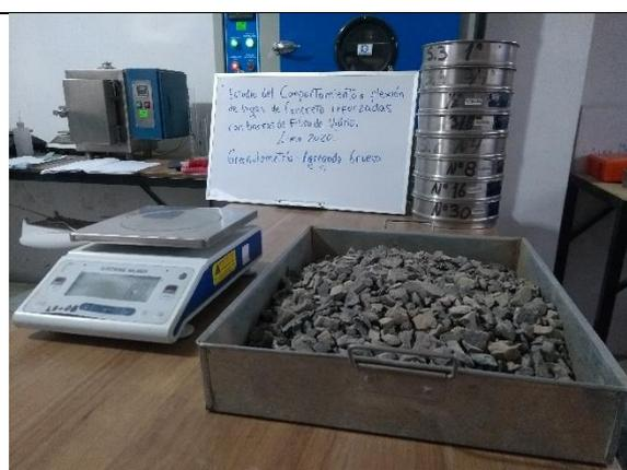
**Figura 15.** Granulometría del agregado grueso
