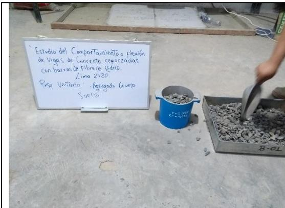
**Figura 17.** Peso unitario del agregado grueso suelto
