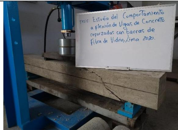
**Imagen 31.** Ensayo a flexión de vigas de concreto reforzado con barras de fibra de vidrio 2
