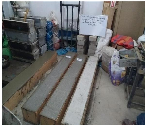
**Imagen 22.** Total, de vigas finalizados, previo llenado de concreto e incorporación de armaduras
