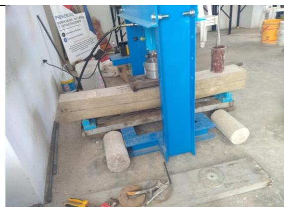
**Imagen 29.** Ensayo a flexión en viga de concreto reforzado con barras de fibra de vidrio 1
