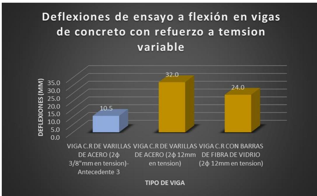
**Gráfico 11.** Gráfico de deflexiones obtenidas durante ensayo a flexión en vigas de concreto con refuerzo a tensión variable
