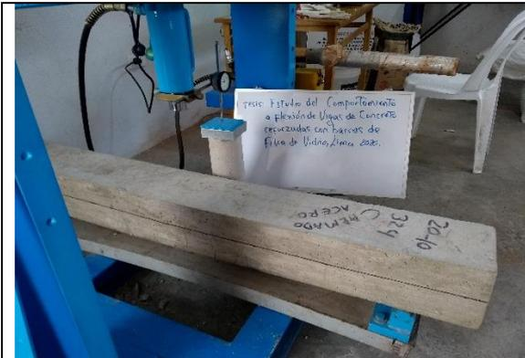
**Figura 23.** Ensayo a flexión en vigas de concreto reforzados
