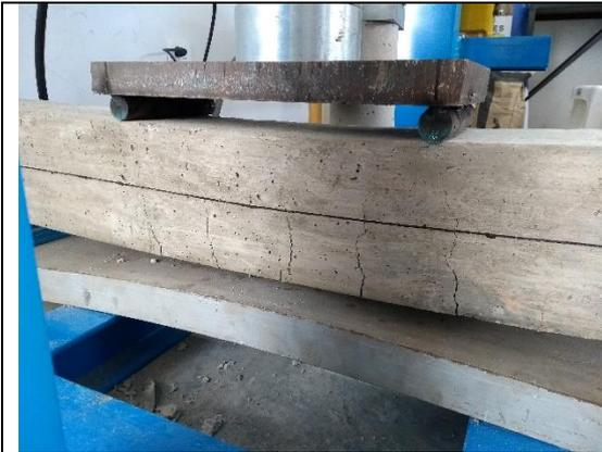
**Imagen 24.** Agrietamiento en vigas de concreto reforzado de acero patrón 1
