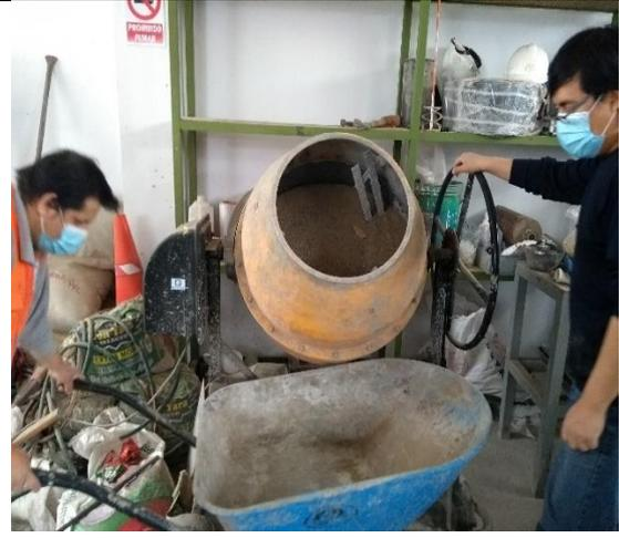
**Imagen 15.** Incorporación de agregados al equipo de mezcla de concreto
