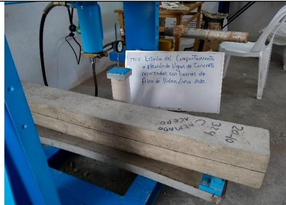
**Imagen 25.** Ensayo a flexión en viga de concreto reforzado de acero patrón 1
