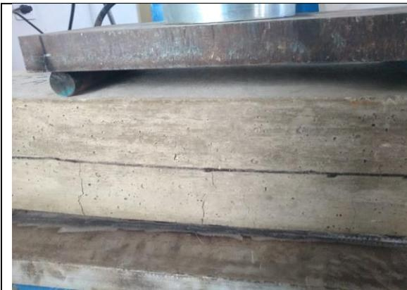
**Imagen 26.** Agrietamiento en viga de concreto reforzado de acero patrón 2
