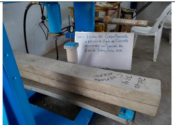
**Figura 26.** Ensayo a flexión en de concreto reforzado de acero patrón 1, para la determinación de momentos
