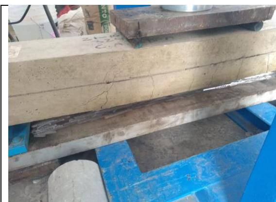
**Imagen 28.** Agrietamiento en viga de concreto reforzado con barras de fibra de vidrio 1
