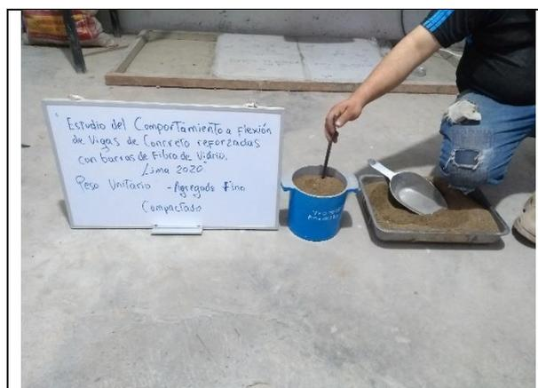
**Figura 19.** Peso unitario del agregado fino compactado
