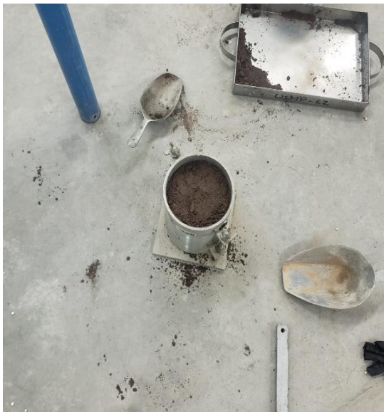
Fotografía 18. Para el CBR se inicia con la compactación de 3 muestras para la segunda parte consta de la penetración de cada muestra mediante un pistón de la prensa de CBR.
