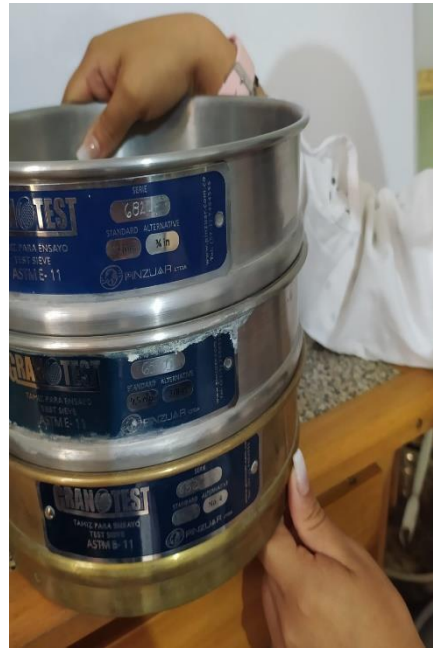
Fotografía 7. Ensayo de granulometría, se ordena de forma secuencial los tamices para proceder a pasar la muestra por los tamices.
