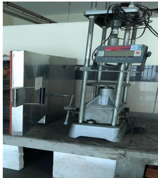
Fotografía 18. Para el CBR se inicia con la compactación de 3 muestras para la segunda parte consta de la penetración de cada muestra mediante un pistón de la prensa de CBR.
