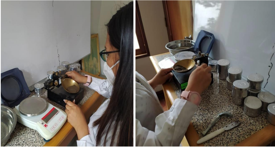
Fotografía 11. Para el límite líquido a la muestra húmeda se aplicó la Copa de Casagrande, por medio del número de golpes.
