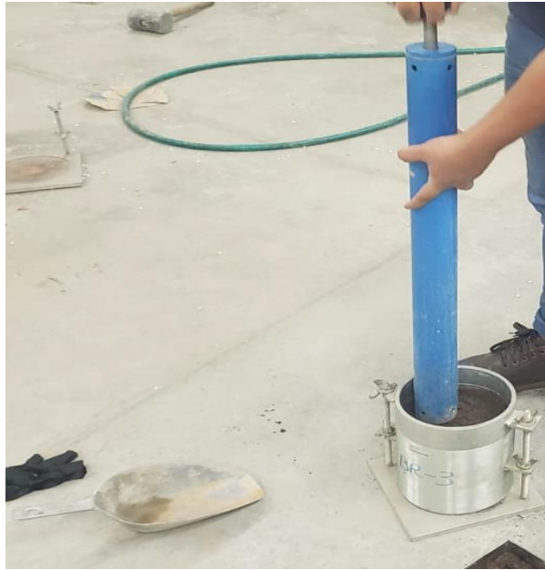
Fotografía 17. Con un pistón procedemos a dar golpes por cada capa.
