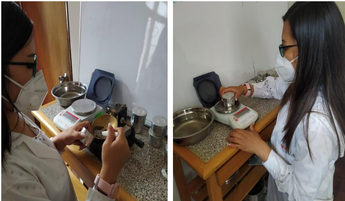
Fotografía 12. Después de cerrar la muestra por medio de la Copa de Casagrande se procede a pesar.
