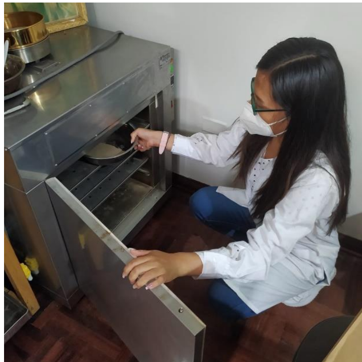
Fotografía 10. La muestra se introduce al horno durante 24 horas a \pm 110 °C.
