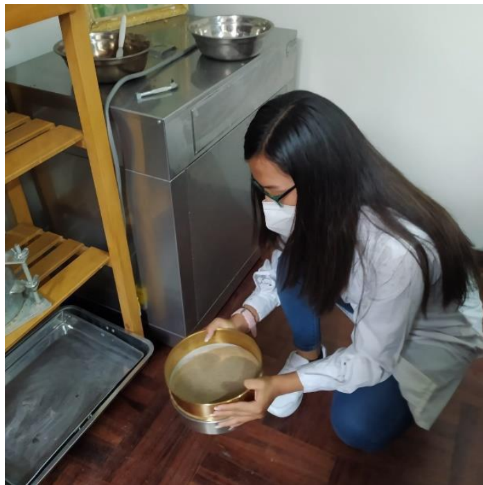
Fotografía 8. Consiste en mover de un lado a otro para luego pesar % que pasar el material retenido en cada tamiz.
