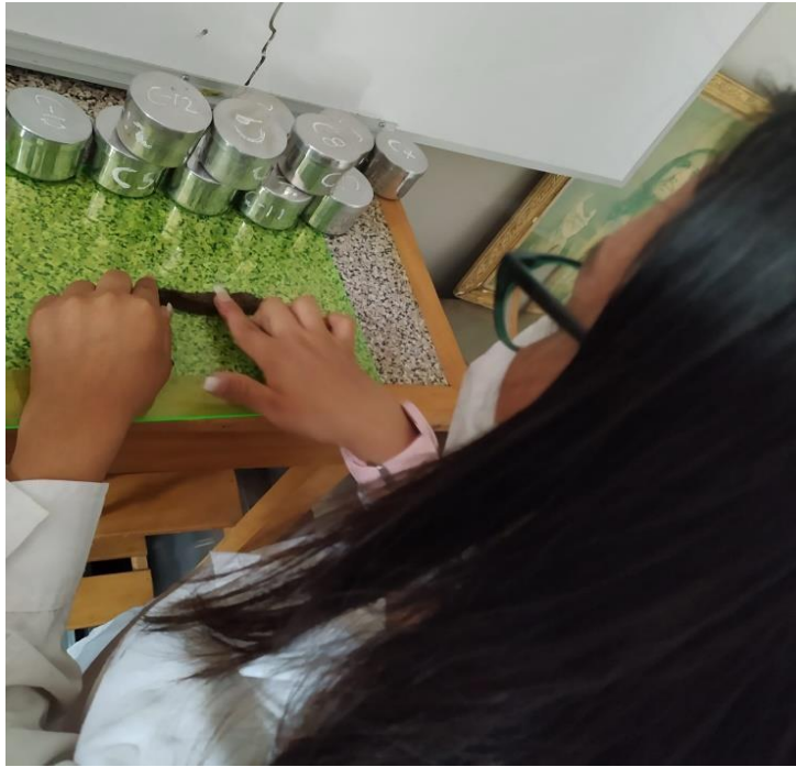
Fotografía 13. Para el límite plástico, se forma con la palma de la mano cilindros de 3mm de diámetro.
