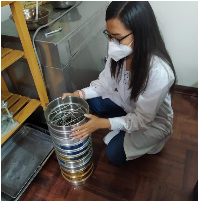
Fotografía 7. Ensayo de granulometría, se ordena de forma secuencial los tamices para proceder a pasar la muestra por los tamices.
