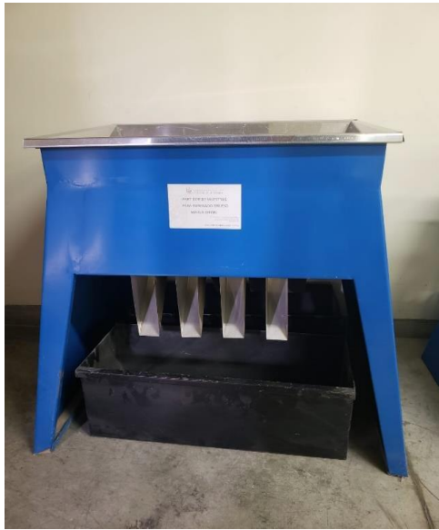
Fotografía 9. Para el ensayo de contenido de humedad se pasó a cuartear el suelo traído de campo para luego pesar cada muestra cuarteadada (peso húmedo).
