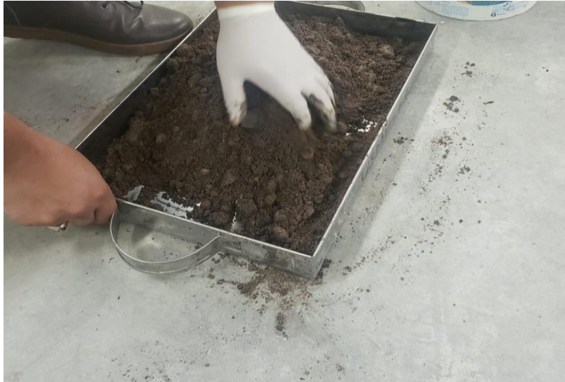
Fotografía 15. Para el ensayo de Proctor Modificado método A , se escogió cada muestra de 3kg.
