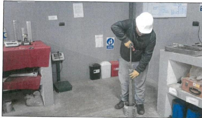
15.3. Vista de ensayo de proctor modificado.
