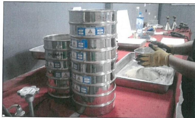
15.2. Vista de análisis granulométrico por tamizado.
