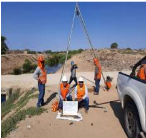
figura 18. 10. vista general del SPT, con la primera muestra extraída.
