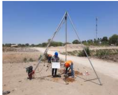
figura 18. 7. muestras extraídas, mediante el tubo, aplicando golpes con la pesa
