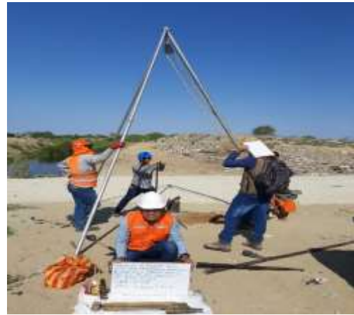
figura 18. 5. vista general estudio SPT
