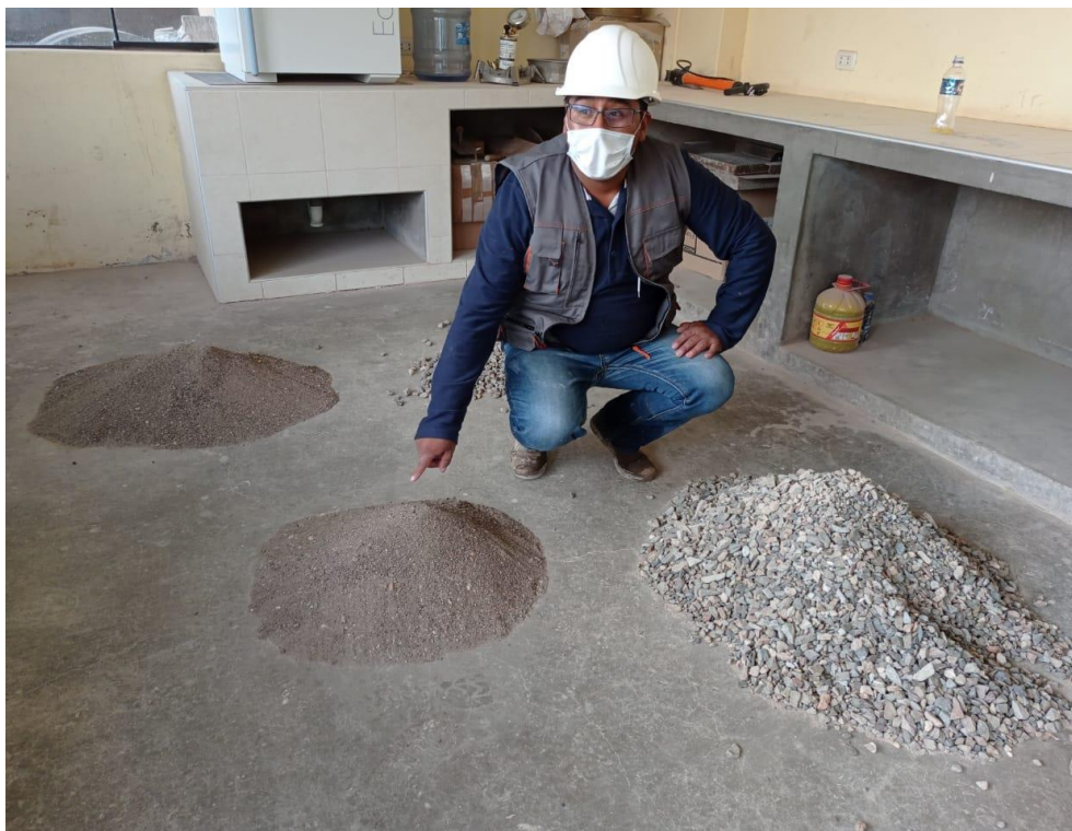
Figura 2. Agregado fino y grueso.
