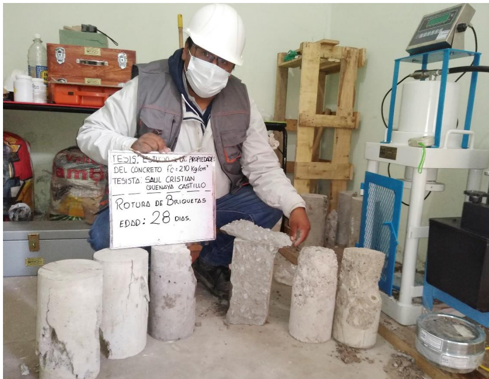
Figura 11. Ensayo a compresión de probetas
