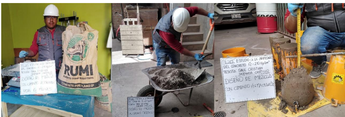
Figura 8: Ensayo del concreto con cemento almacenado.
