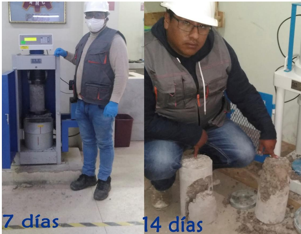
Figura 11. Ensayo a compresión de probetas
