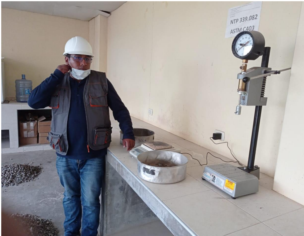
Figura 1. penetrómetro para concretos para el tiempo de fragua.
