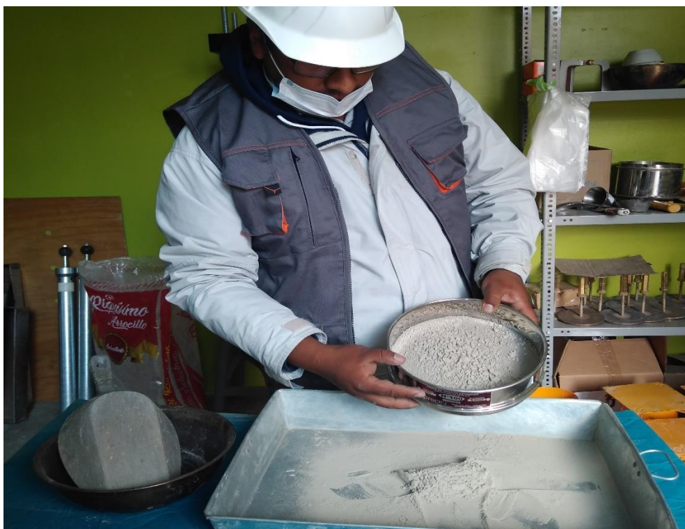
Figura 8. Eliminación de grumos tamizado en el tamiz N° 100
