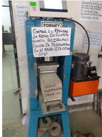
Descripción: Rotura de vigas simples en prensa hidráulica
