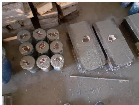
Descripción: Llenado terminado en los moldes de las probetas cilindricas y primasticas
