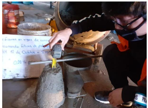
Descripción: Ensayo de asentamiento del concreto fresco por cada % asignado
