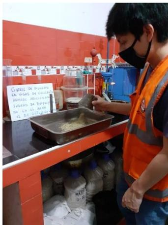
Descripción: Peso específico y absorción del agregado fino
