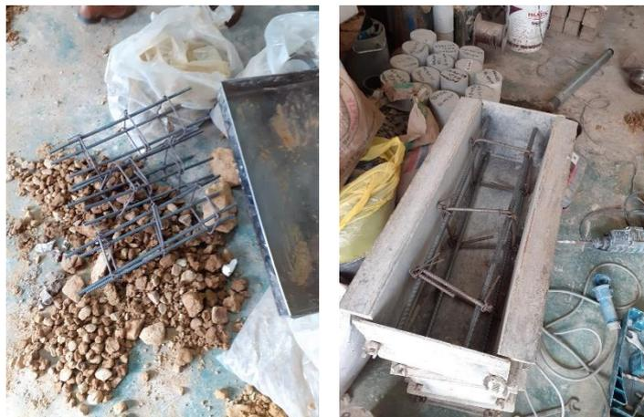
Descripción: Refuerzo longitudinal para la vigas de ensayo
