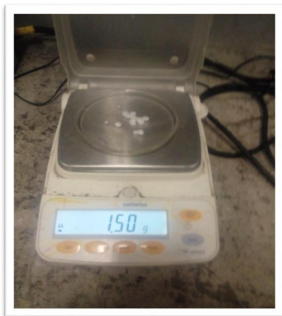
Figura C. Pesaje del catalizador (KOH)
