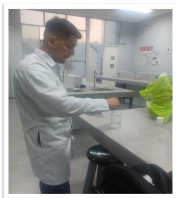
Figura C. Pesaje del catalizador (KOH)
