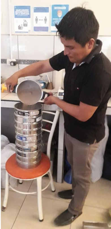
Foto 13: Trabajos de tamizado – laboratorio de suelos
