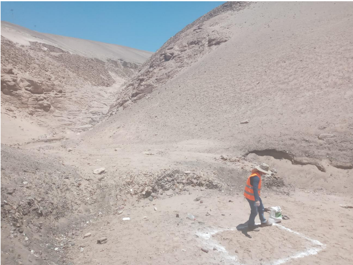
Foto 04: Trazo para ubicación de calicatas – Estudio de Suelos
