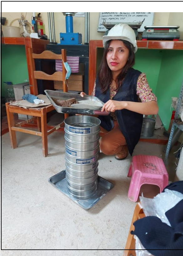
Figura 02: Se observa el tamizaje en las diferentes mallas de las muestras para el ensayo granulométrico correspondiente a las muestras de la calicata 01 y la calicata 02.
