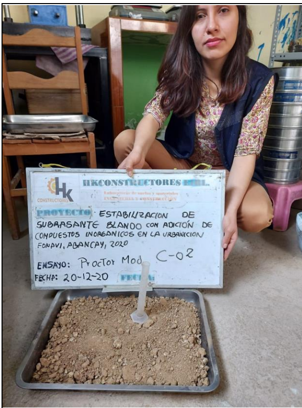
Figura 04: Se observa el ensayo para el proctor modificado, la primera etapa la mezcla con el contenido de humedad y la subdivisión en franjas equitativas en un numero de 5 , para cada capa introducida en el molde para el ensayo con numero de golpes según norma.
