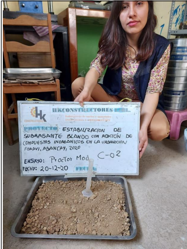
Figura 01: se observa el cuarteo realizado en cada muestra por calicata extraída para su determinado ensayo en laboratorio.
