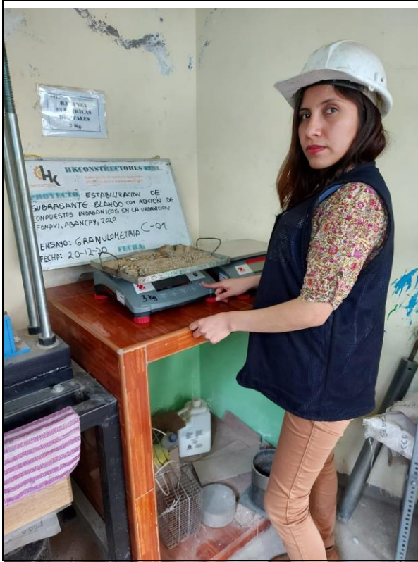
Figura 03: Se observa la masa en peso en una balanza analítica de las muestra tamizada de la calicata 01 y calicata 02 después del tamizaje realizado previamente.
