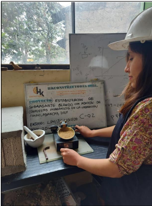
Figura 06: Se observa el ensayo de limite liquido realizado en el instrumento de Casa Grande para cada muestra de la calicata 01 y calicata 02.
