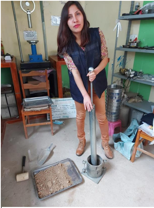
Figura 05: Se observa el ensayo de proctor modificado para las muestras de la calicata 01 y calicata 02, primera capa con 56 golpes de martillo.
