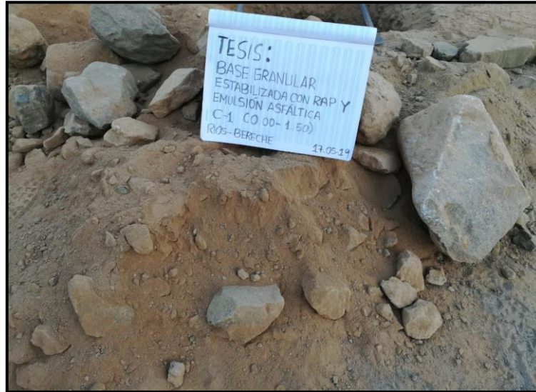
Fotografía N° 12: Extracción del quinto estrato C1
