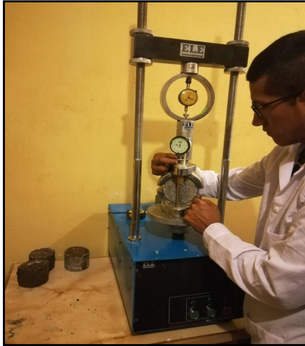
Fotografía N° 56: Rotura de briquetas con prensa Marshall
