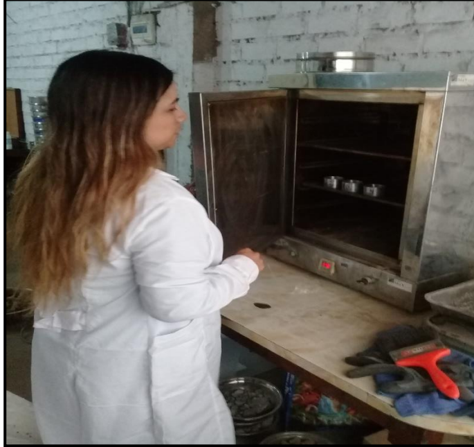
Fotografía N° 42: Calentado del rap para su disgregación
