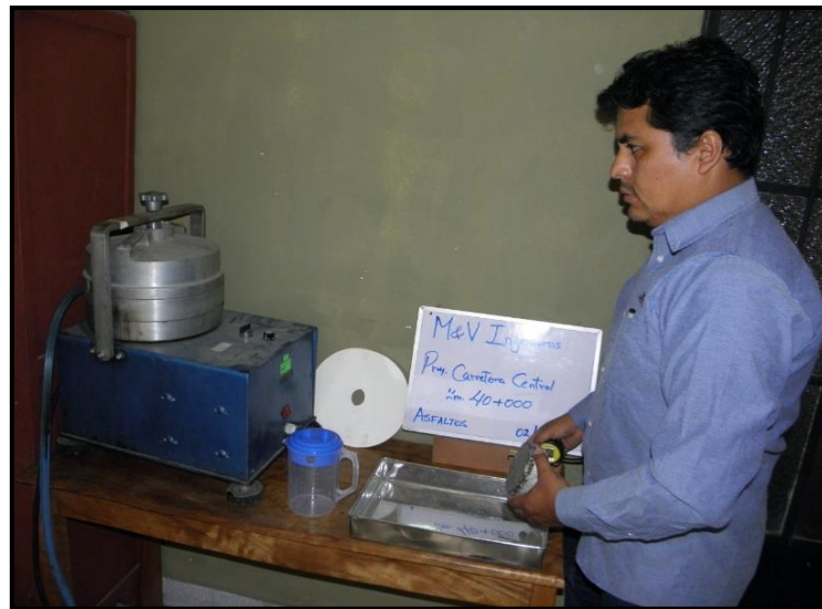
Fotografia N° 45: Control del lavado asfáltico
