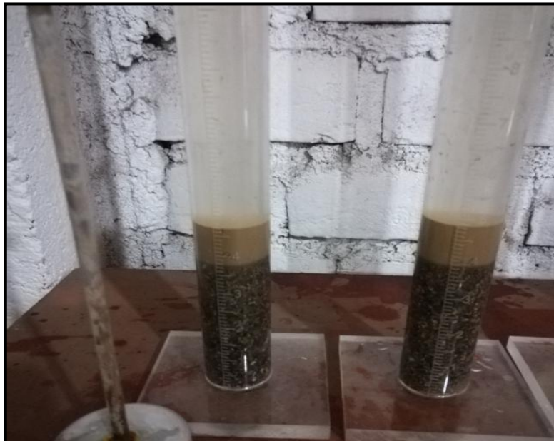
Fotografía N° 41: Asentamiento descendiente del agregado grueso
