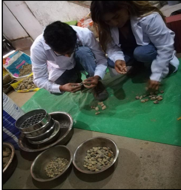
Fotografía N° 38: Determinación de caras chatas y alargadas
