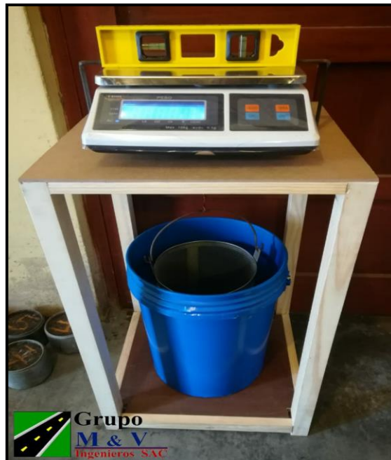
Fotografía N° 55: Ensayo peso específico de briquetas
