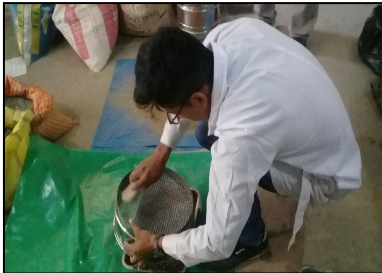
Fotografía N° 33: limpieza de agregados retenidos
