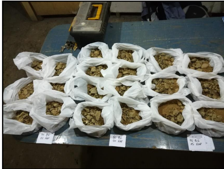
Fotografía N° 46: base granular dosificada en las 3 series de diseño
