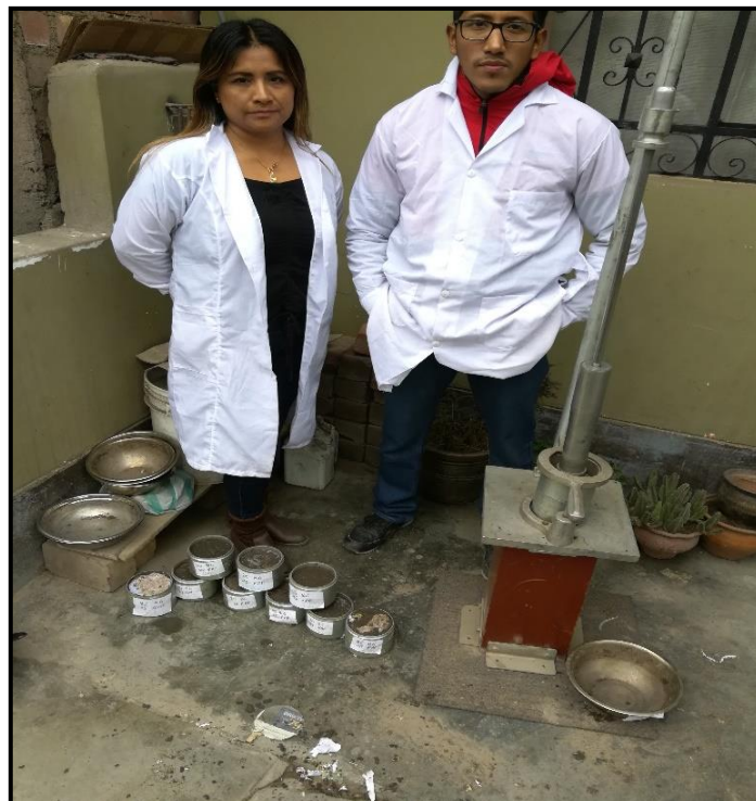
Fotografía N° 53: Briquetas terminadas por el método Marshall
