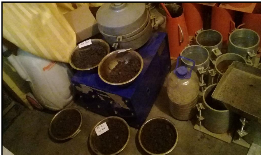
Fotografía N° 51: Muestras mezcladas para ensayo Marshall
