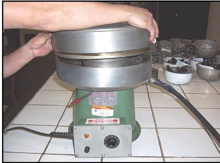
Fotografia N° 44: Ensayo de lavado asfáltico
