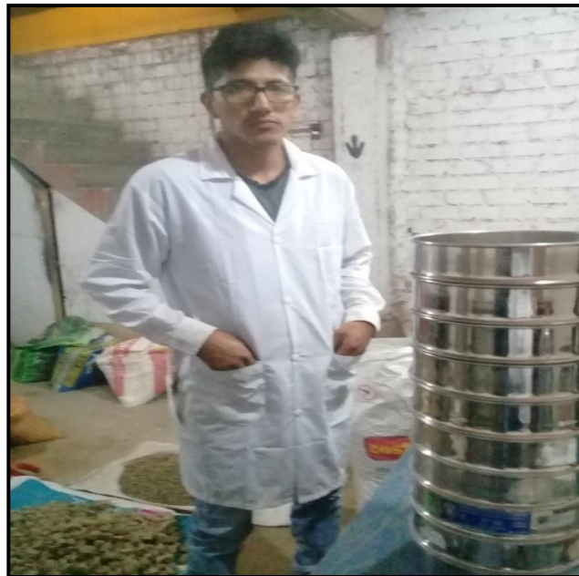
Fotografía N° 31: Ordenado de tamiz para granulometría
