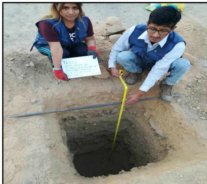
Fotografía N° 7: Medición de la profundidad calicata 1
