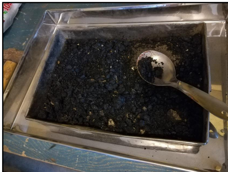
Fotografía N° 47: Reciclado asfáltico de pavimento disgregado
