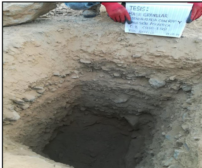
Fotografía N° 21: Excavación completa de calicata 2
