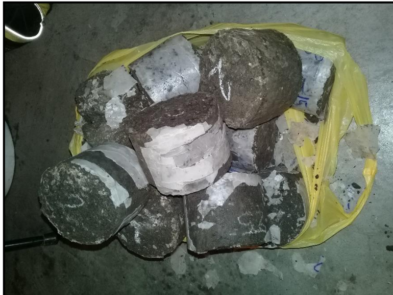
Fotografía N° 57: Briquetas ensayadas por prensa Marshall
