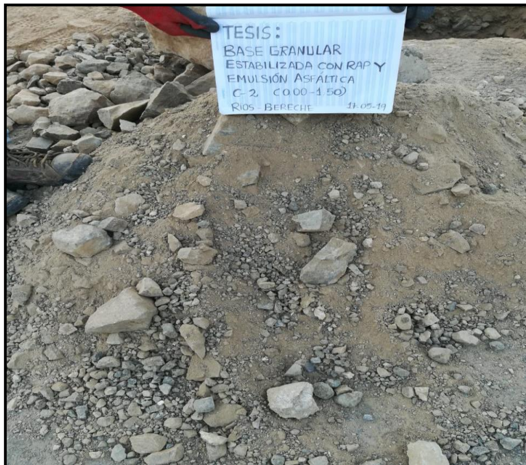
Fotografía N° 18: Extracción del tercer estrato (C2)
