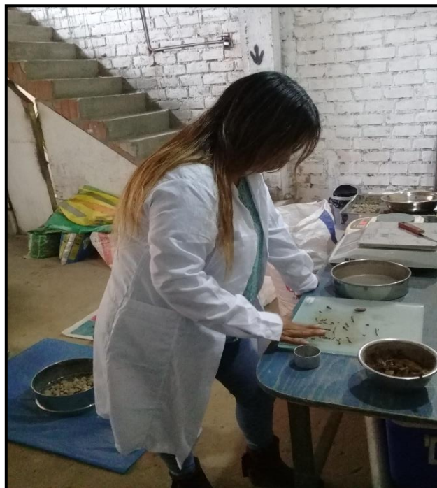
Fotografía N° 37: Límite plástico a la base granular
