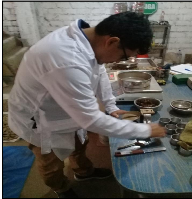
Fotografía N° 36: límite líquido a la base granular
