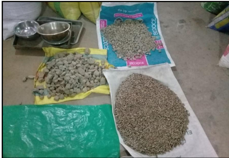
Fotografía N° 34: base granular tamizado en gruesos y finos
