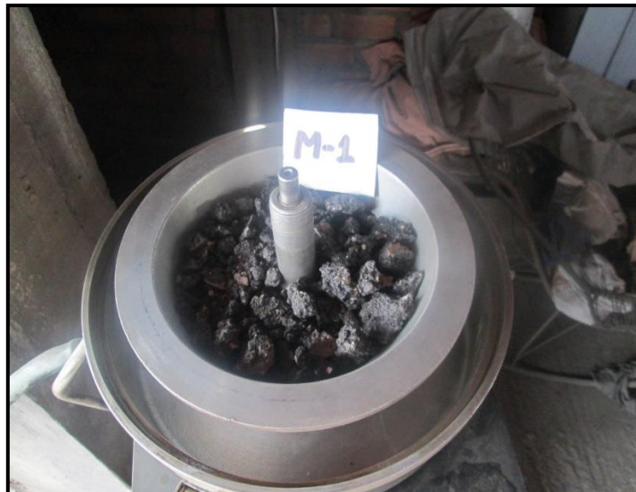
Fotografía N° 43: Colocación del Rap en la centrifuga asfáltica
