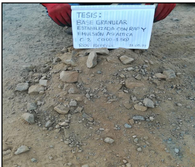
Fotografía N° 19: Extracción del cuarto estrato (C2)
