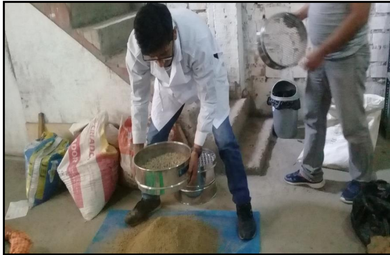
Fotografía N° 32: Tamizado de base granular
