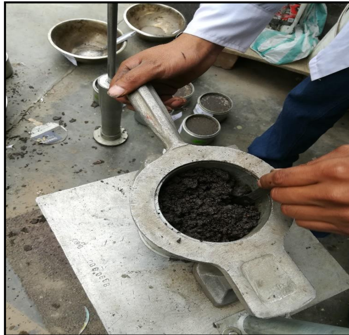
Fotografía N° 52: Elaboración de briquetas por el método Marshall
