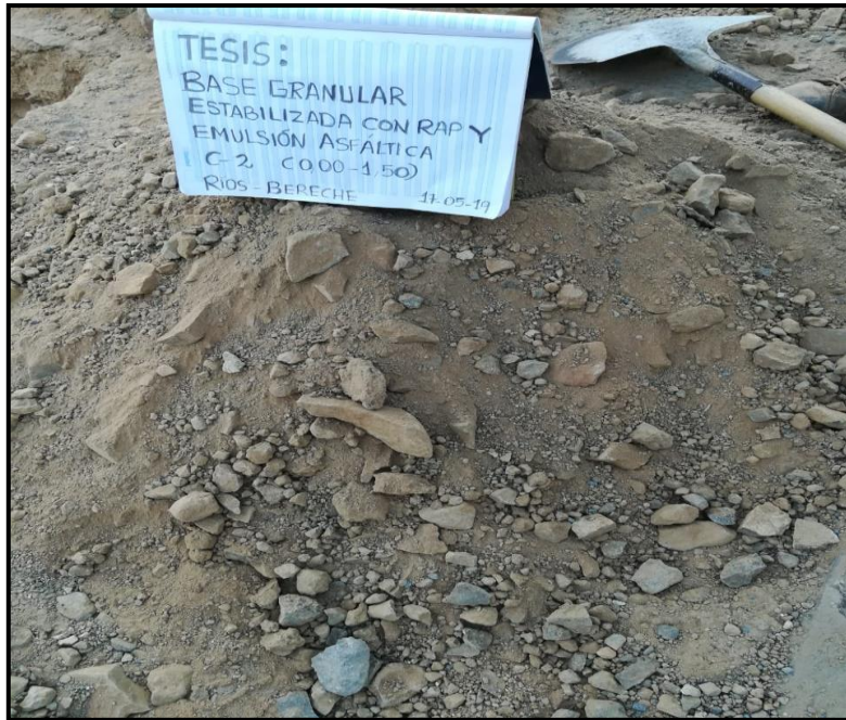
Fotografía N° 16: Extracción del primer estrato (C2)
