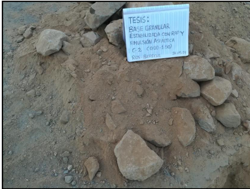
Fotografía N° 20: Extracción del quinto estrato (C2)
