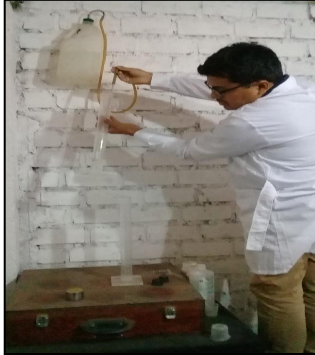
Fotografía N° 40: Ensayo equivalente de arena
