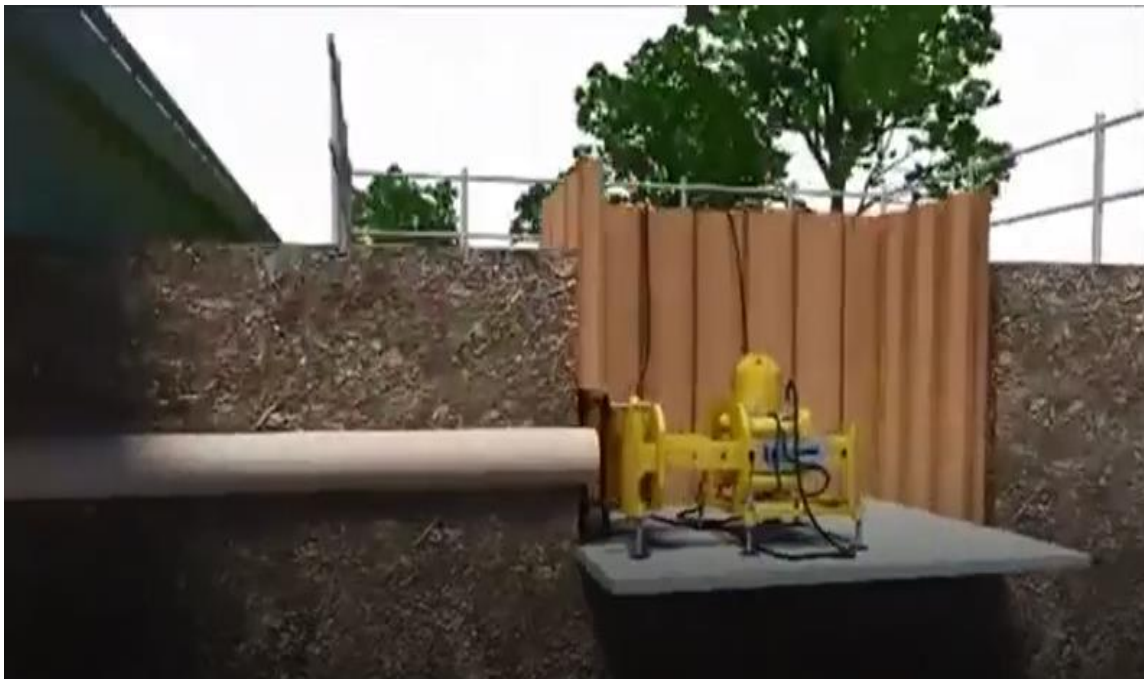
Figura N°09 Corte transversal de una excavación sin zanja
