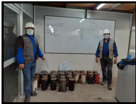
Probetas de concreto vaciadas en estado fresco
