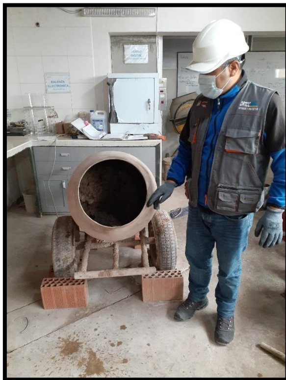
Trompo para el vaciado de concreto
