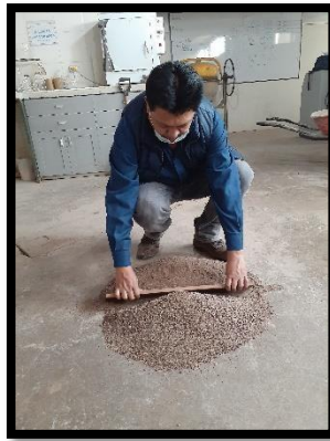
Cuarteado de agregado grueso y fino
