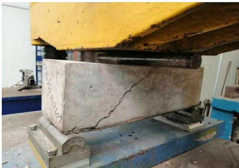
Figura 47: Viga reforzada sometida a ensayo de flexión
