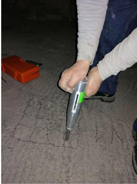
figura 21: Ensayo de esclerómetro digital
