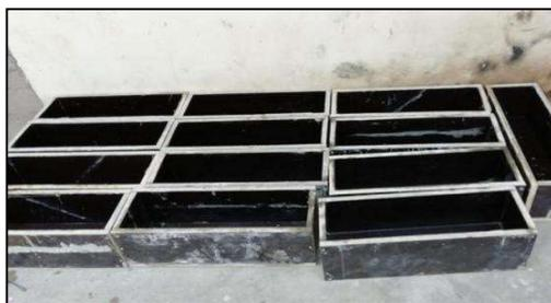
Figura 41: Moldes para elaboración de las muestras.
