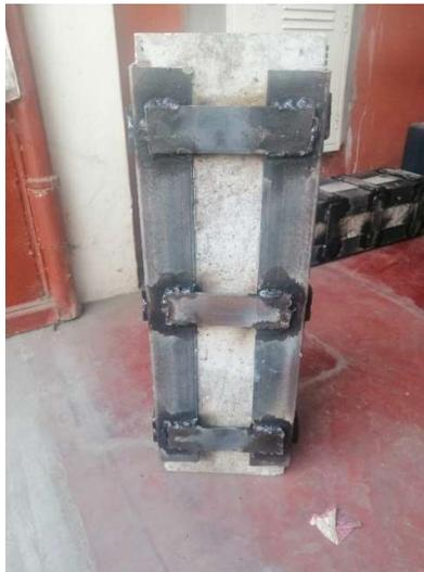
Figura 43: Reforzamiento de empresillado metálico
