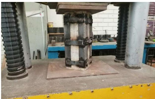
Figura 45: Espécimen reforzado con empresillado sometido a compresión
