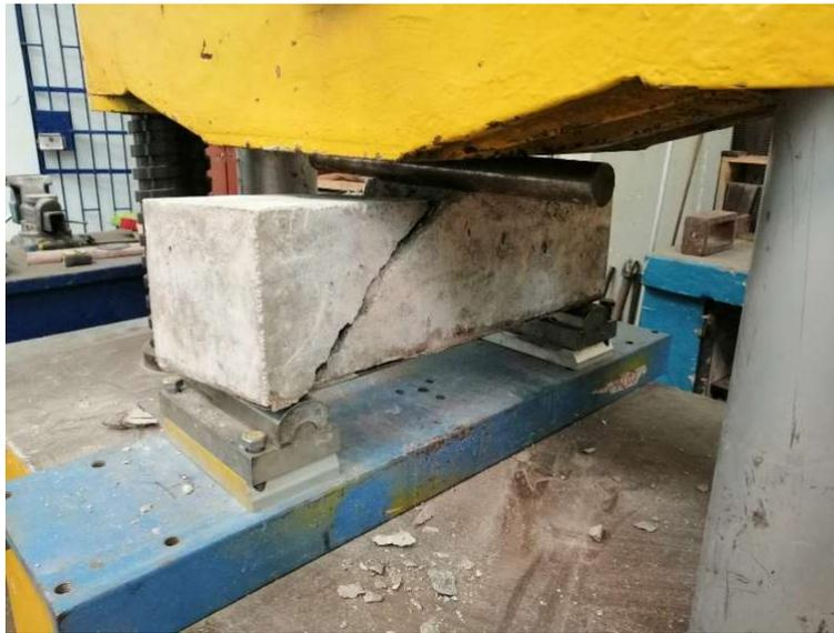
Figura 48: Fractura de concreto de viga reforzado por plancha metálica
