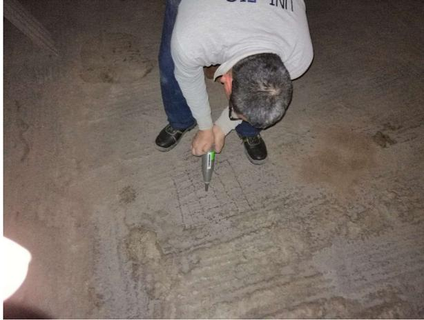
figura 22: Ensayo de esclerometria digital
