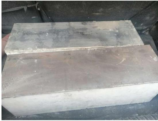
Figura 44: Reforzamiento con plancha metálica
