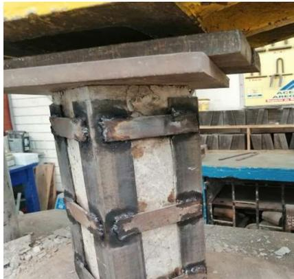
Figura 46: Desprendimiento de concreto en espécimen empresillado sometido a ensayo de compresión
