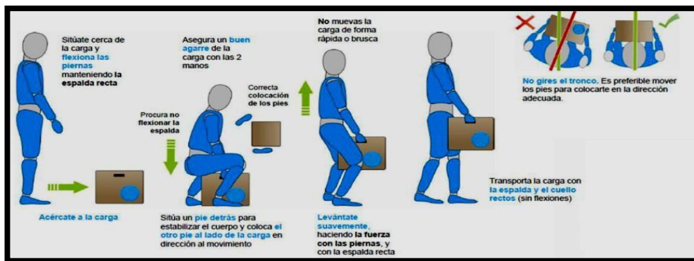
Figura 53: Demostración de una postura adecuada al cargado de las cajas de una organización.
