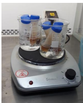
Figura 5. Muestras en parrilla eléctrica a una temperatura de 90° - 95° C
