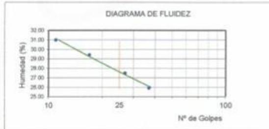
DETERMINACION DEL LIMITE PLASTICO ASTM D 4318 NTP 339.129
